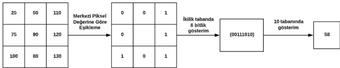
Şekil 3.2. Görüntüden alınan bir kesit üzerinde LBP yönteminin uygulanması [13]
