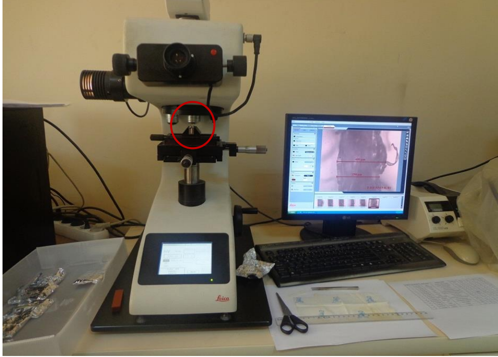
Şekil 3.1 Islak Mendillerin kalınlığını ölçmek için kullanılan mikroskop – Leica VMHT MOT (Leica Systems, Wetzlar, Almanya).
