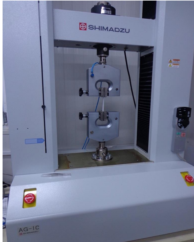
Şekil 3.2. Islak mendil numunelerinin kopma gerilmelerini 0.1 Newton hassasiyeti ile ölçen Shimadzu AG-IC otoğraf cihazı.
