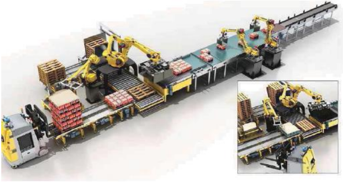
Şekil 2.2. Çatallı OYA'nın paletizer işlemi sonunda paleti alması
