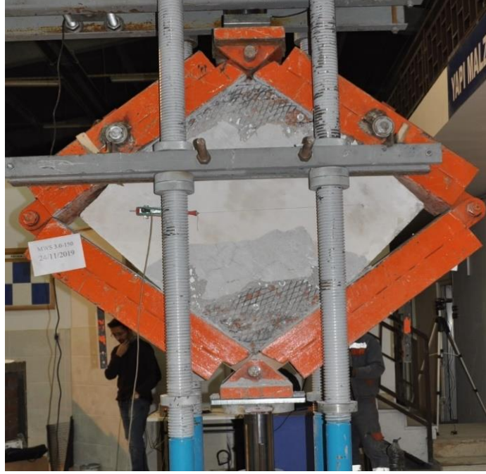
Şekil 4.12. MBW3,0-150 elemanın deney sırası hasar durumu
