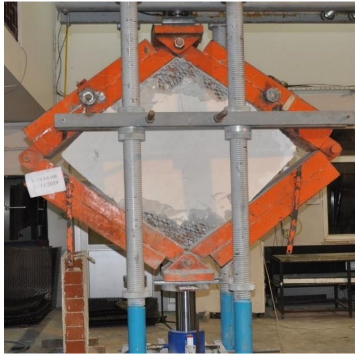
Şekil 4.9. MBW 3,0-100 elemanının deney sonu hasar durumu
