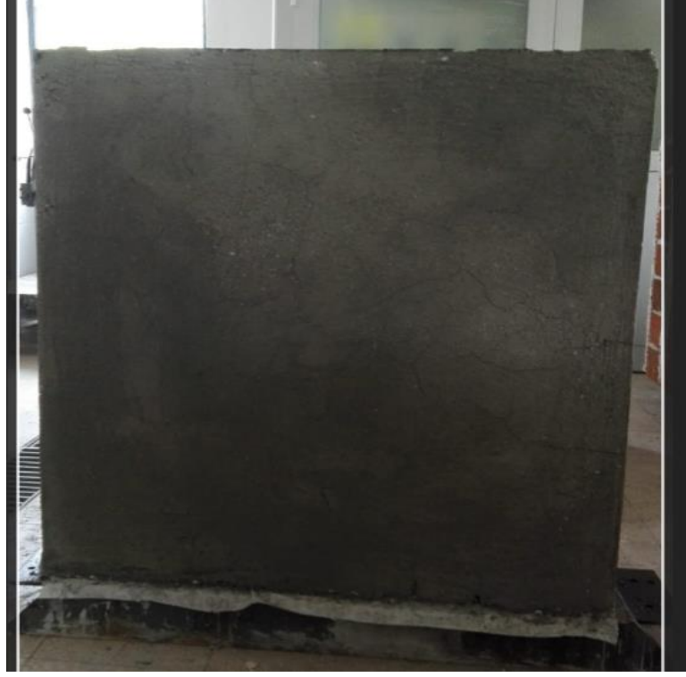
Şekil 3.23. Deney elemanlarının sıvanması
