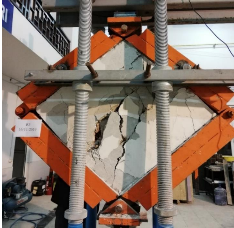
Şekil 4.2. R (Referans deney elemanın) deney sonrası durumu
