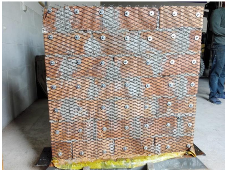
Şekil 3.22. Deneç elemanlarının yapım aşamasında ankaraj yapılması
