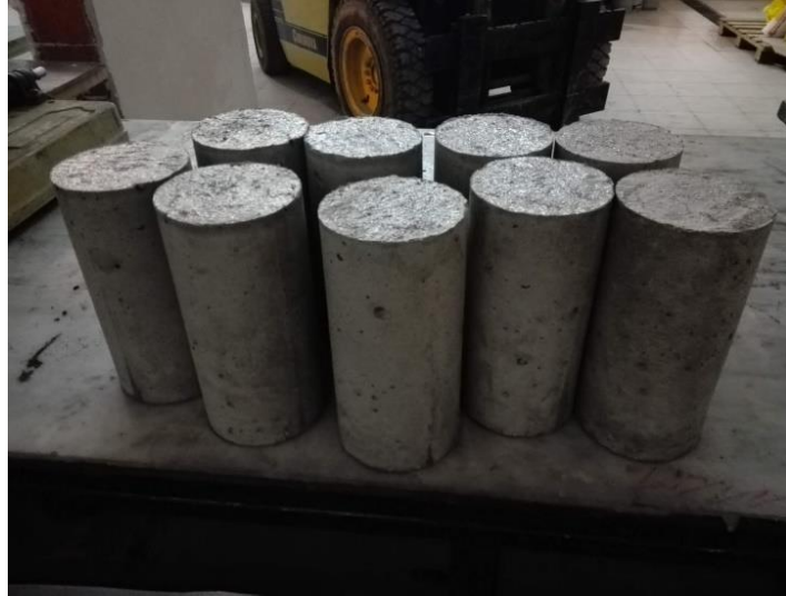
Şekil 3.10. Harç numunelerin kalıptan çıkarılmış durumu
