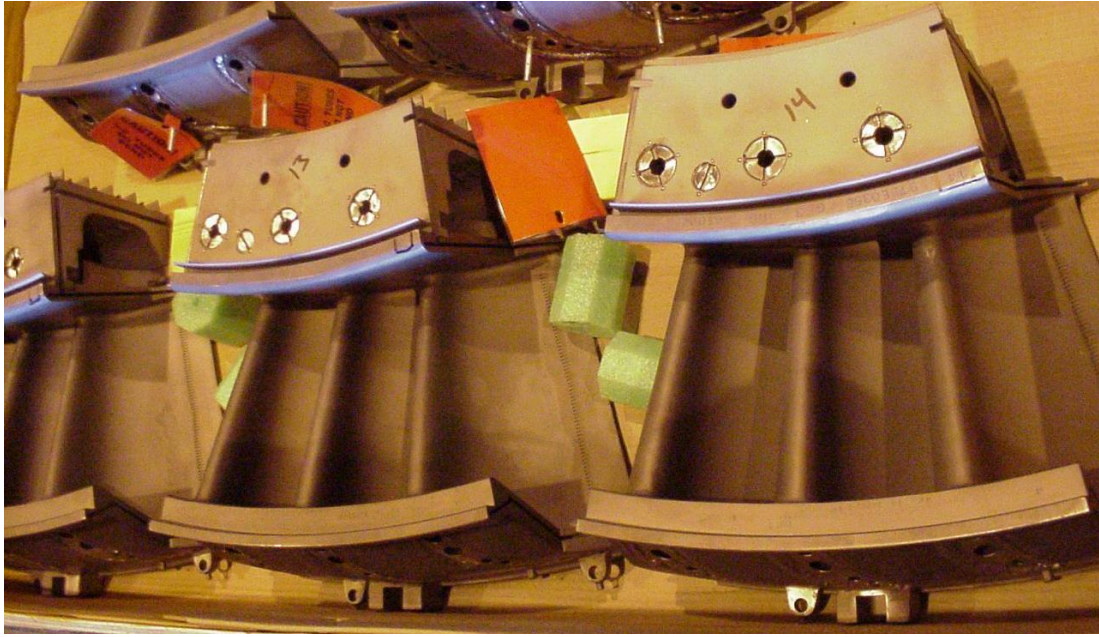
Şekil 2.26. GE 9FA Türbini İkinci Kademe Nozul Segmentleri
