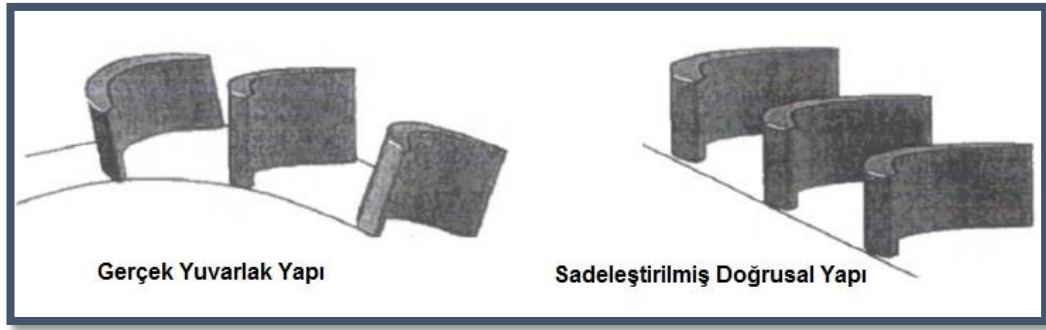
Şekil 3.4. Gerçek yuvarlak yapı ve sadeleştirilmiş doğrusal yapı [49]
