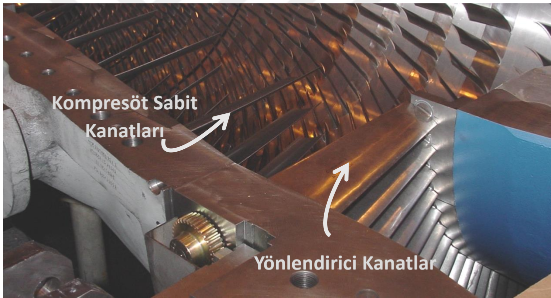
Şekil 2.9. Yönlendirici kanatlar ve kompresör sabit kanatları
