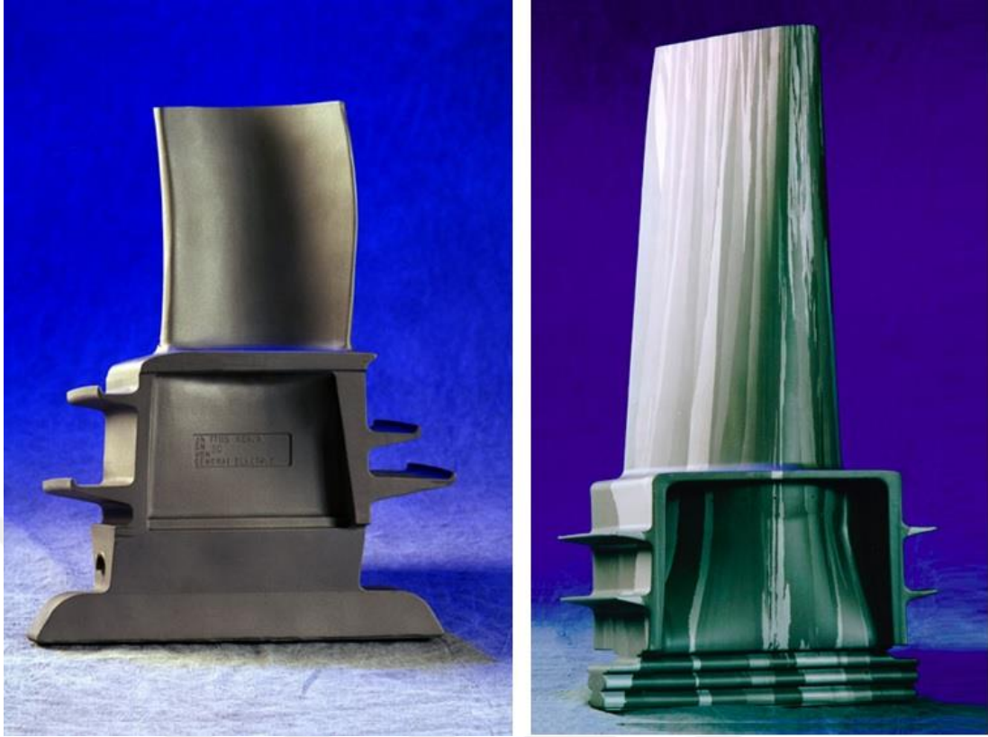
Şekil 2.22. Yönleştirilmiş katılaşma yolu ve tek çekirdek kristal yöntemi
