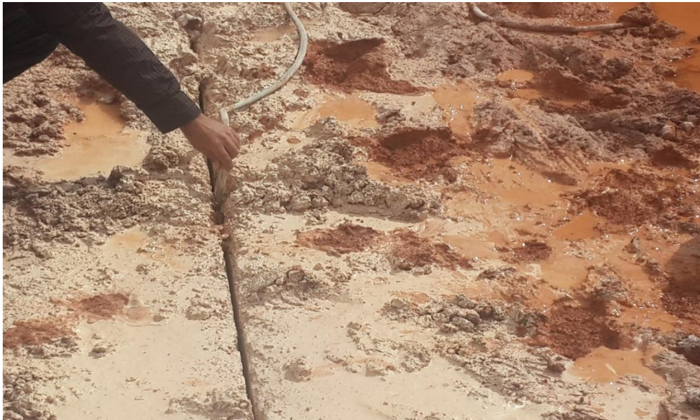
Şekil 4.9. Mermer ocaklarında kesme telinin soğutulması amacıyla su kullanımı
