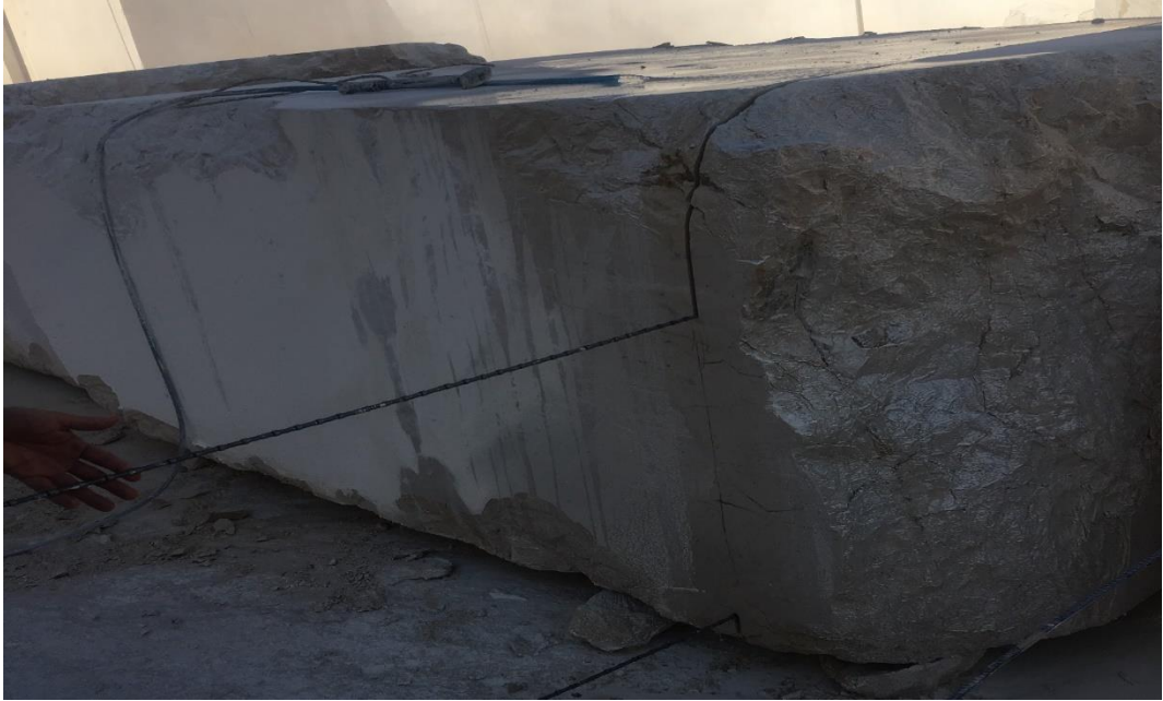
Şekil 3.3. Kesme telinin ısınmasının önlenmesi amacı ile su kullanımı
