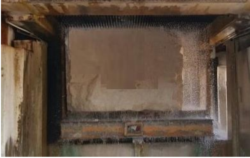
Şekil 4.10. Mermer işleme tesisinde kesme bıçaklarının soğutulması amacıyla su kullanımı
