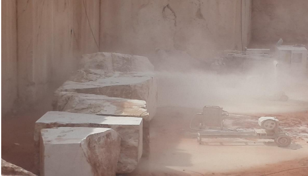
Şekil 2.5. Mermer bloklarının kesimi ve kullanılan ekipmanlar
