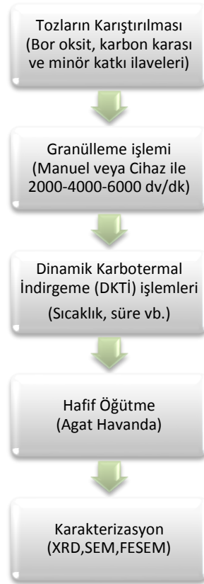
Şekil 5.9. DKTİ prosesinde B 4 C toz üretim işlemlerinin iş akış şeması
