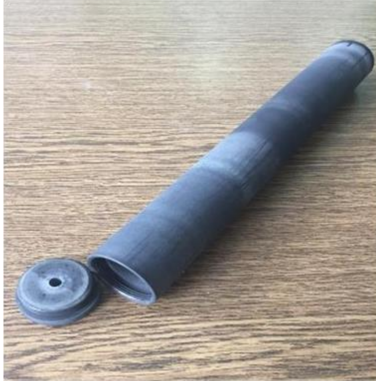
Şekil 5.7. Kullanılan refakter esaslı (grafit) reaktör
