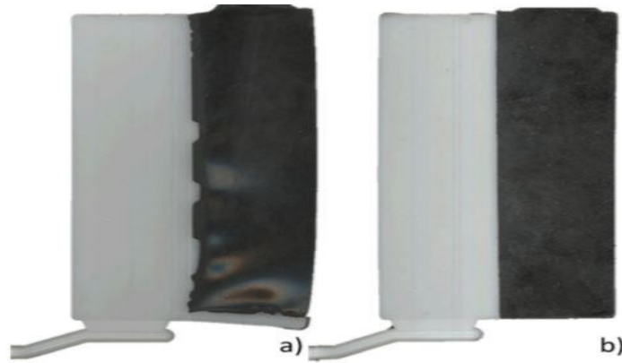
Şekil 3.20. Enjeksiyon deneme sonuçları a) Kauçuğun ilk olarak enjekte edildiği, ikinci olarak termoplastik enjeksiyonu ile oluşan ürün b) Termoplastiğin ilk olarak enjekte edildiği, ikinci olarak kauçuk enjeksiyonu ile oluşan ürün [10]
