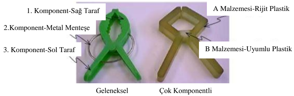
Şekil 3.4. Geleneksel tek komponent ve çift komponent kalıplama ile üretilmiş iki klips örneği [5]
