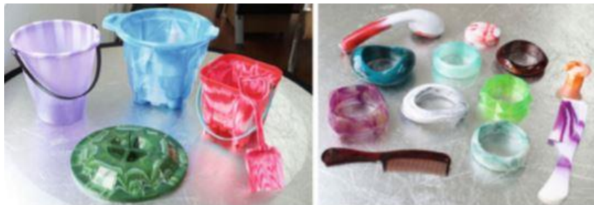
Şekil 3.12. Zaman aralıklı enjeksiyon ile üretilmiş ürünler [8]
