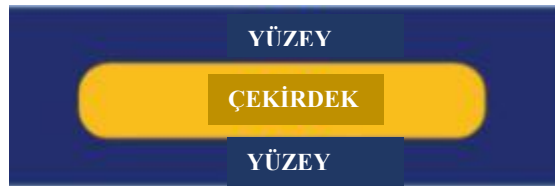
Şekil 3.6. Ko-enjeksiyon ile üretilen bir ürünün temsili sandviç yapısı kesiti [8]
