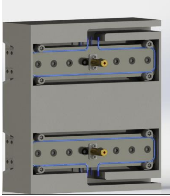
Şekil 4.20. Sıcak yolluk sistemi montajı
