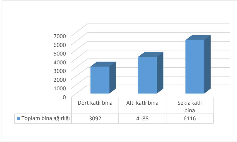
Şekil 3.62. Tip1C için binalarda bina ağırlığı
