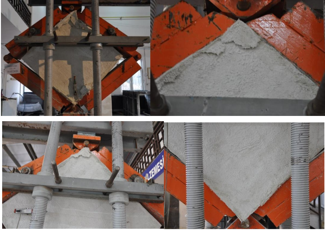
řekil 6.12. MBWGFR 2.0mm-150mm elemanının deney sonrası hasar durumu
