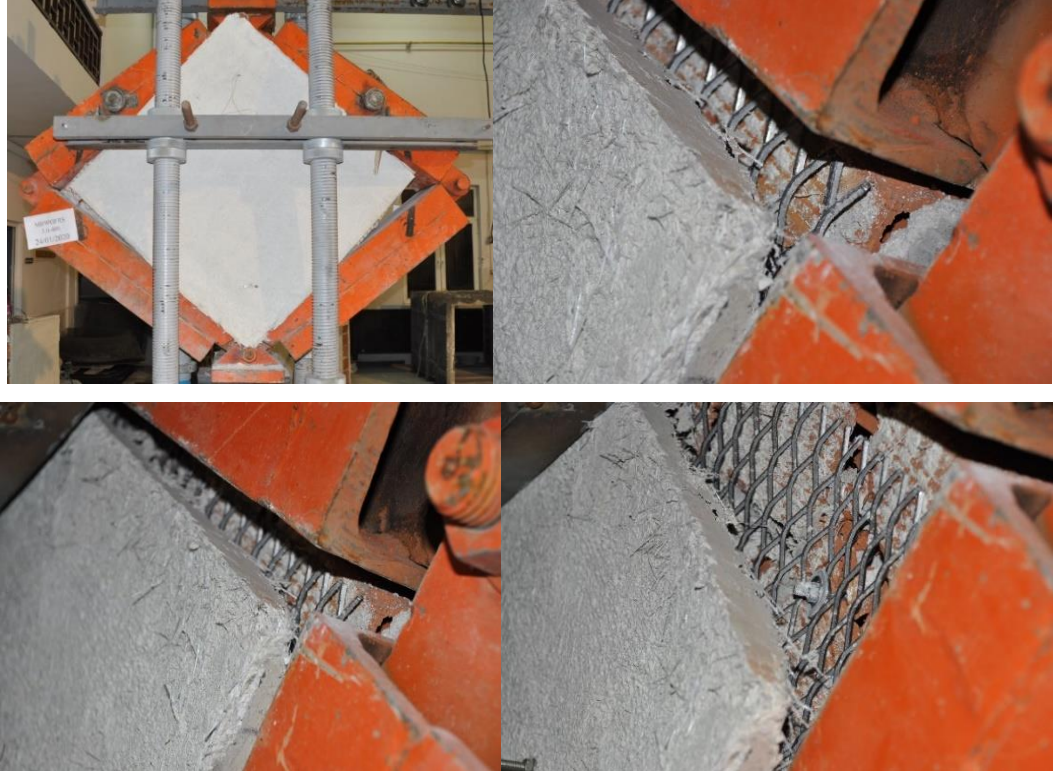
Şekil 6.21. MBWGFR 3.0mm-400mm elemanının deney sonrası hasar durumu
