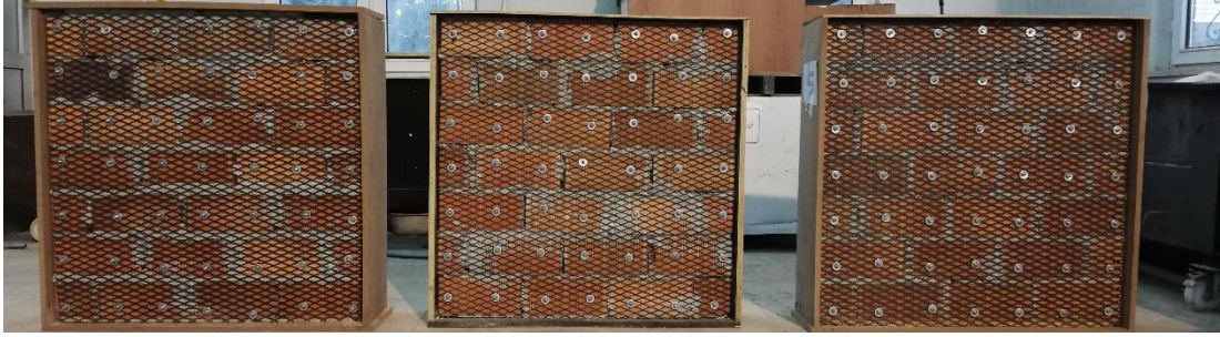
Şekil 4.17. Genişletilmiş çelik levha ile güçlendirilmiş deney elemanları.
