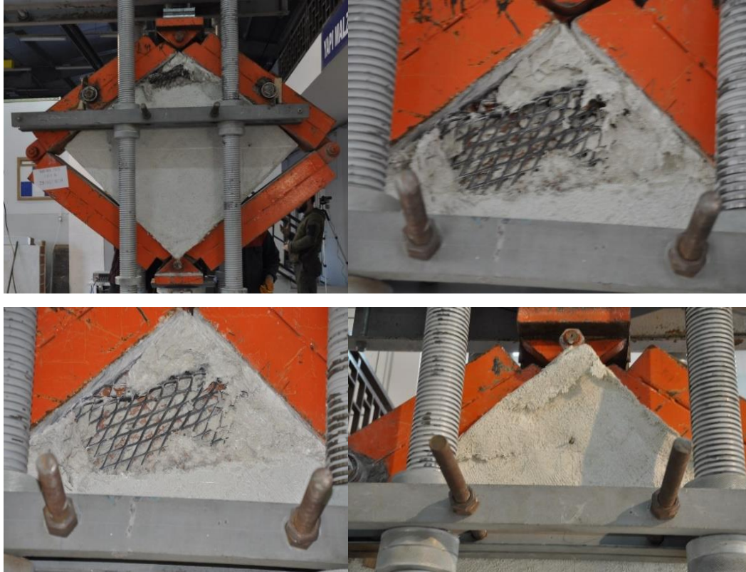
Şekil 6.18. MBWGFR 3.0mm-150mm elemanının deney sonrası hasar durumu
