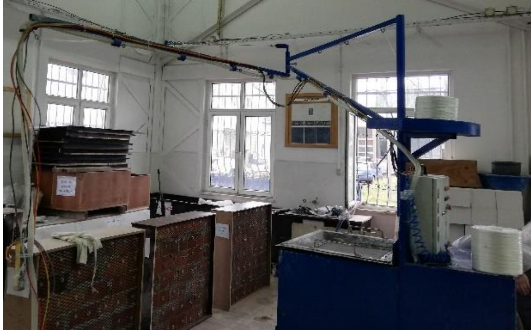
Şekil 5.2. Püskürtme beton uygulama düzeneği
