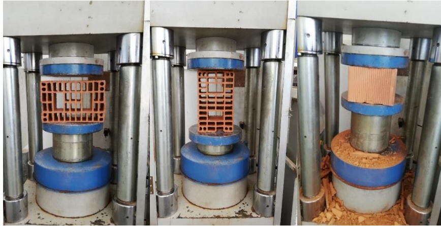
Şekil 4.7. Yığma blok tuğla basınç deneyleri
