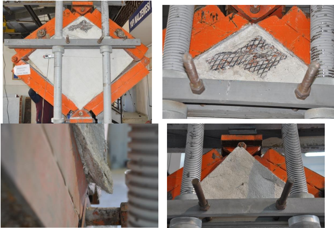
Şekil 6.15. MBWGFR 2.0mm-200mm elemanın deneyden sonra hasar durumu
