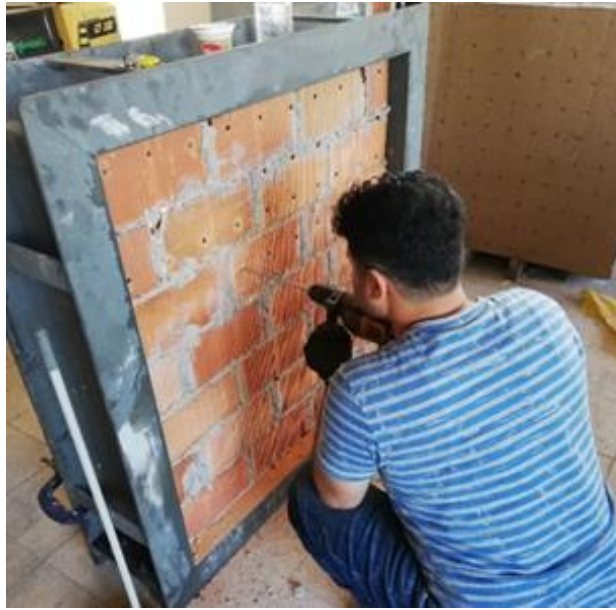
Şekil 4.6. Ankraj Deliklerinin Açılması
