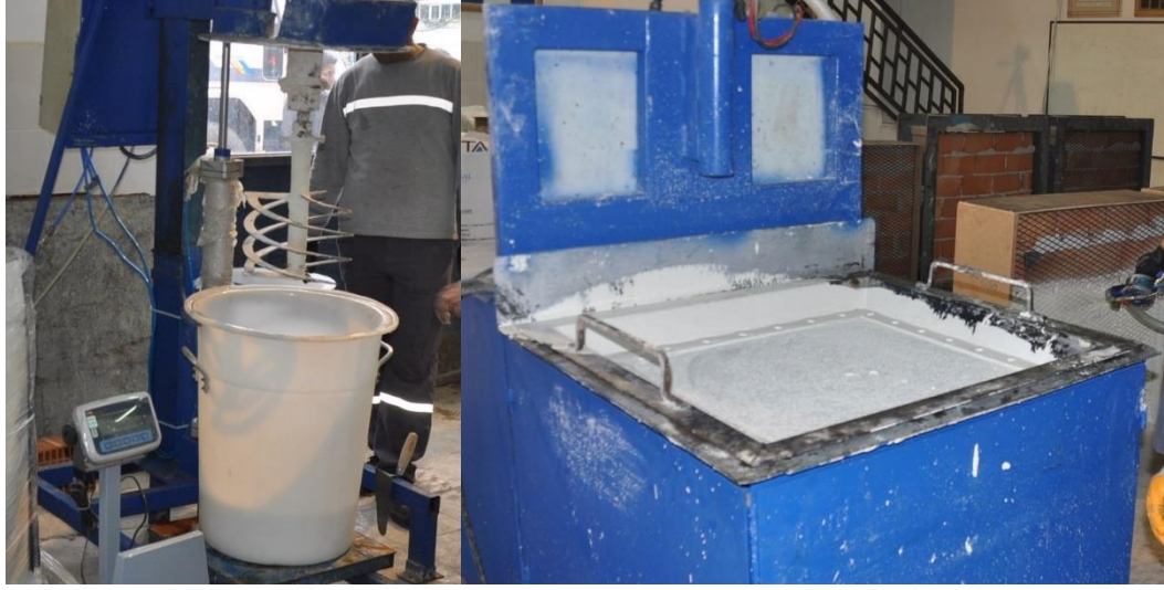
Şekil 5.1. Püskürtme beton karışımının hazırlanması
