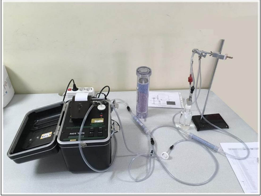
Şekil 3.4. RAD7 katıhal dedektörünün kullanımı ve numunelerin köpürtülmesine ait anlık görüntü
