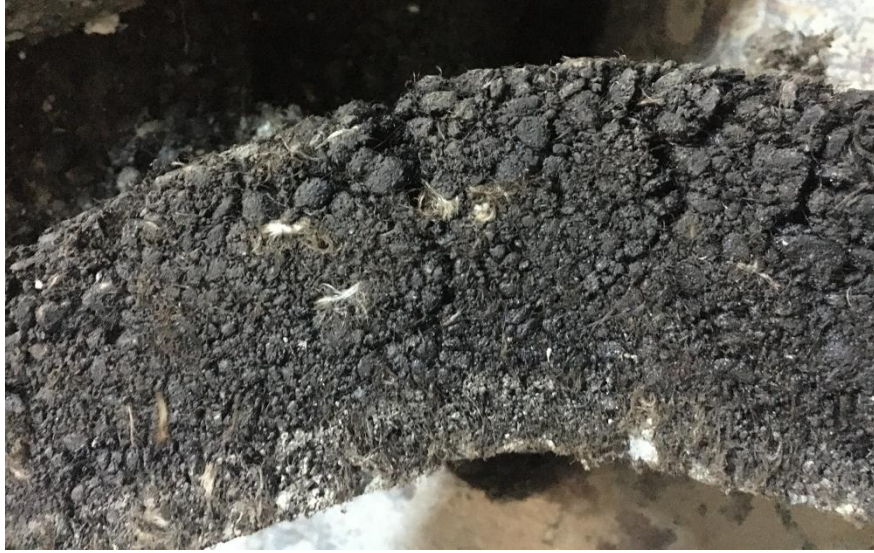
Şekil 3.32. Kiriş eğilme deneyinde sehim yapmış numune
