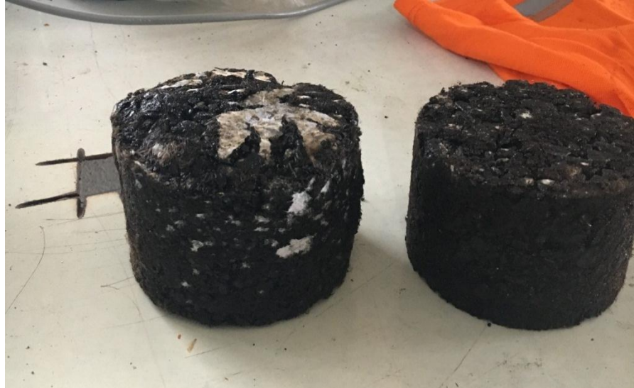
Şekil 3.15. Marshall numunesinin kırılmadan sonraki görüntüsü
