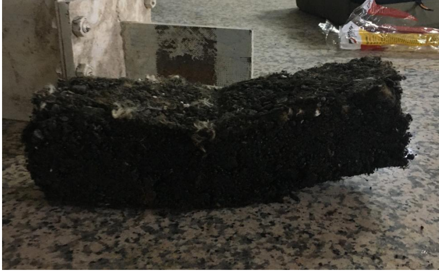
Şekil 3.29. Sehim yapmış numune düz zemine bırakılmış hali
