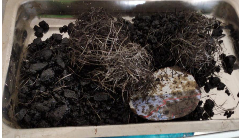
Şekil 3.4. 54mm PP lif katkılı Marshall deney çalışması
