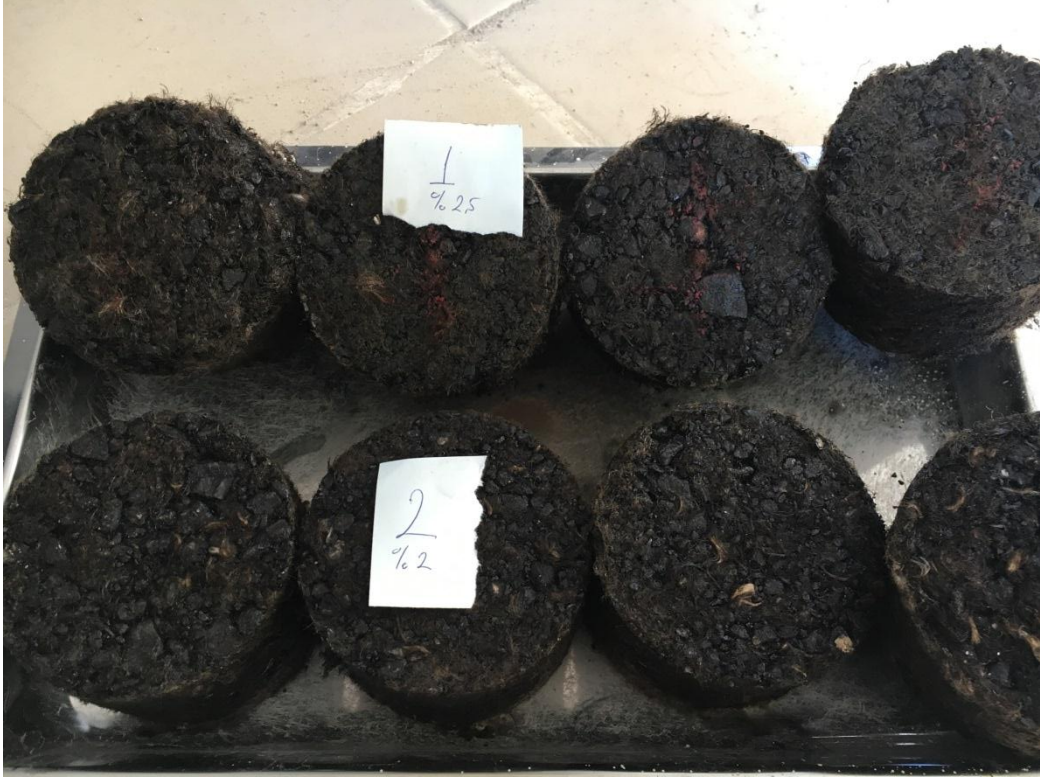
Şekil 3.10. Kalıptan çıkarılmış katkıli Marshall numuneleri 2
