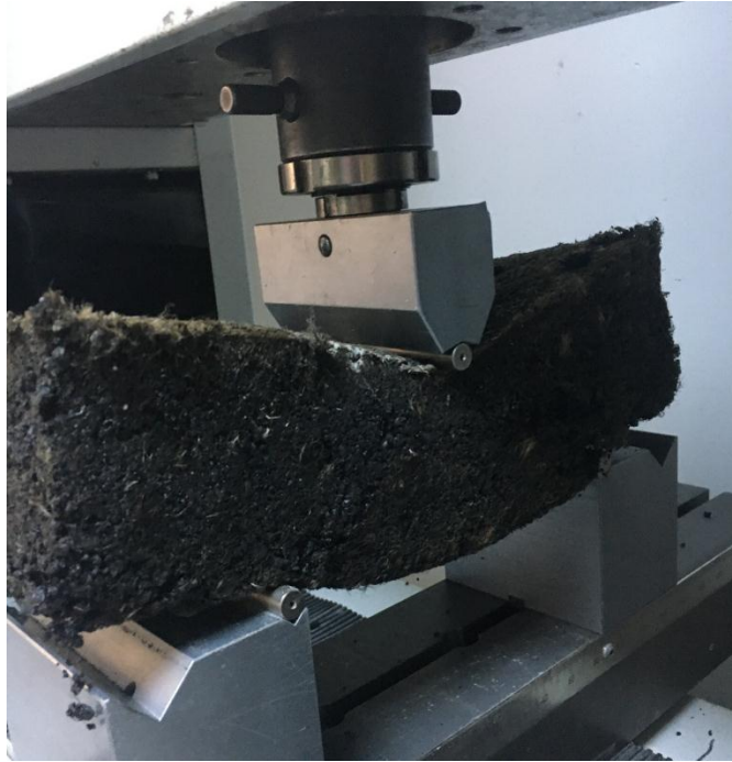
Şekil 3.26. Kiriş eğilme deney aşamaları 2
