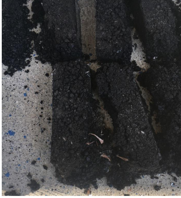
Şekil 3.21. Bazı numunelerin kalıptan çıkarıldıktan sonraki görseli 1
