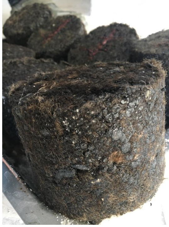
Şekil 3.8. Marshall deney çalışmasında numunenin yakından görünüşü
