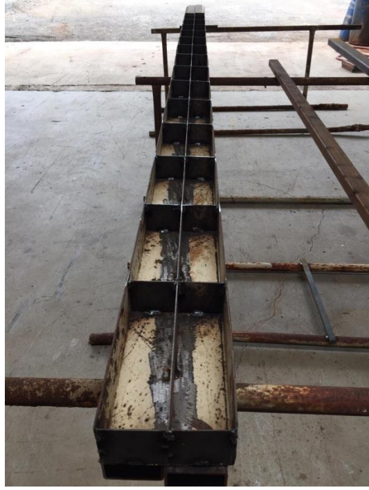
řekil 3.17. Kiriř eđilme deneyi numuneleri iin kalıp hazırlanması
