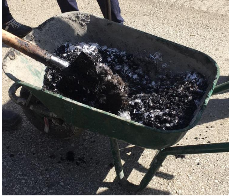
Şekil 3.20. Kiriş eğilme deney numuneleri için BSK'ya PP lif karıştırma işlemi 2
