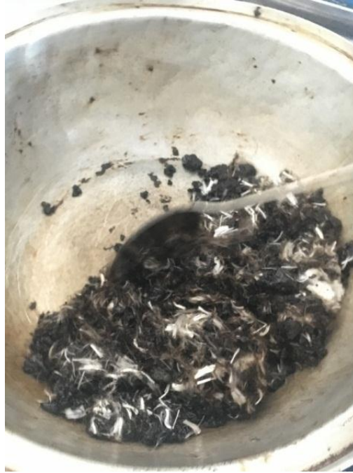
Şekil 3.5. Marshall deney çalışmasında BSK'a PP lif karıştırılması
