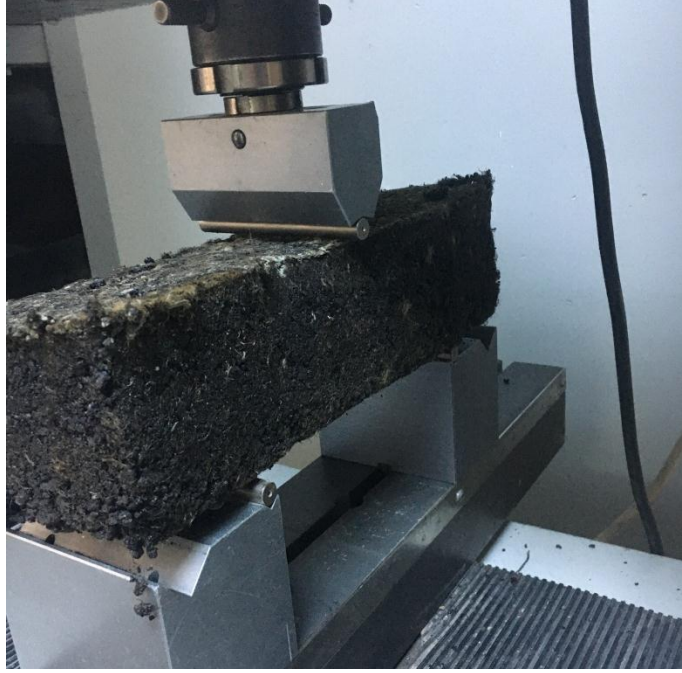
Şekil 3.25. Kiriş eğilme deney aşamaları 1
