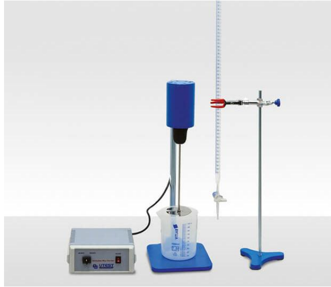
Şekil 3.1. Metilen Mavisi deney seti
