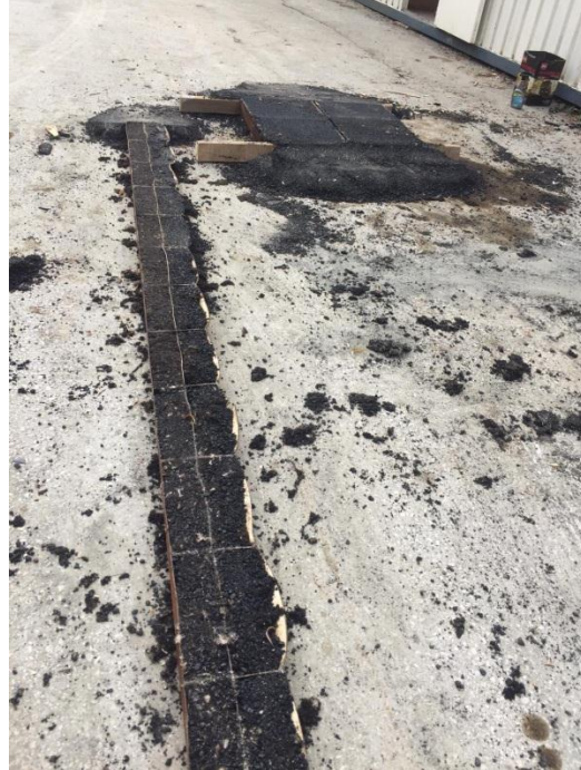
řekil 3.18. Kiriř eđilme deney numunelerinin kalıp iinde sıkıřtırma iřlemi
