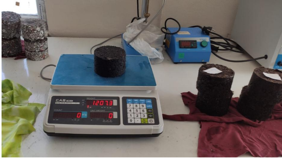
Şekil 3.11. Marshall numunelerinin havadaki ağırlığının tartılması
