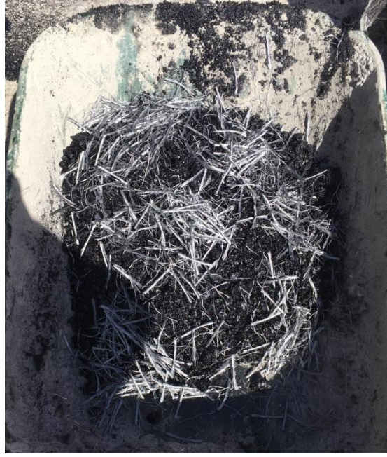
Şekil 3.19. Kiriş eğilme deney numuneleri için BSK'ya PP lif karıştırma işlemi 1
