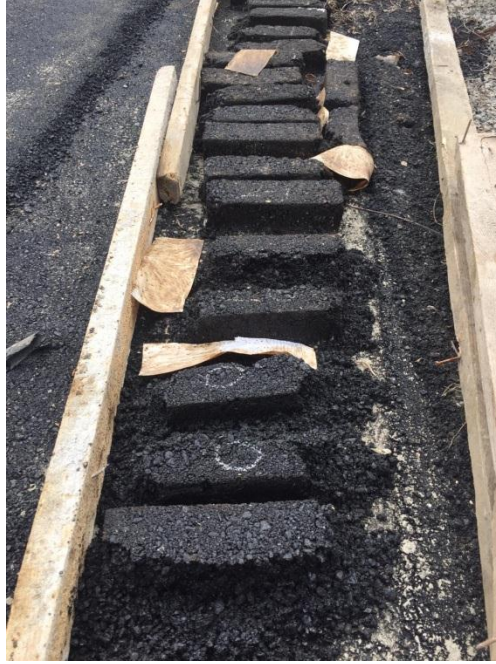
Şekil 3.22. Bazı numunelerin kalıptan çıkarıldıktan sonraki görseli 2
