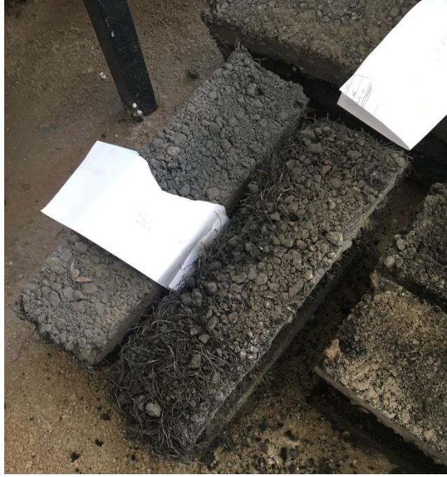
Şekil 3.23. Kiriş eğilme deney numuneleri
