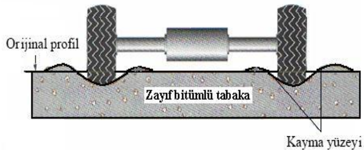
Şekil 2.8. Zayıf bitümlü tabakada tekerlek izi oluşumu [1]
