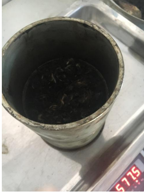
Şekil 3.6. Marshall deney çalışmasında karışımın kalıplara konulması
