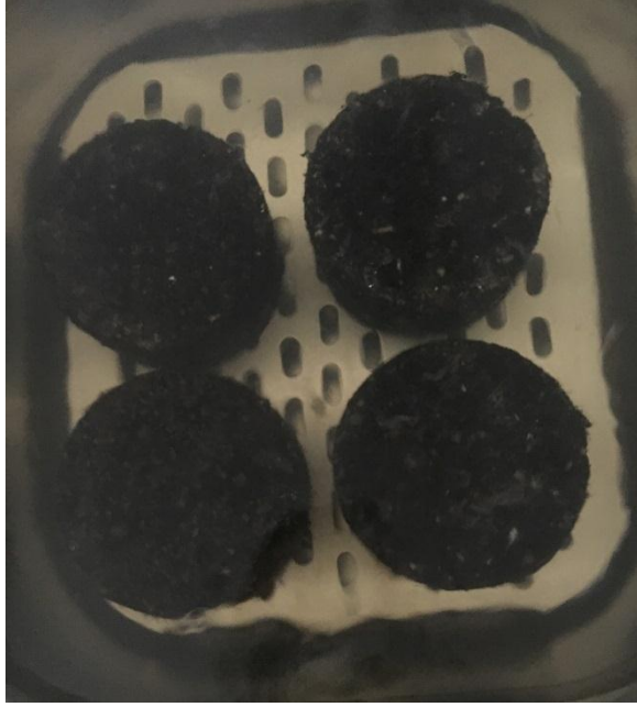
Şekil 3.13. Marshall numunelerinin sıcak su banyosunda bekletilmesi
