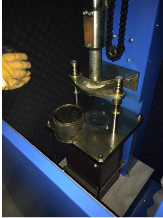
Şekil 3.7. Marshall numunelerinin sıkıştırma işlemi
