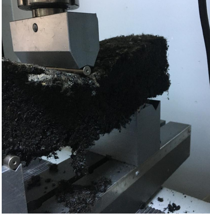
Şekil 3.31. Kiriş eğilme deney çalışması sırasında dağılan numune
