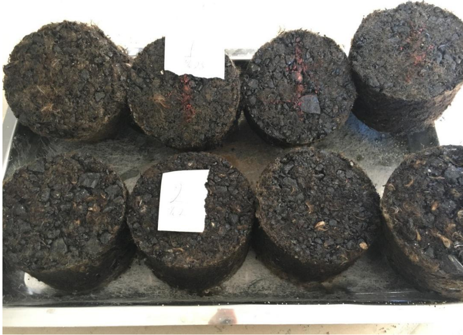
Şekil 3.9. Kalıptan çıkarılmış katkılı Marshall numuneleri 1
