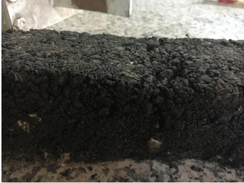
Şekil 3.28. Kiriş eğilme deney sonrası numunenin görseli
