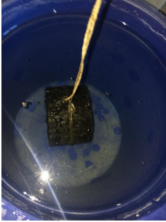
Şekil 3.12. Marshall numunelerinin sudaki ağırlığının tartılması
