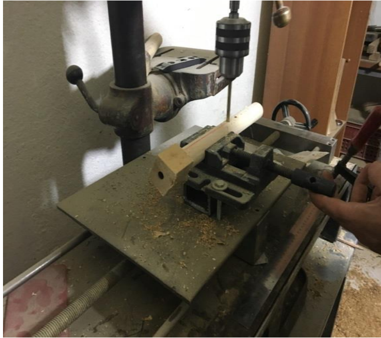
Resim 38: Tezgh matkabı ile perdelerin delinmesi
