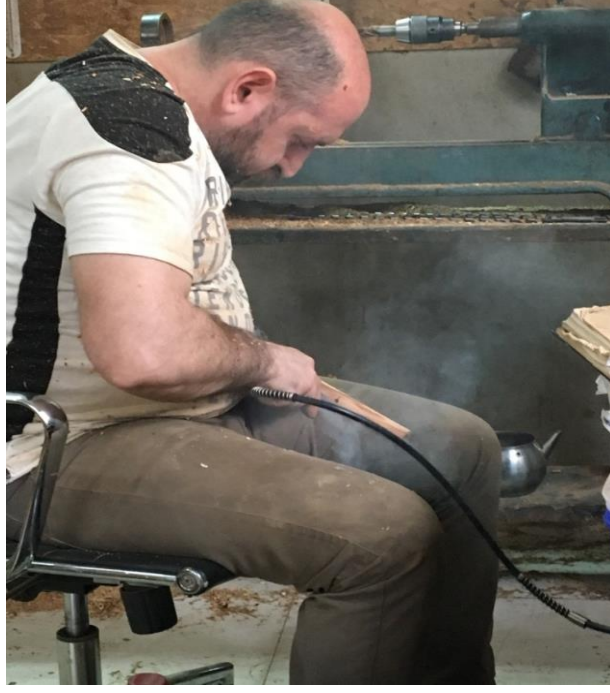
Resim 19: Mey çalgı gövdesinin perdelerinin akortlanması
