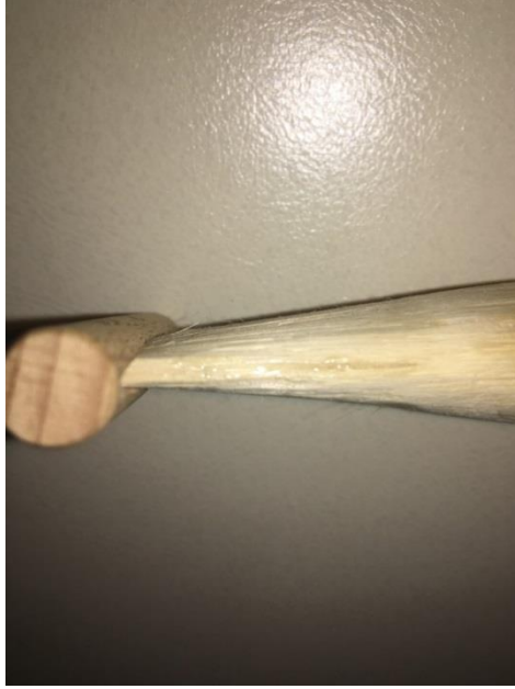
Resim 54: Kamışın yanlarının “Pattex Gel” yapıştırıcı ile yapıştırılması
