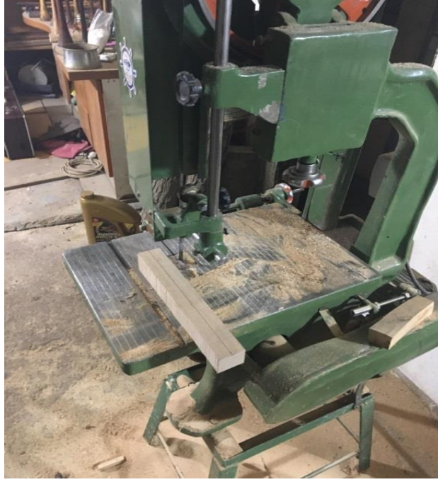
Resim 35: Ađaların 4'e 4 apında Őeritli testere ile kesilmesi
