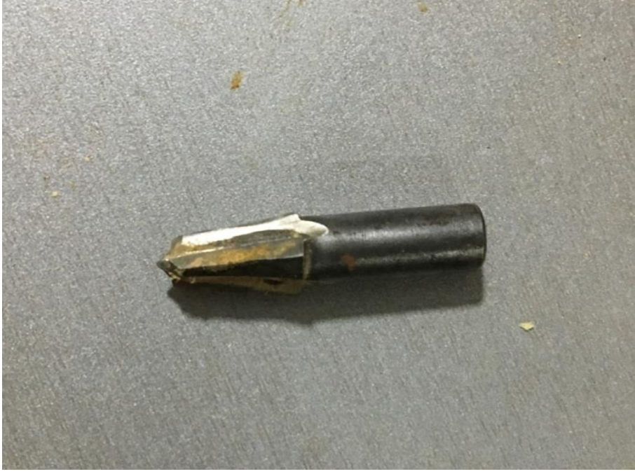
Resim 15: Mey algısında ağız akısı iin kullanılan konik bıak
