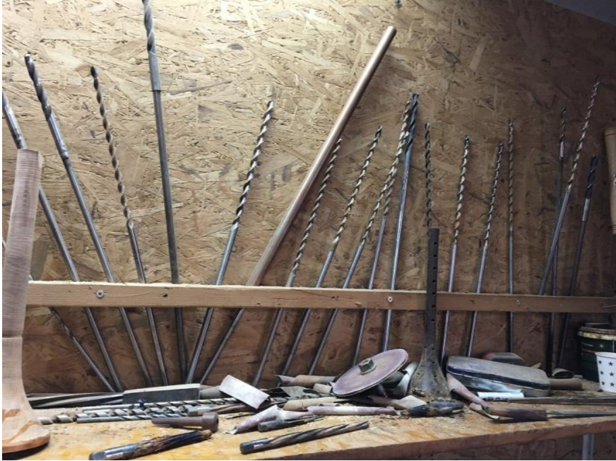
Resim 22: Mey çalgı gövdesinin yapımında kullanılan bıçaklar
