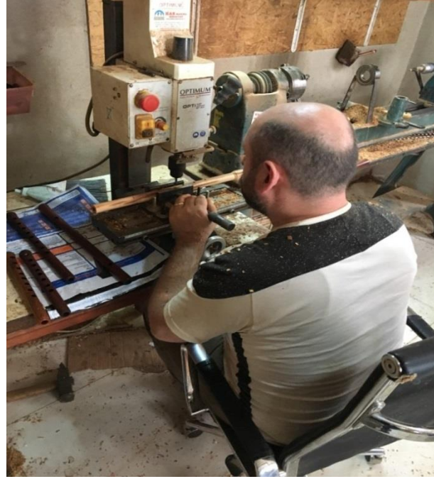
Resim 15: Mey algı gvdesinin perdelerinin delinmesi
