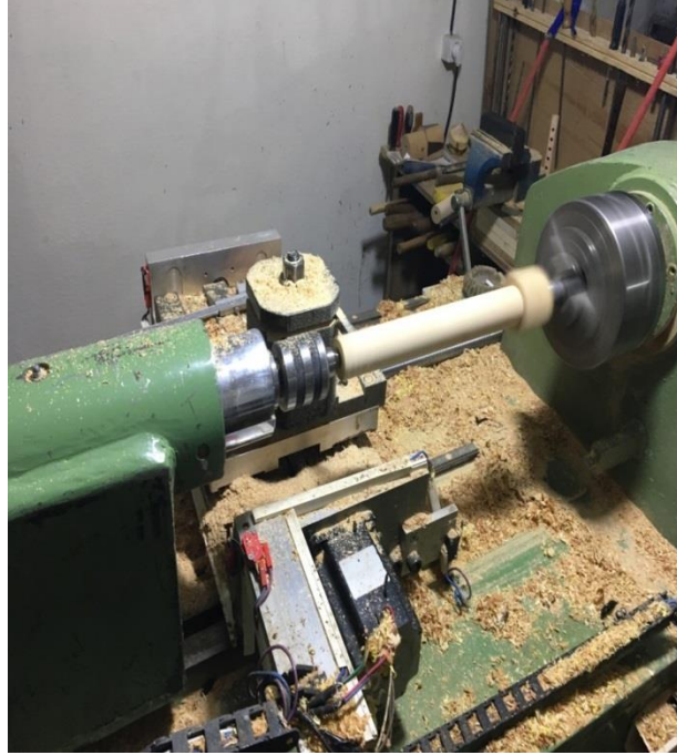
Resim 4: Mey algı gvdesinin kabasının alınması
