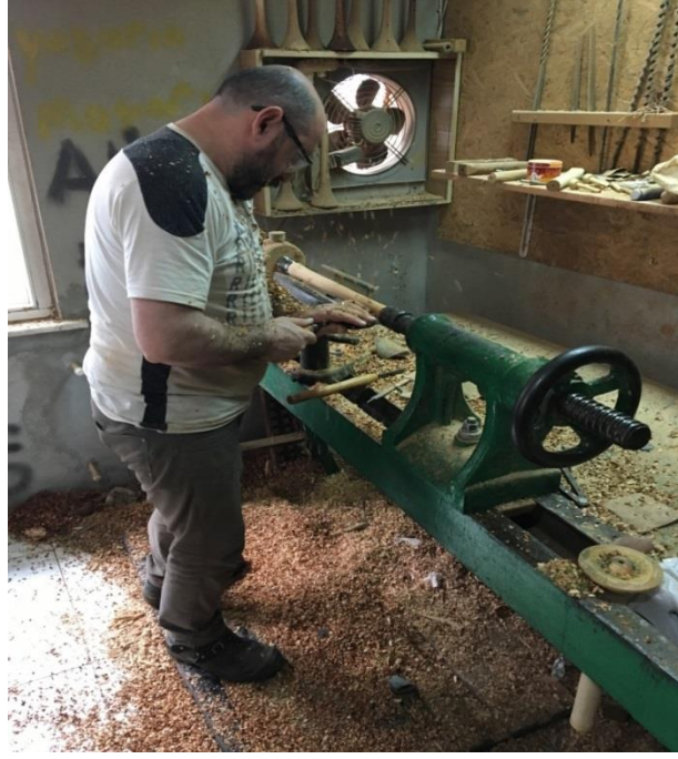
Resim 14: Mey algı gvdesinin kabasının alınması
