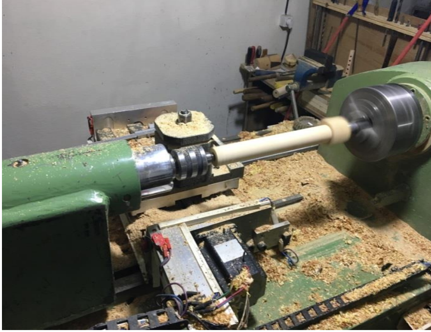
Resim 8: Mey çalgı gövdesinin kabasının alınması
