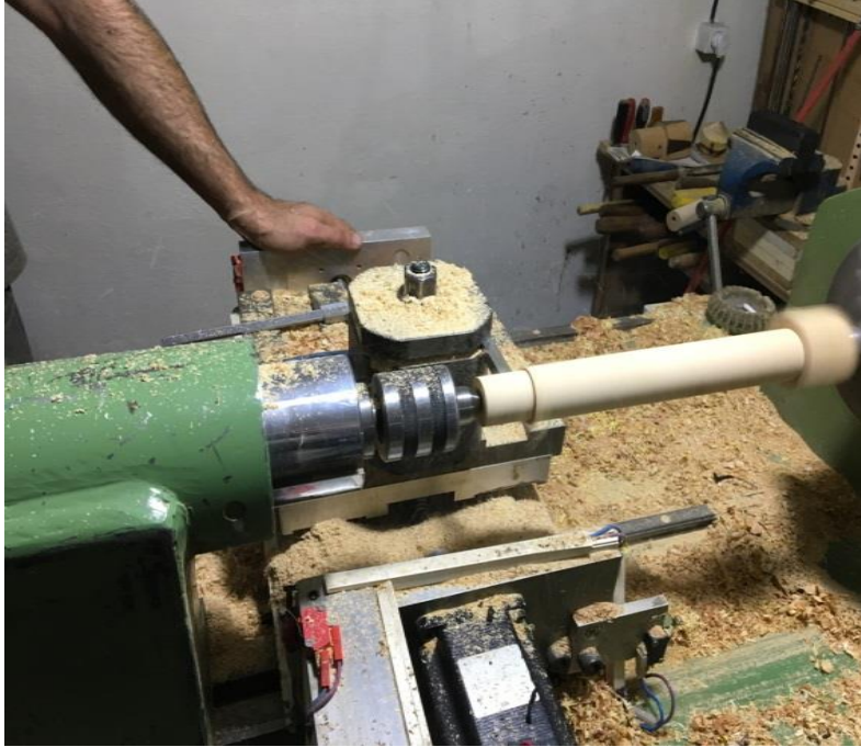
Resim 36: Mey gvdesinin kabasının alınması
