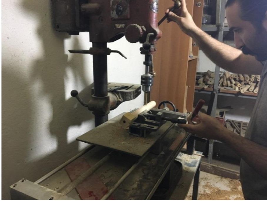
Resim 10: Mey algı gvdesinin perdelerinin delinmesi
