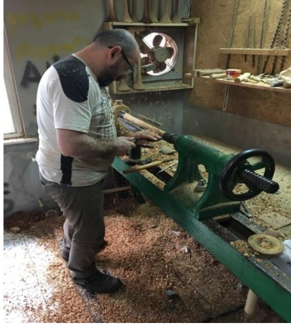
Resim 17: Mey çalgı gövdesinin kabasının alınması
