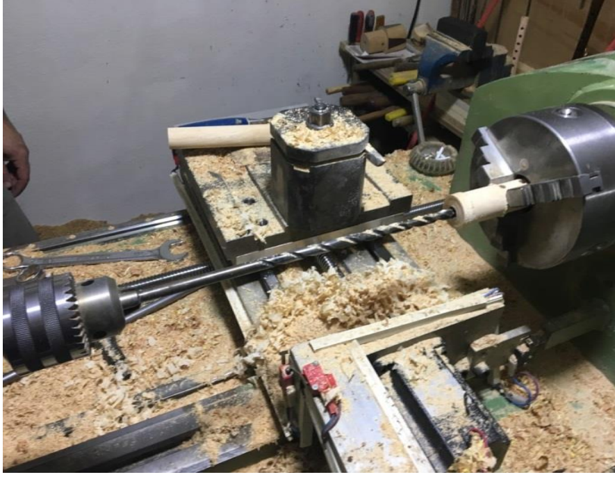
Resim 9: Mey algı gvdesinin i kısmının delinmesi
