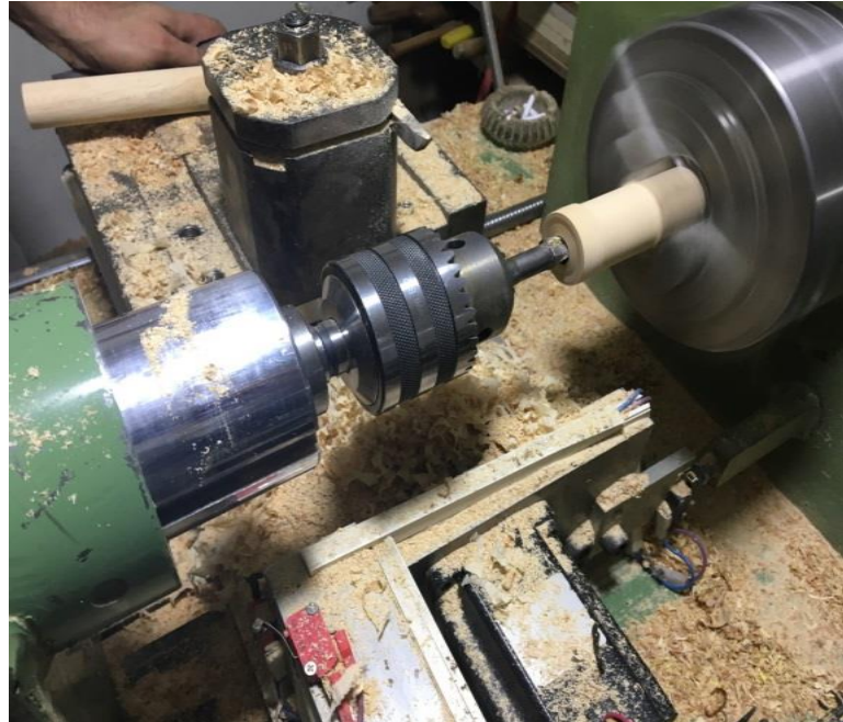
Resim 40: Mey gövdesinin ağız kısmının konik bıçak ile açılması
