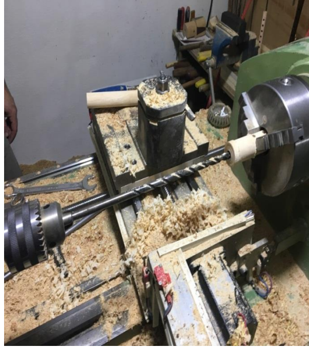
Resim 5: Mey algı gvdesinin i kısmının delinmesi
