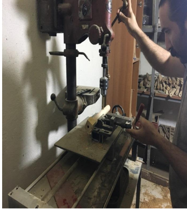
Resim 6: Mey algı gvdesinin perdelerinin delinmesi
