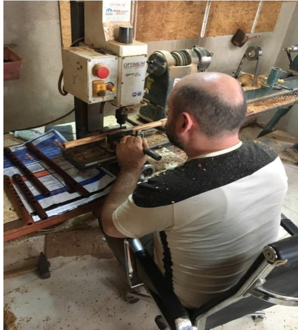
Resim 18: Mey çalgı gövdesinin perdelerinin delinmesi
