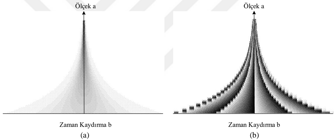
Şekil 3.6. Bir delta fonksiyonunun dalgacık dönüşümünün (a) büyüklüğü ve (b) fazı.
