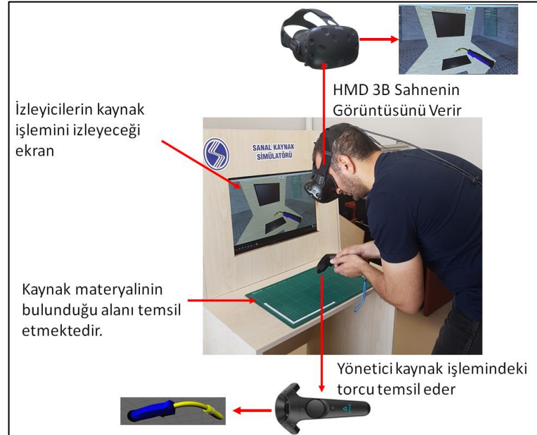
Şekil 3.1. Sanal kaynak simülatörünün bileşenleri
