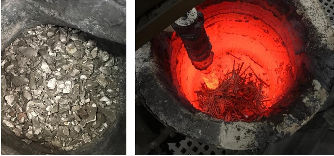
Şekil 3.3. Deneysel çalışmalarda kullanılan Fe-Ti alyajları ve potada aşılama yöntemi
