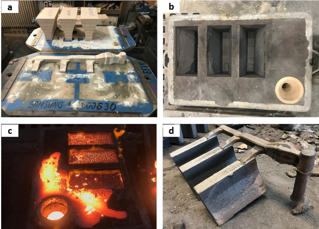
Şekil 3.4. Deneysel çalışmalarda kullanılan numune bloklarına ait: (a) model görüntüsü, (b) kalıp görüntüsü, (c) döküm sonrası kalıp görüntüsü, (d) nihai ürün görüntüsü
