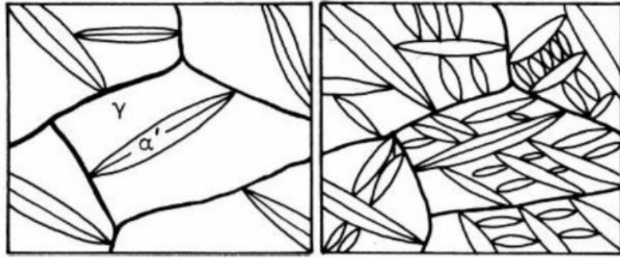
Şekil 2.21. \alpha -martenzit plakalarının büyümesinin şematik gösterilişi [98]
