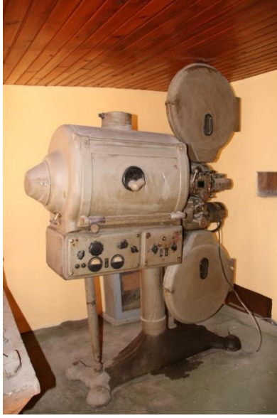
Resim 147: Yapının Birinci Katındaki Kömürlü Sinema Makinesi (Servet Özkan)
