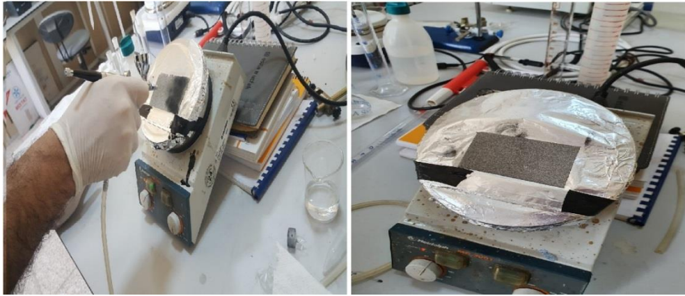
Şekil 3.5. Elektrot malzemesi için elde edilen karışımın nikel köpük üzerine püskürtülme yöntemiyle uygulanması.
