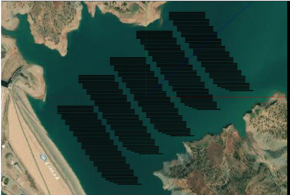
Şekil 3.34. Siirt ili Alkumru HDS üzerinde hibrit enerji sisteminin bir parçası olan hidro-solar enerji sistemi planlamasını gösteren çizim.
