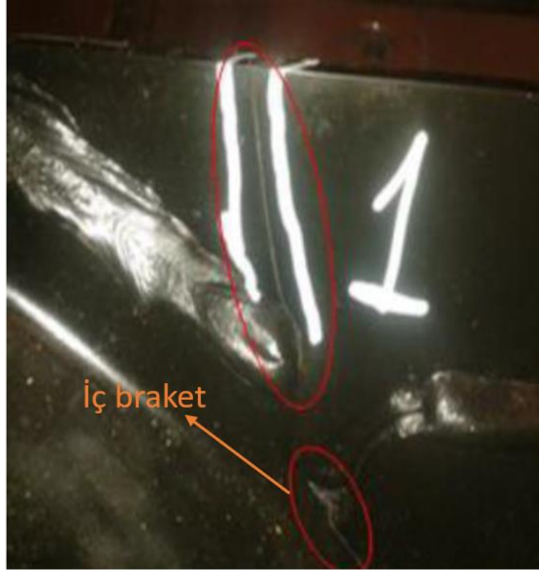
Şekil 6.28. Arka süspansiyon bir numaralı numune test sonucu.
