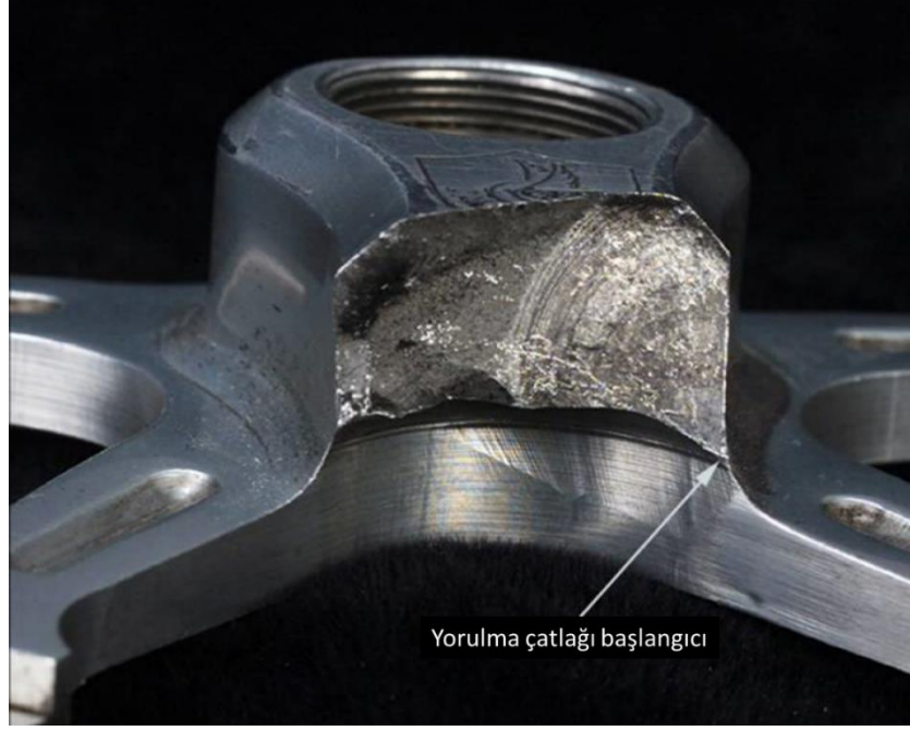
Şekil 1.2. Bisiklet krank kolu yorulma hasarı [4].
