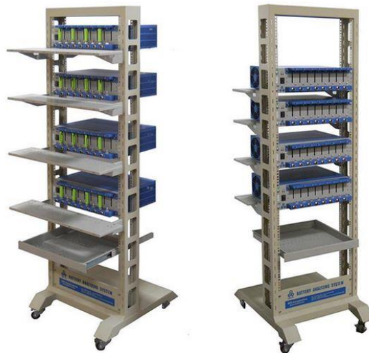
Şekil 6.7. Galvanostatik şarj/deşarj testlerinin yürütüldüğü MTI-BST8-MA elektrokimyasal analiz cihazı.
