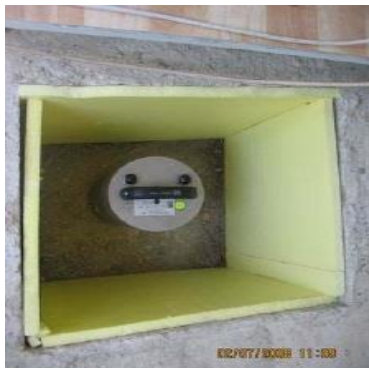
Şekil 3.11. Sismometrenin istasyona yerleştirilmesi (www.koeri.boun.edu.tr)
