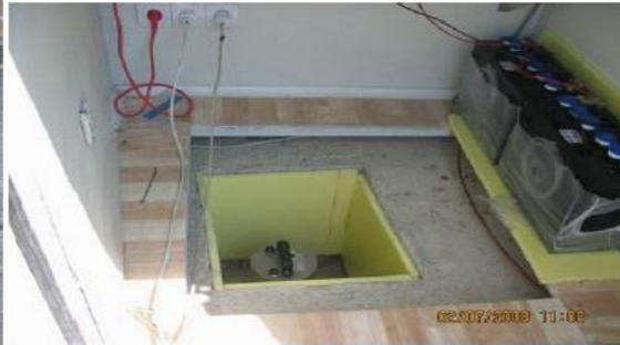
Şekil 3.11. Sismometrenin istasyona yerleştirilmesi (www.koeri.boun.edu.tr)
