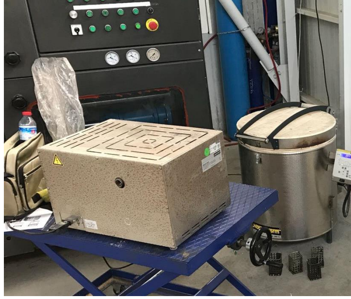
Şekil 3.10. Östenitleme Fırını ve Östemperleme Tuz Banyosunun Hazırlanmış Nabertherm Elektrikli Fırınlar
