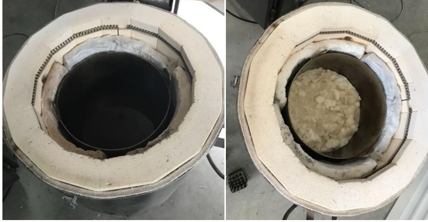
Şekil 3.11. \text{KNO}_3\text{-NaNO}_2 Tuz Karışımının Ergitilmesi
