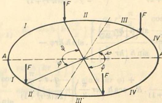
Abb. 3. Belastung des Tragrings nur für die Einzellast  $F$ .
