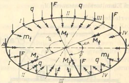
Abb. 2. Belastung des Tragrings (In der Darstellung sind  $m_t$  und  $M_t$  im Uhrzeigersinn als  $90^\circ$  gedreht gezeichnet).
