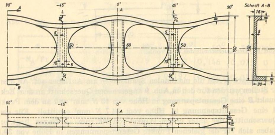
Abb. 10. Das Modell eines Tragrings mit offenem Profil.
