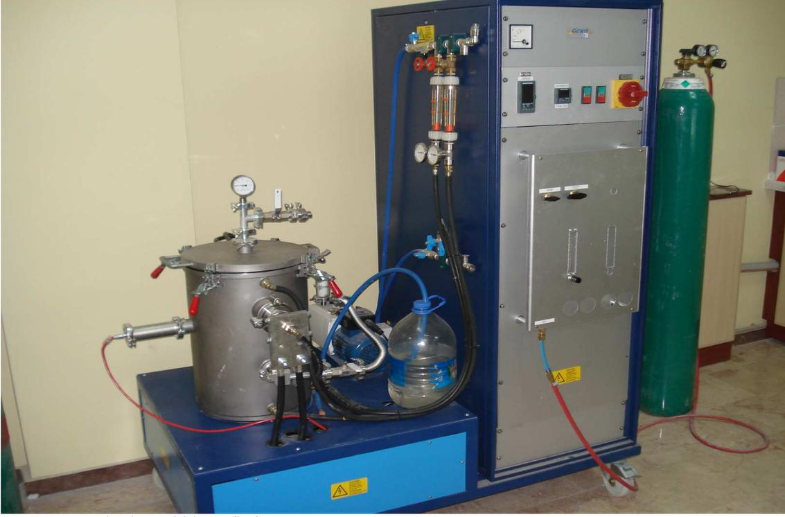
Şekil 7. 1. Yüksek sıcaklık grafit fırını
