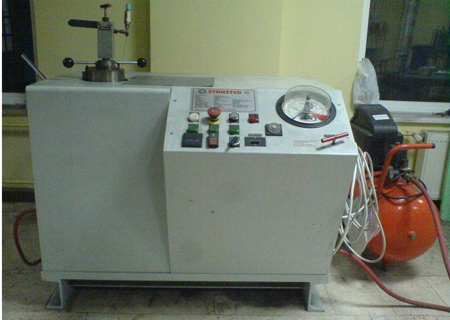
Şekil 6. 4. Seramik peletlerin yoğunluklarının artırılmasında kullanılan soğuk izostatik pres
