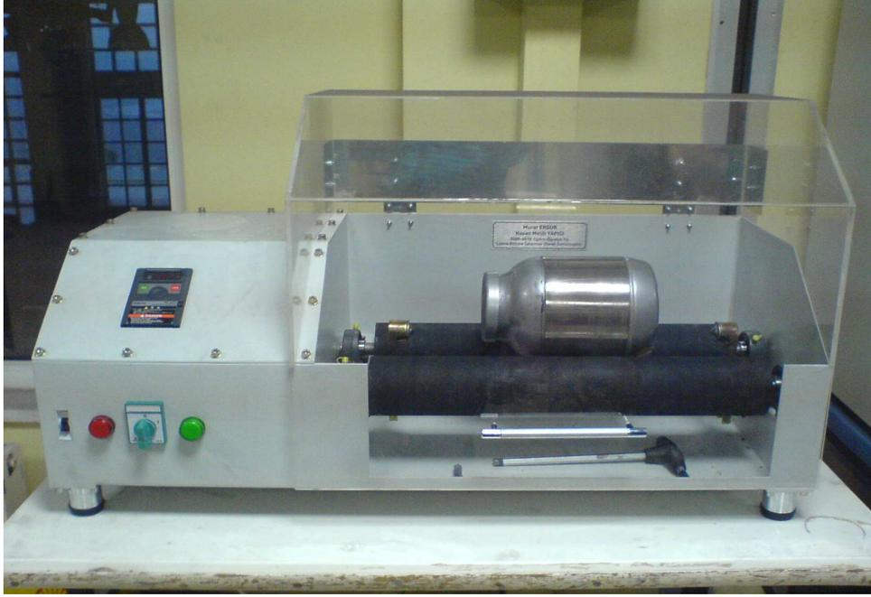
Şekil 5. 6. Toz hazırlamada kullanılan bilyalı değirmen cihazı ve  $\text{Si}_3\text{N}_4$  bilyalar
