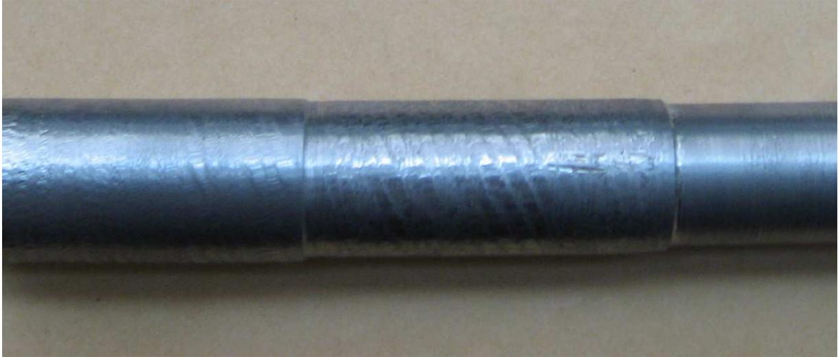
**Şekil 12. 24.** Sertleştirilmiş AISI 4140 çeliğinin WC kesici takımlarıyla işlenmesi sonucu elde edilen yüzey pürüzlülüğü
