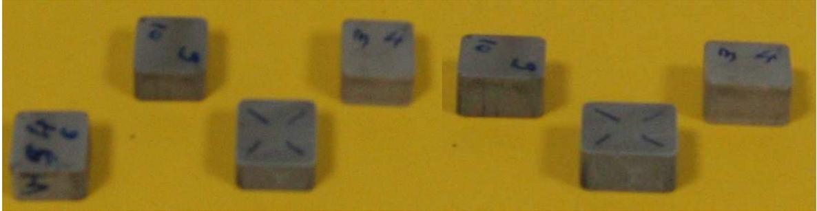
**Şekil 12. 8.** Kesme performansı testleri için kullandığımız eş eksenli seramik kesici takımlar
