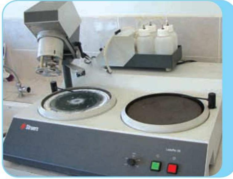
Şekil 8. 3. Struers Labopol-25 parlatma ve zımparalama cihazı
