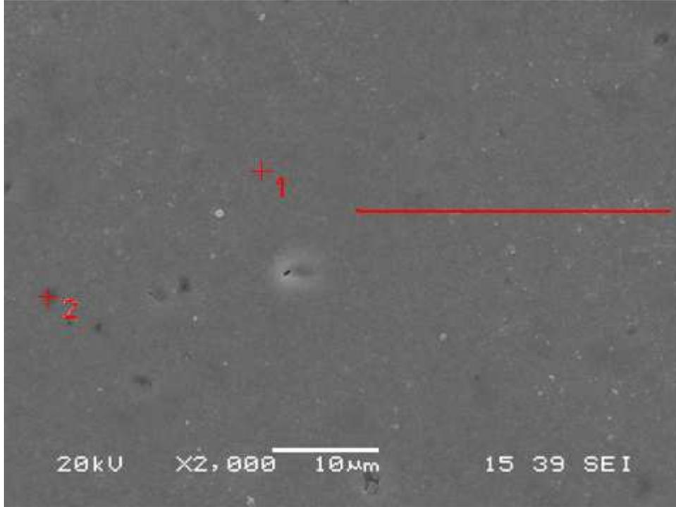
**Şekil 10. 70.** M3 kodlu [% 90SiAlON (z=1 kompozisyon) + %7Y<sub>2</sub>O<sub>3</sub> + %3MgO] kompozisyonunun 1700°C’de 1 saat süreyle sinterlenmesi sonucu elde edilen numunenin X2000 büyütmedeki SEM görüntüsü
