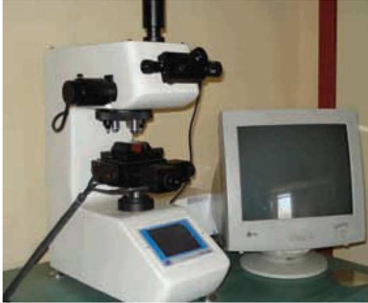
Şekil 9. 2. Future-tech corp. FM-700 mikrosertlik ölçme cihazı
