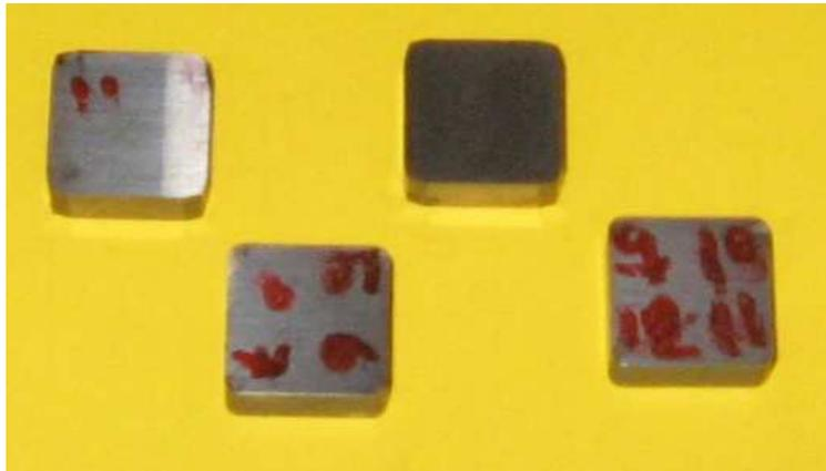
Şekil 12. 23. Tizit Marka WC kesici takımları
