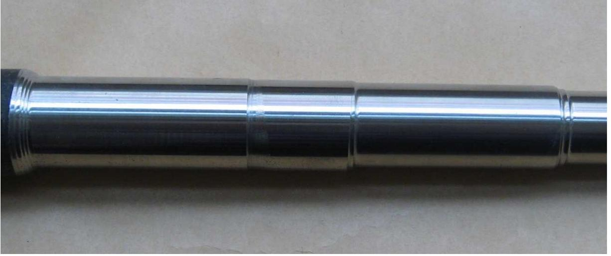
**Şekil 12. 25.** Sertleştirilmiş AISI 4140 çeliğinin  $\beta$ -SiAlON kesici takımlarıyla işlenmesi sonucu elde edilen yüzey
