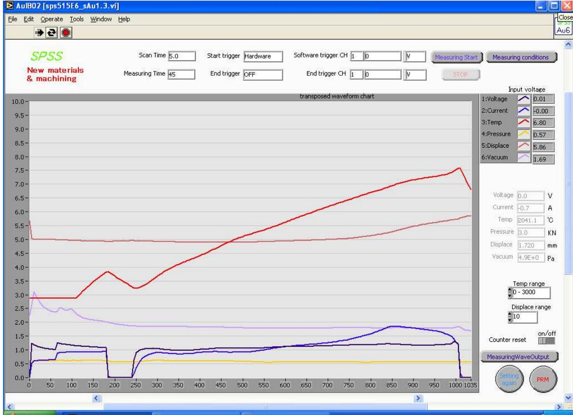
Şekil 13. 7. Florür katkılı kompozisyonun 1500°C'de 3dk SPS sinterlenmesi
