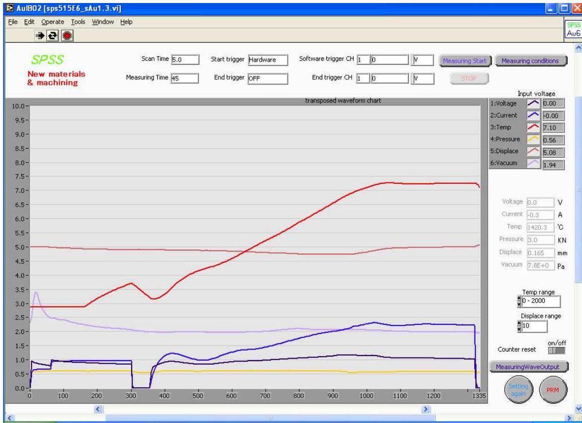
Şekil 13. 4. Oksit katkılı kompozisyonun 1450°C'de 3dk SPS sinterlenmesi
