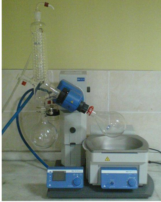
Şekil 4. 1. Rotary Evaporatör cihazı
