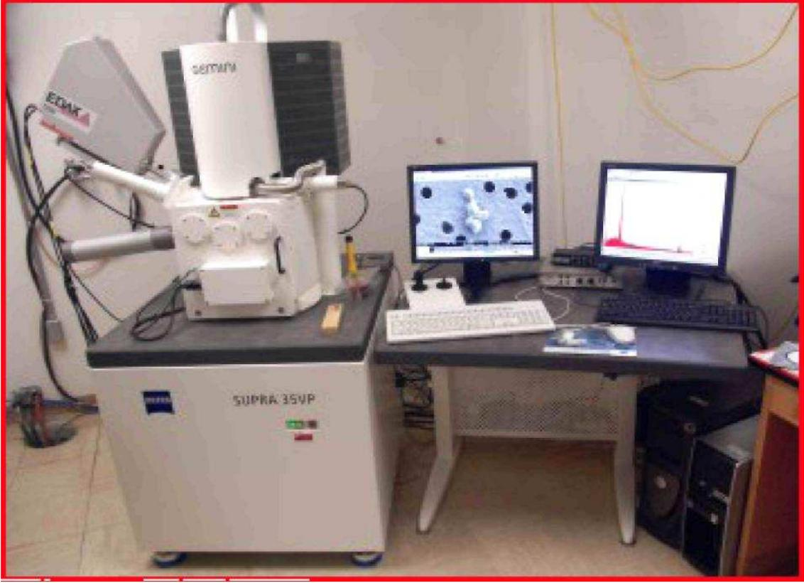
Şekil 8. 5. SEM cihazının genel görünümü
