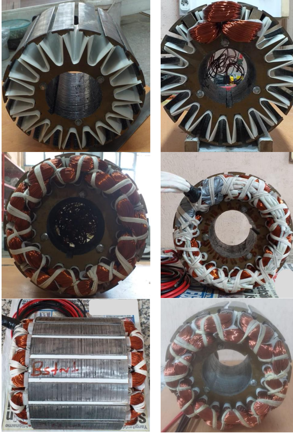
Şekil 3.9. Çift katmanlı sarım yapılmış stator paketi
