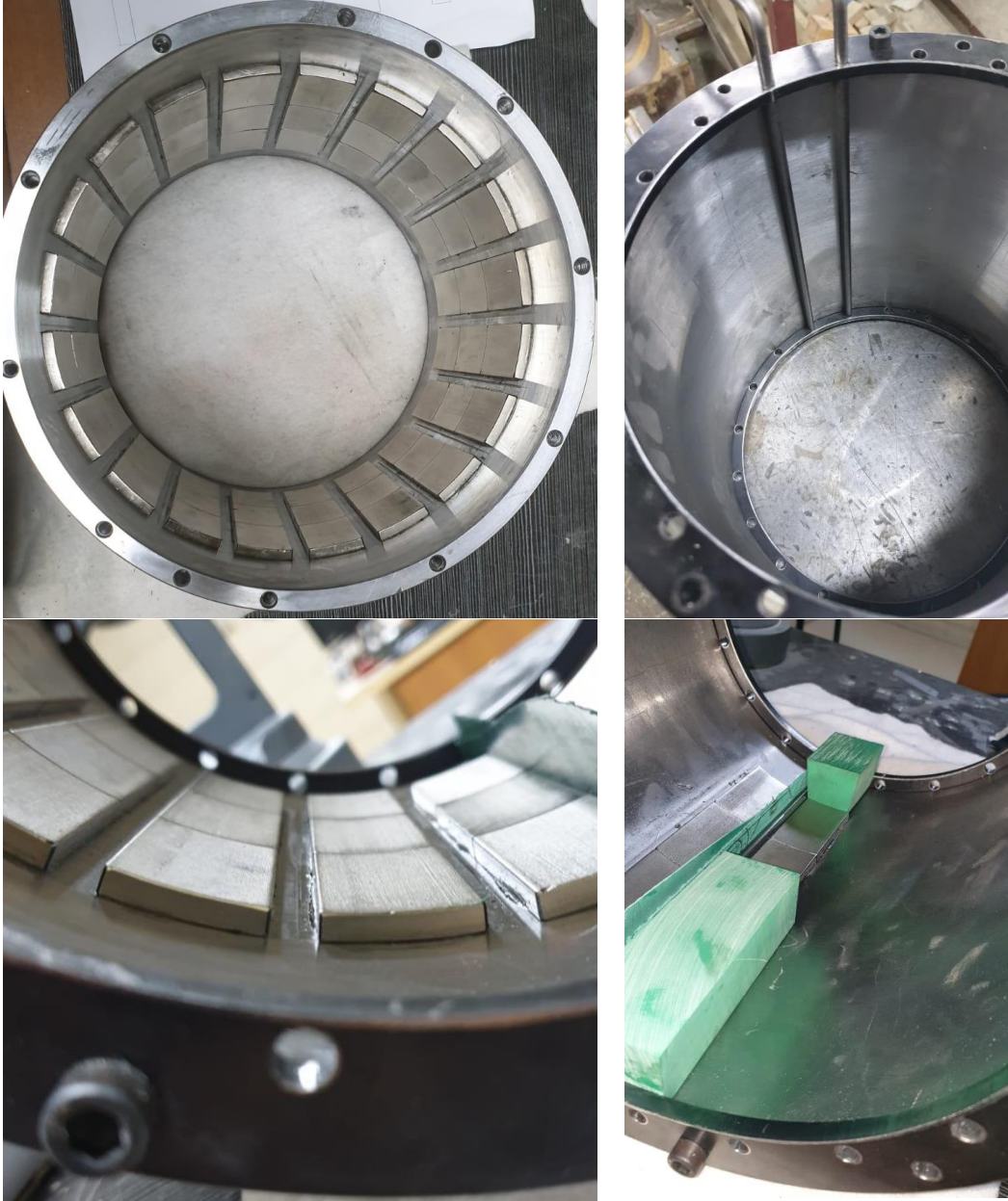
Şekil 3.10. Rotor ve mıknatısların rotor üzerine yapıştırılma aşamaları
