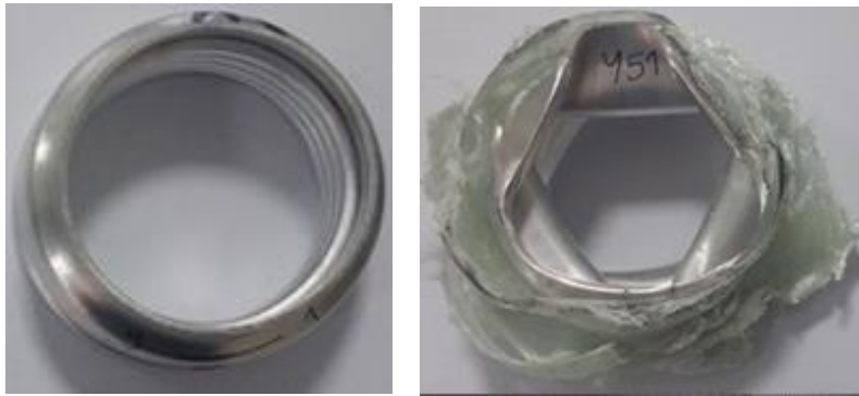
Şekil 40. Özdeş iki numunede dışarıdan yapılan takviyenin katlanma moduna olan etkisi
