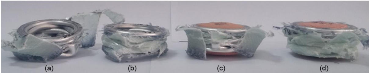
Şekil 51. Cidar ezme işlemi uygulanmış, takviyeli numunelerin deney sonrası görüntüleri. (a) dışarıdan takviyeli numune tetikleme yok b) dışarıdan takviyeli numune tetikleme var, c) dışarıdan ve içeriden takviyeli numune tetikleme yok, d) dışarıdan ve içeriden takviyeli numune tetikleme var.
