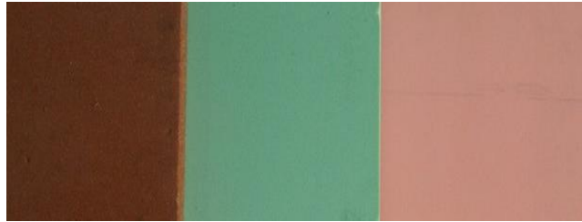
Şekil 5. Deneylerde kullanılan farklı yoğunluktaki PVC köpük 60,80 ve 100 \text{ kg/m}^3
