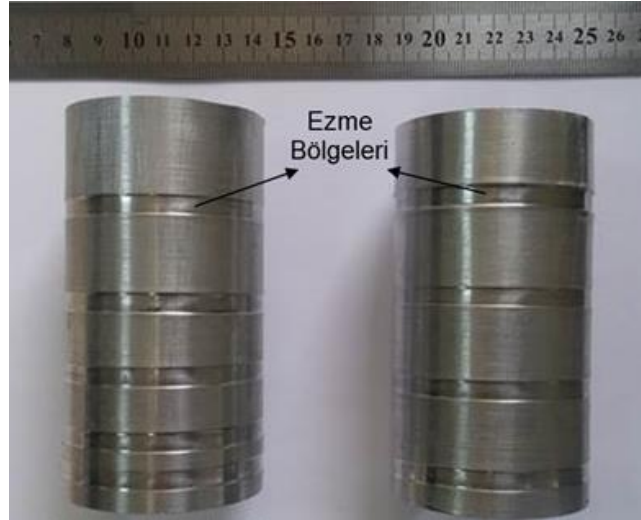
Şekil 18. Numune üzerinde yukarıdan aşağıya ezme sıklığı arttırılmış ve eş aralıklı ezilmiş (ezmeler arası mesafe 10 mm) numunelerin örnek görüntüsü. Çap (D)= 58 mm, cidar kalınlığı (t): 1,5 mm, ezme miktarı yaklaşık 0,50 mm.
