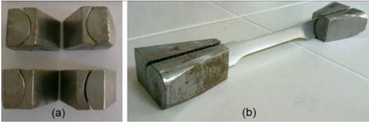
Şekil 2. (a) Numune sıkıştırma aparatı 40 mm ve üstü çaplar için (b) Numunenin çenelere yerleştirilmesi.
