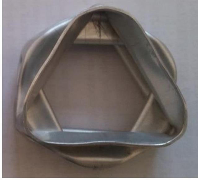
Şekil 17. Elmas modda deforme olmuş bir numunenin üst görüntüsü (D=48, t=1, L=106 mm)
