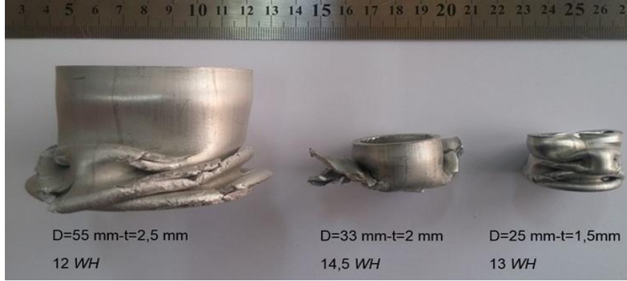
řekil 15. Farklı sertlik ve aplardaki numunelerin aksenal basma zorlanması altındaki davranıřı
