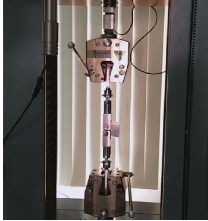
Şekil 3.2.10. Zwick marka 50 kN kapasiteli çekme cihazı.
