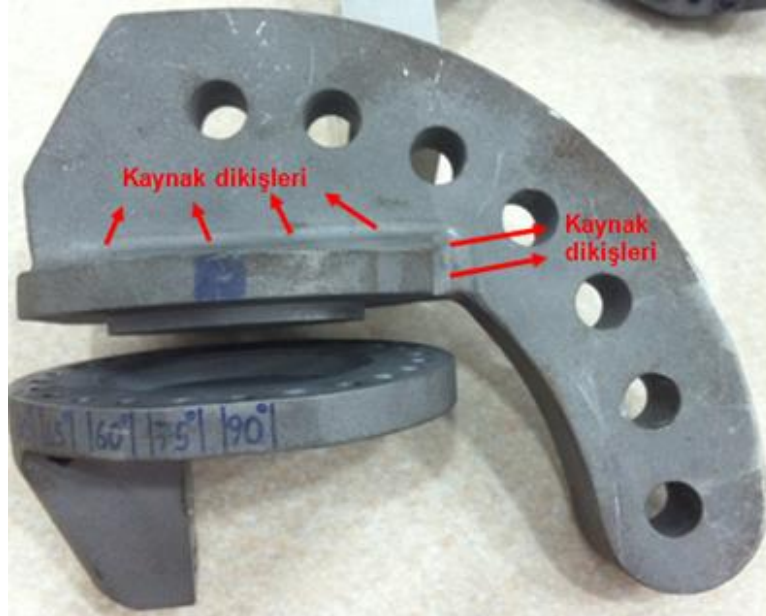
Şekil 3.2.109. Mod-II/III CTST-numune tutucusunun mod-II/III yüklemesi yapabilmesi için tasarlanan ve kaynak işlemi ile tutucuya tutturulan aparat ve tutucunun yakın görünümü.
