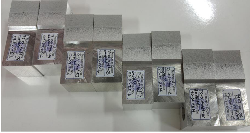
Şekil 3.3.92 TS Hadde yönünde mod I çatlak ilerleme davranışının tespiti için kullanılan CT numunelerin kırılmış halleri
