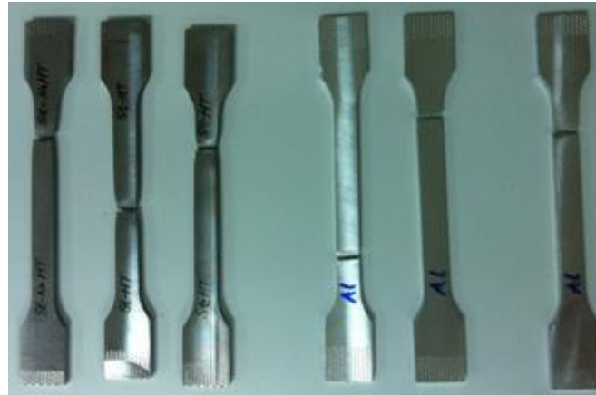
Şekil 3.2.6. Çekme testi sonrası alüminyum ve çelik malzemelerinin görünüşü.
