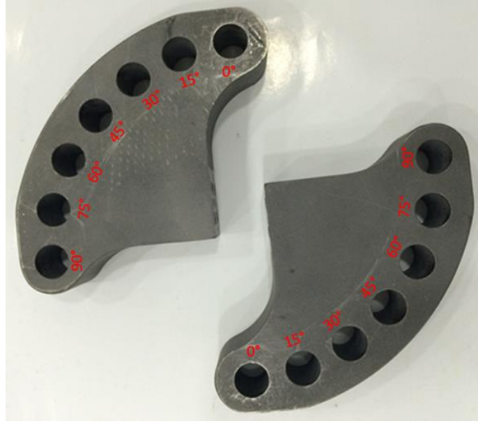
Şekil 3.2.72. Mod I-III CTT numune tutucusu. Wei vd. (2011), Deng X vd. (2014)
