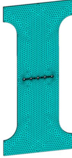
Şekil 3.1.34. Çoklu çatlak numunesinin sonlu elemanlar modeli
