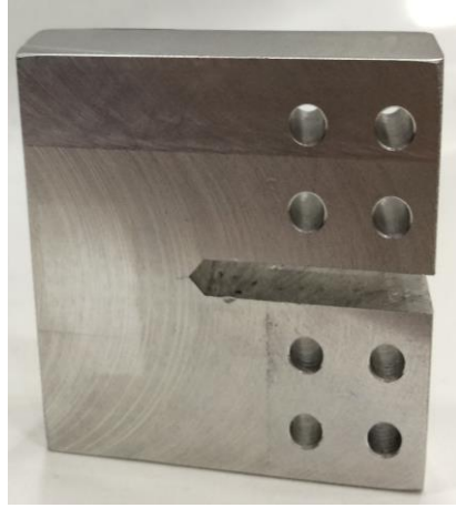
Şekil 3.2.71. 12.5 mm kalınlıktaki mod-I/III CTT numunesi.
