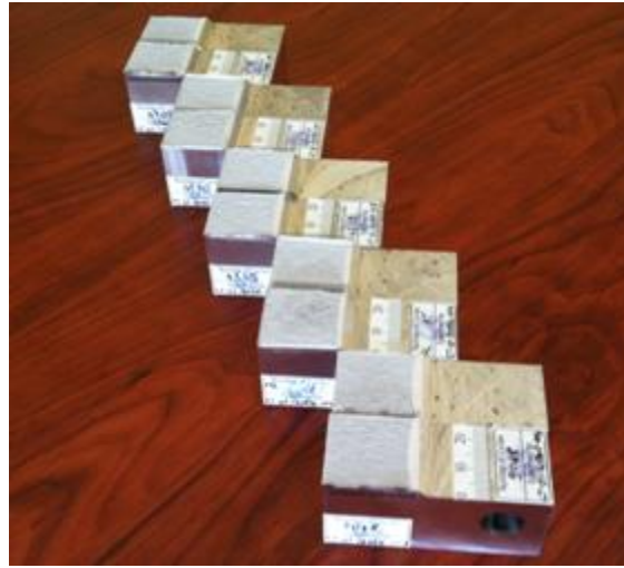
Şekil 3.2.11. Kırılma tokluğu testi sonucunda Alüminyum malzemelerin perspektif görünüşü.
