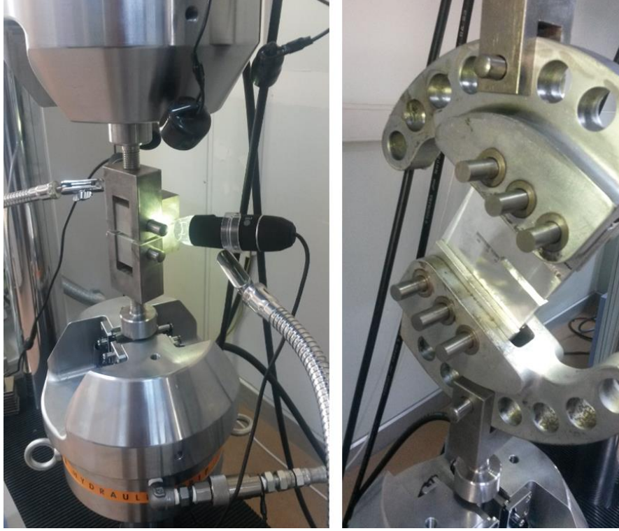
Şekil 3.3.90 CT ve Richard Numuneleri Kırılma Tokluğu Testi Görüntüleri
