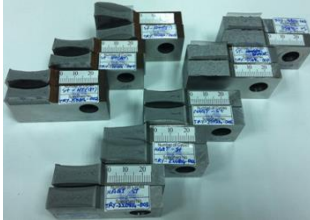
Şekil 3.2.12. Kırılma tokluğu testi sonucunda çelik malzemelerin perspektif görünümü.
