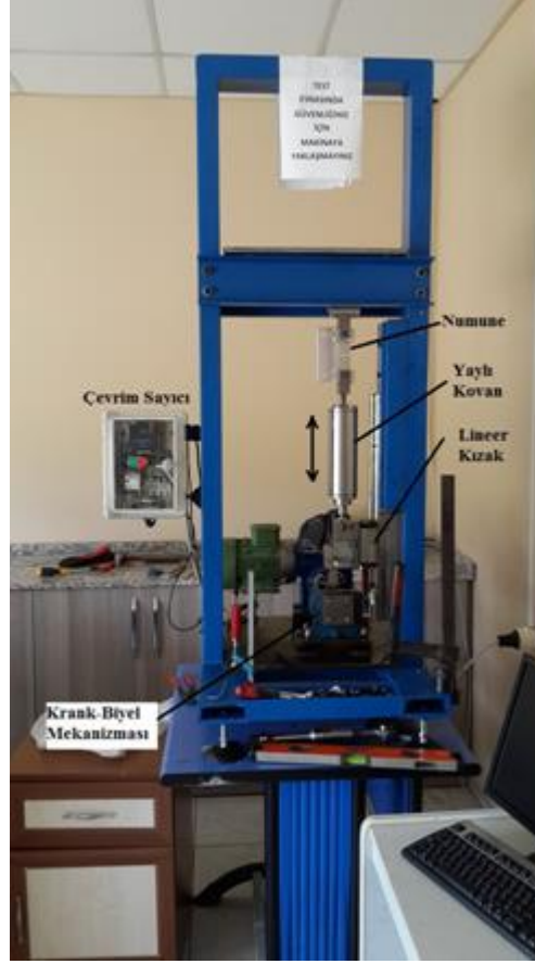
Şekil 3.2.7. Yorulma ön çatlaklarının oluşturulması için imal edilen yorulma cihazı.
