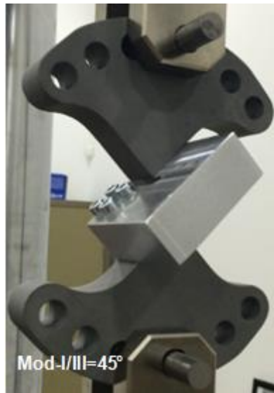
Şekil 3.2.132. Çatlak ilerleme başlangıç noktasının tespiti için, mod-I/III yükleme açısında CTT-numunesi için gerçekleştirilen testten bir kesit.
