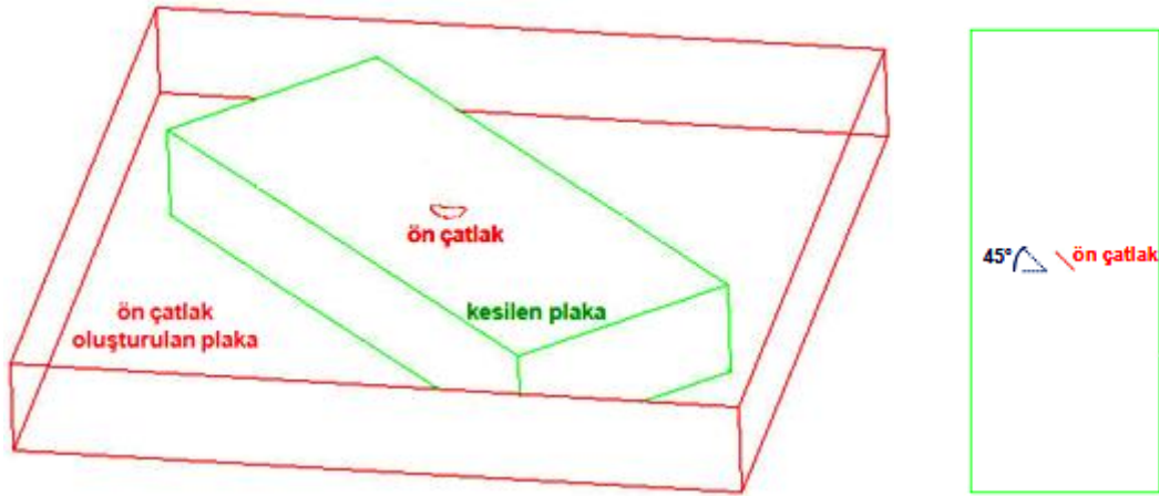
Şekil 3.3.48. Mod-I yüklemesi altında ön çatlak oluşturulmasının ardından belirli açılarda plakalar kesilerek çatlakların plaka kenarlarına açılı olarak yerleştirilmesinin sağlanması.
