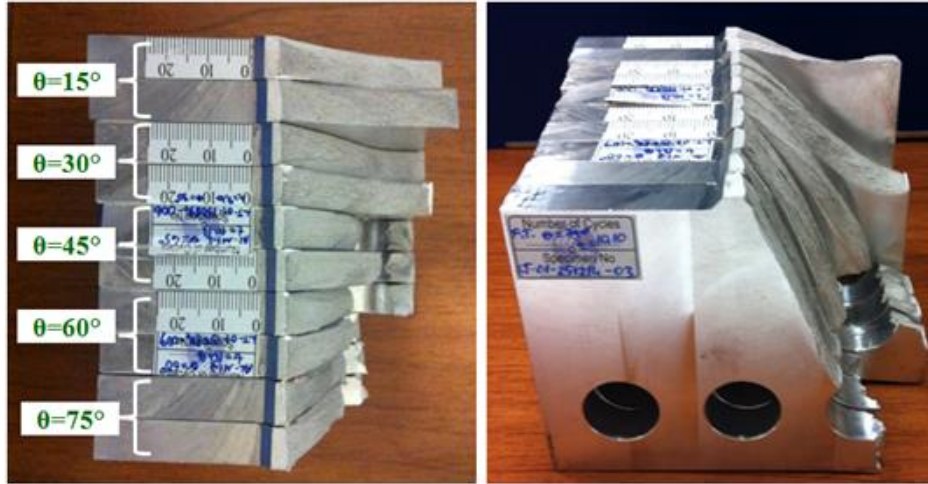
Şekil 3.2.37. Farklı açılarda kırılan numune yüzeylerinin perspektif görünümü.
