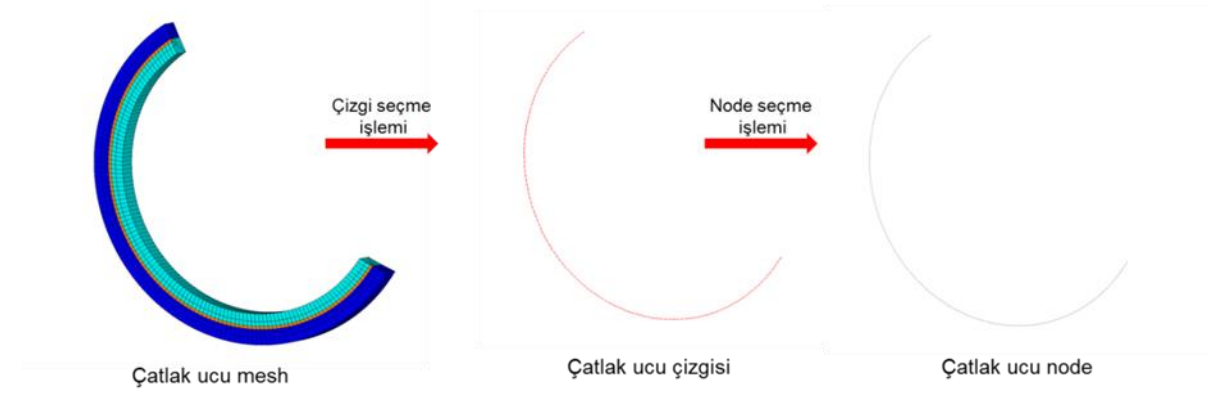
Şekil 3.1.9. Çatlak ucu düğüm noktaları (node) seçimi
