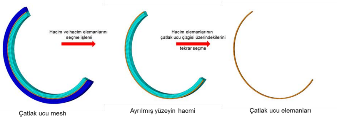
Şekil 3.1.10. Çatlak ucu elemanlarının seçimi
