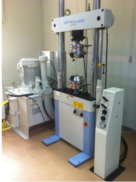
Şekil 3.2.13. Schimadzu 100 kN kapasiteli eksenel yorulma cihazı.
