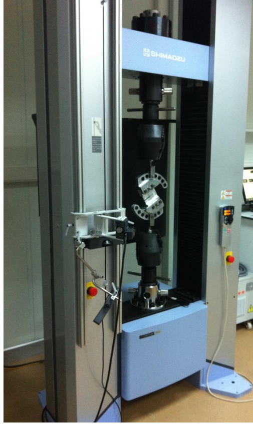
Şekil 3.2.35. Schimadzu 200 kN kapasiteli eksenel çekme cihazı.
