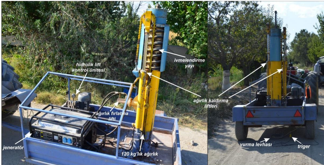
Şekil 24. Sismik yansıma çalışmasında kullanılan ağırlık düşürme sistemi
