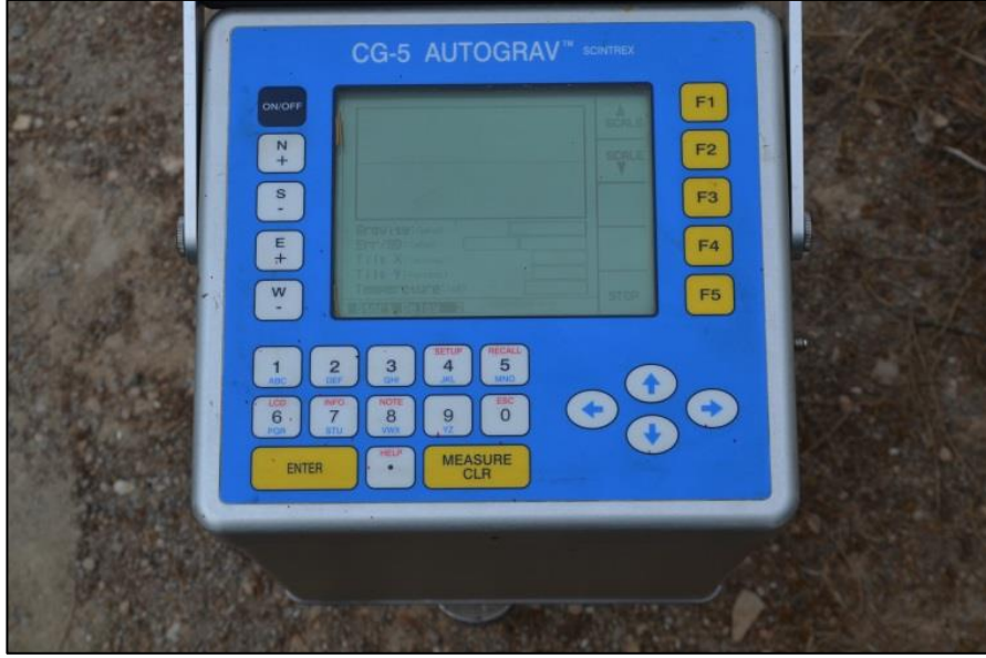
Şekil 33. Çalışmada kullanılan CG-5 AUTOGRAV gravimetresi
