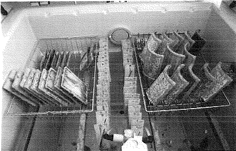
Şekil 2.13. Test numunelerinin test ünitesindeki yerleşimi
