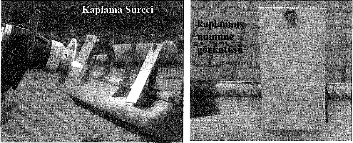
Şekil 2.2. Kaplama operasyonu (Zn/Al 85/15) ve kaplanmış numunenin görüntüsü
