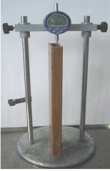
Şekil 42. Isı genleşme deneyinde numune boylarının ölçülmesi
