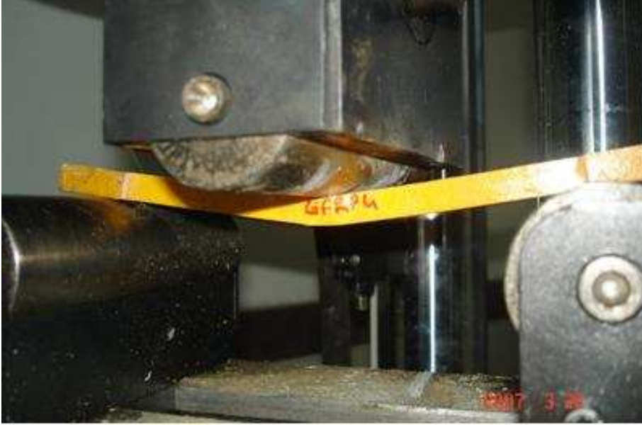
Şekil 39. Eğilme deneyi yüklemesi
