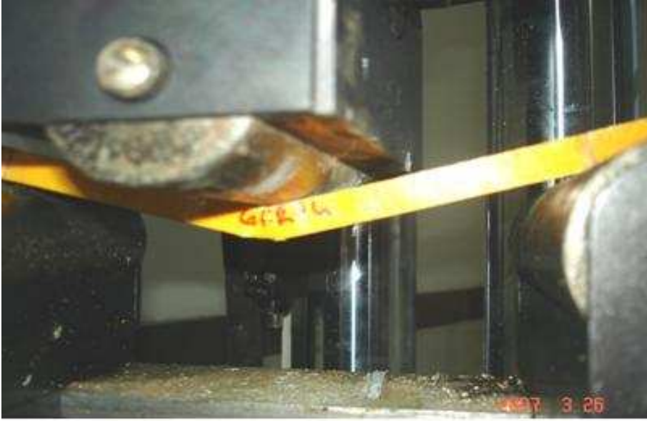
Şekil 40. Eğilme deneyinde kırılmış numune örneği
