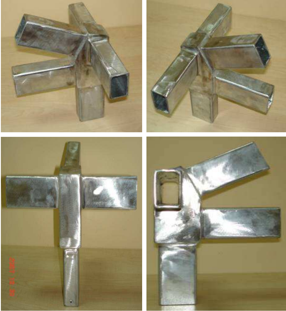
Şekil 66. Sera CTP profillerle kolon-çatı birleştirme elemanı
