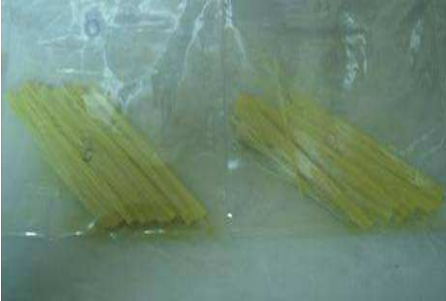
Şekil 45. 600 °C’lik ısı işlem sonucu fırından çıkarılan orta bölgedeki boyuna fiberler
