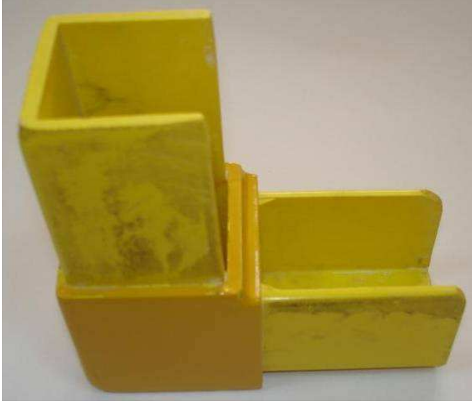
Şekil 62. Yapıştırırmalı-geçmeli birleřtirmelerde kullanılan CTP birleřtirme elemanı [SARIBIYIK, 2000]
