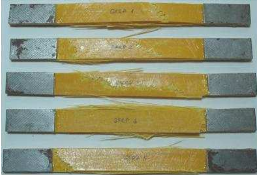
Şekil 32. Çekme testi sonucunda kopmuş deney numuneleri
