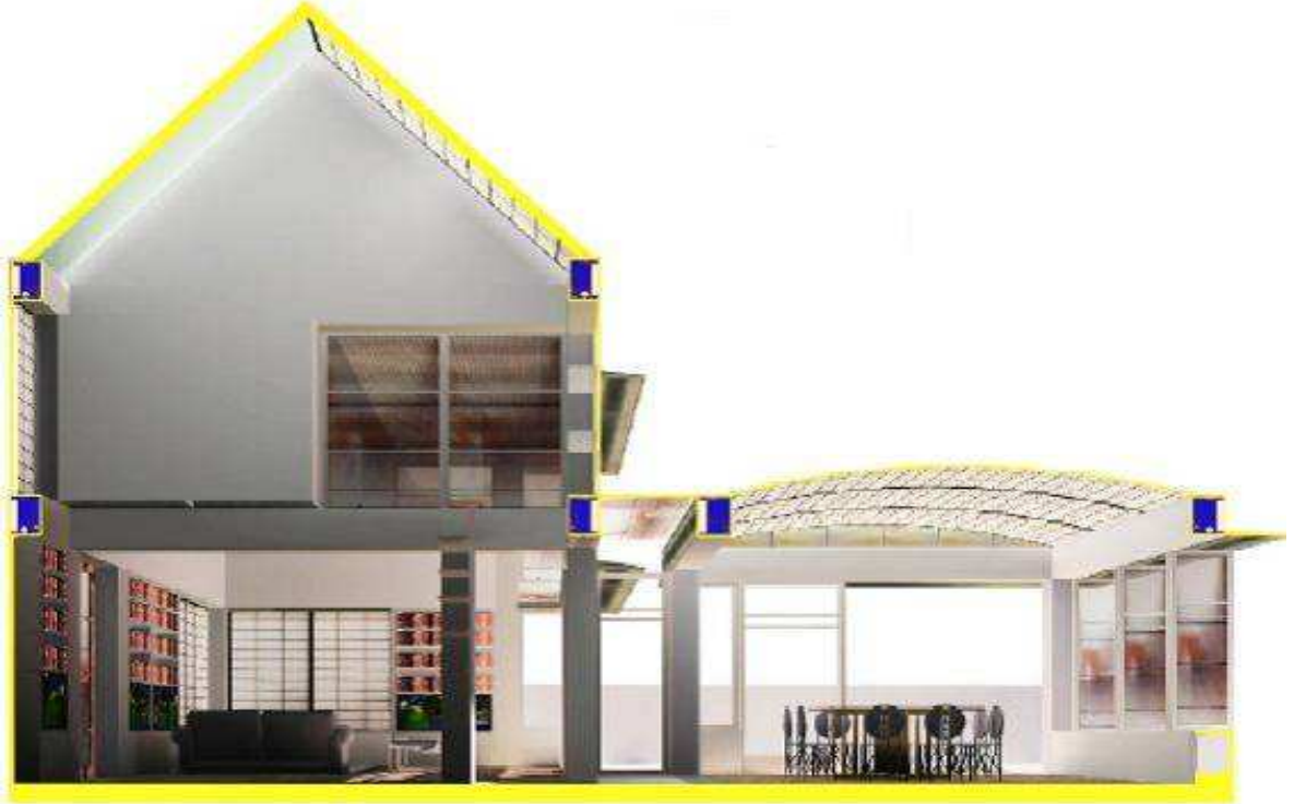
Şekil 27. Pultrüzyonla üretilmiş CTP kullanılarak yapılmış prototip yapı
