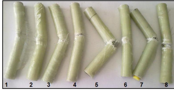
Şekil 229. Çapı 30 mm olan içten ve dıştan (CE) takviyeli kombinasyonların darbe deneyi sonrası görünüşleri
