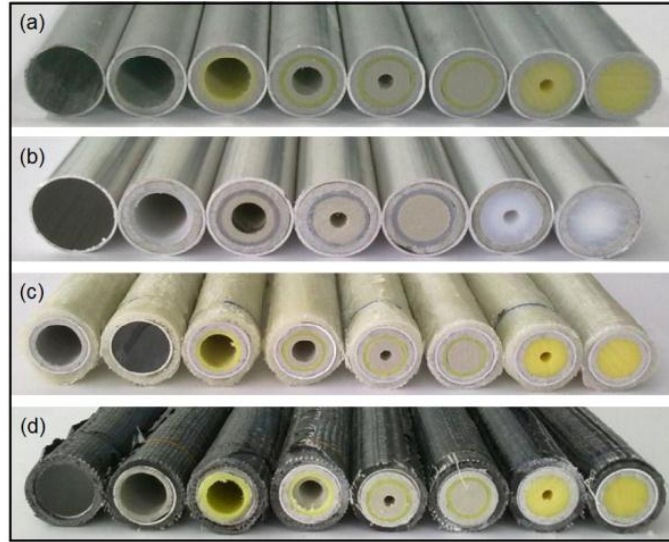
Şekil 69. 30 mm çaplı üç nokta eğme deneyi numuneleri, (a) içten takviyeli, (b) içten takviyeli, (c) dıştan cam elyaf takviyeli, (d) dıştan karbon elyaf takviyeli.
