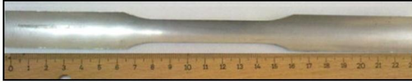
Şekil 53. Çapı 31mm olan borudan işlenen çekme numunesi.
