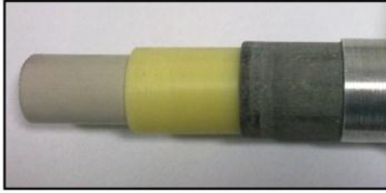
Şekil 66. Soldan sağa sırasıyla kullanılan PP, K ve PB'nin alüminyum tüpe yerleştirilmesi.
