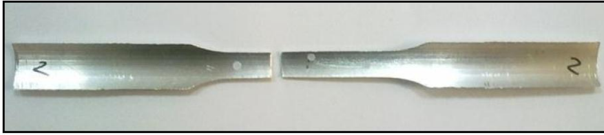
Şekil 127. D/t:30/1 mm alüminyum tüpe ait numunenin çekme deneyi sonrası görünüşü.
