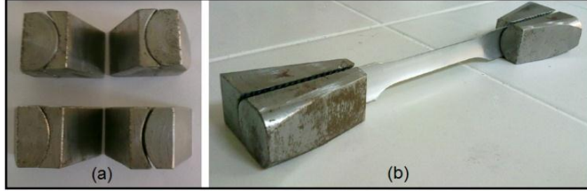
Şekil 54. (a) Çekme çeneleri (31 ve 40 mm çaplı borular için), (b) Numunenin çenelere yerleştirilmesi.
