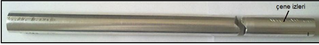
Şekil 125. D/t:24/1 mm alüminyum tüpe ait numunenin çekme deneyi sonrası görünüşü.
