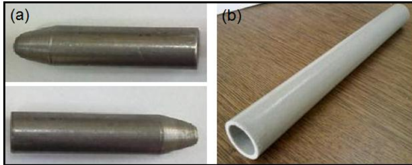
Şekil 56. (a) Pultrüzyon boru için hazırlanan tapalar, (b) Boru çekme numunesi.
