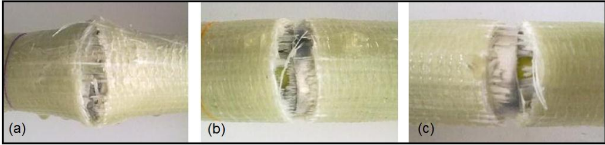
Şekil 192. Üç nokta eğme deneyi uygulanmış CE'lı numunelerde kırılma bölgesi resimleri: (a) CE+T+PB+K(2), (b) CE+PB+K+PP(6), (c) CE+T+PB+K(11-dolu).
