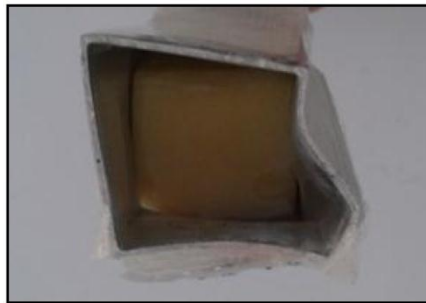
Şekil 220. 2 kat CE ve 210 mm K takoz takviyeli kirişte mesnet tarafından oluşturulan hasar.
