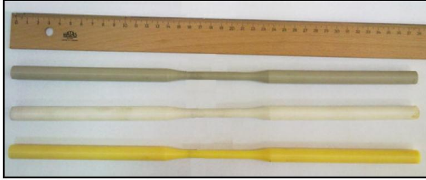
Şekil 55. Polimerik malzemelerden (K, P ve PP) çıkartılan silindirik çekme numuneleri.
