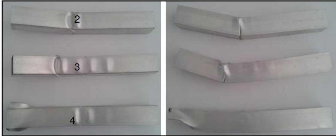
Şekil 215. İçten K takoz ile takviyeli kare kesitli kirişin üç nokta eğme deneyi sonrası görünüşü.
