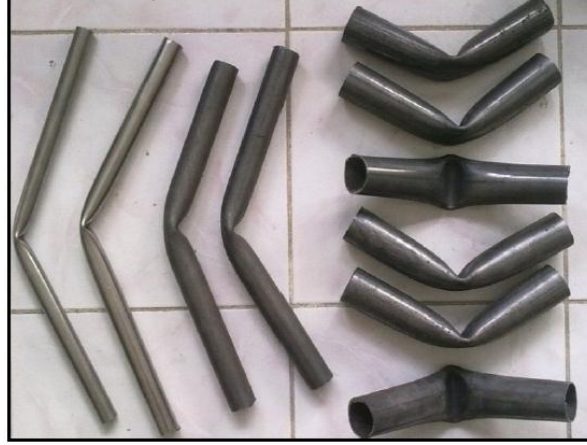
Şekil 44. Ön denemelerde kullanılan darbe deney numuneleri.
