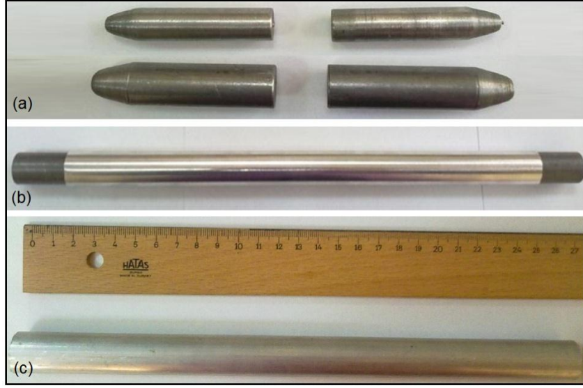
Şekil 50. Boru çekme numunesinin hazırlanması: (a) Çapı 19/1 ve 24/1 mm alüminyum borular için hazırlanan tapalar, (b) Boru çekme numunesine tapaların yerleştirilmesi, (c) Boru çekme numunesi.
