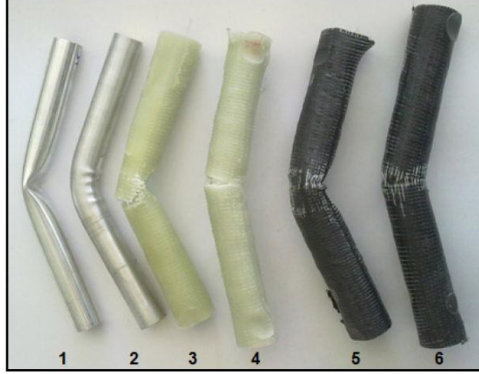
Şekil 187. Üç nokta eğme deneyi uygulanmış bir grup Ø24x250 mm numunenin deney sonrası görünüşü.
