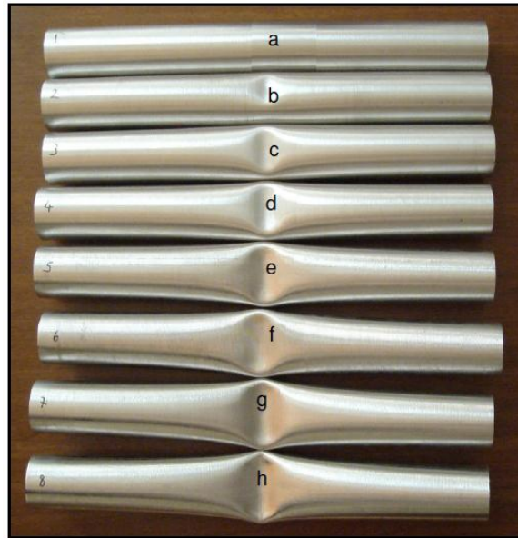
Şekil 20. ( D/t=48/1 mm) tüp ile yapılmış üç nokta eğme deneyinden sonraki numune görünüşleri: a) 0 mm, b) 5 mm, c) 10 mm, d) 15 mm, e) 21 mm, f) 25 mm, g) 31 mm, h) 35 mm.
