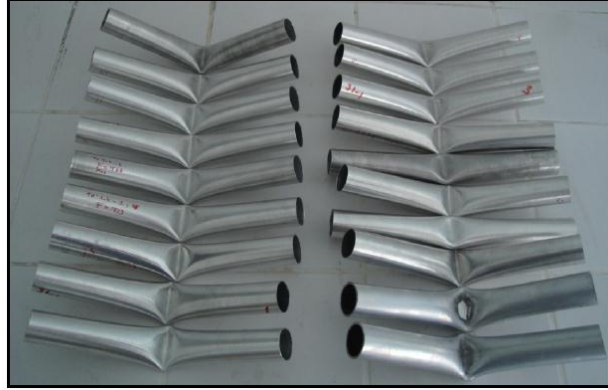
Şekil 153. Üç nokta eğme deneyine tabii tutulmuş bir grup numunenin görünümü.
