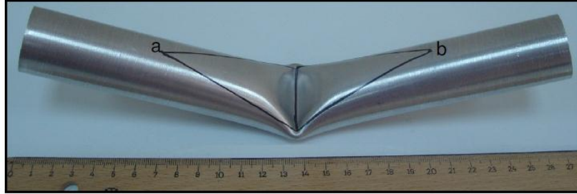
Şekil 204. Alüminyum boruya PVC köpük (108 mm) yapının takviye edildiği numune.
