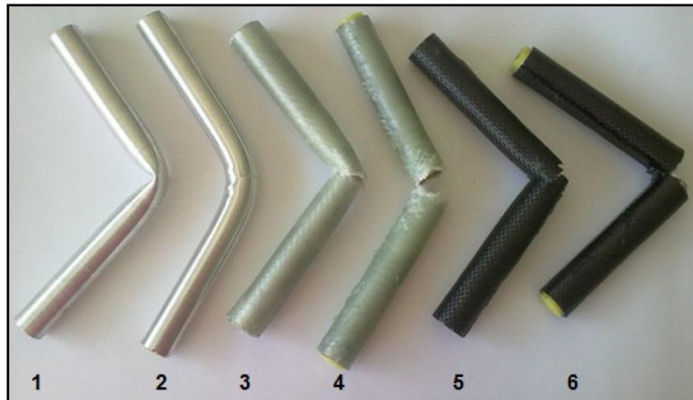
Şekil 225. Çapı 19 mm olan içten ve dıştan takviyeli kombinasyonların darbe deneyi sonrası görünüşleri.
