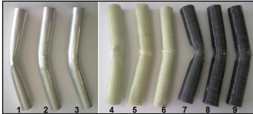
Şekil 202. Üç nokta eğme deneyi uygulanmış bir grup Ø40 mm numunenin deney sonrası görünüşü.
