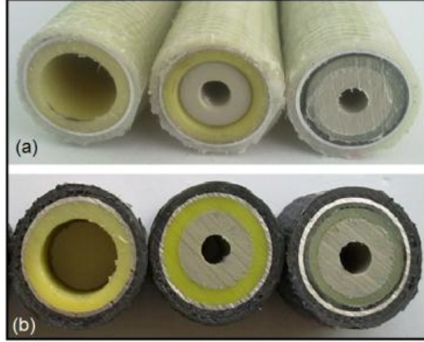
Şekil 67. Dışarıdan ve içeriden takviye edilerek üretilen kombinasyonlar (a) Dışarıdan cam elyaf takviyeli, (b) Dışarıdan karbon elyaf takviyeli kombinasyonlar.
