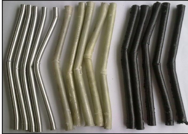
Şekil 236. Burkulma deneyine tabi tutulmuş bir grup deney parçası.
