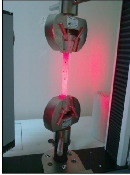
Şekil 134. Cam elyaftan hazırlanan çekme numunesine deneyin uygulanışı.
