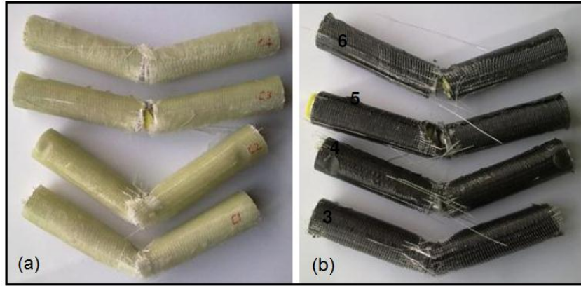
Şekil 230. Çapı 31 mm olan içten ve dıştan takviyeli kombinasyonların darbe deneyi sonrası görünümleri: (a) CE'li numuneler, (b) KE'li numuneler.
