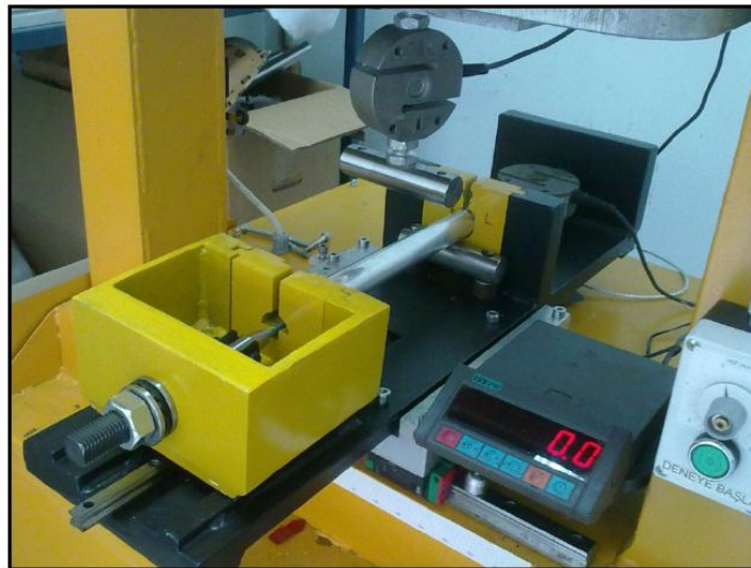
Şekil 41. Ön gerilme düzeneğiyle üç nokta eğme test cihazı üzerinde deneyin yapılması.
