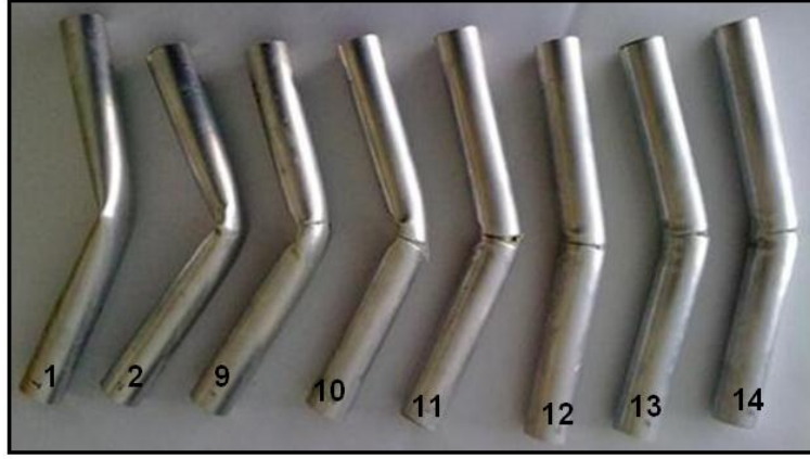
Şekil 166. PB, K ve PP'li kombinasyonların üç nokta eğme deneyi sonrası görünüşleri.
