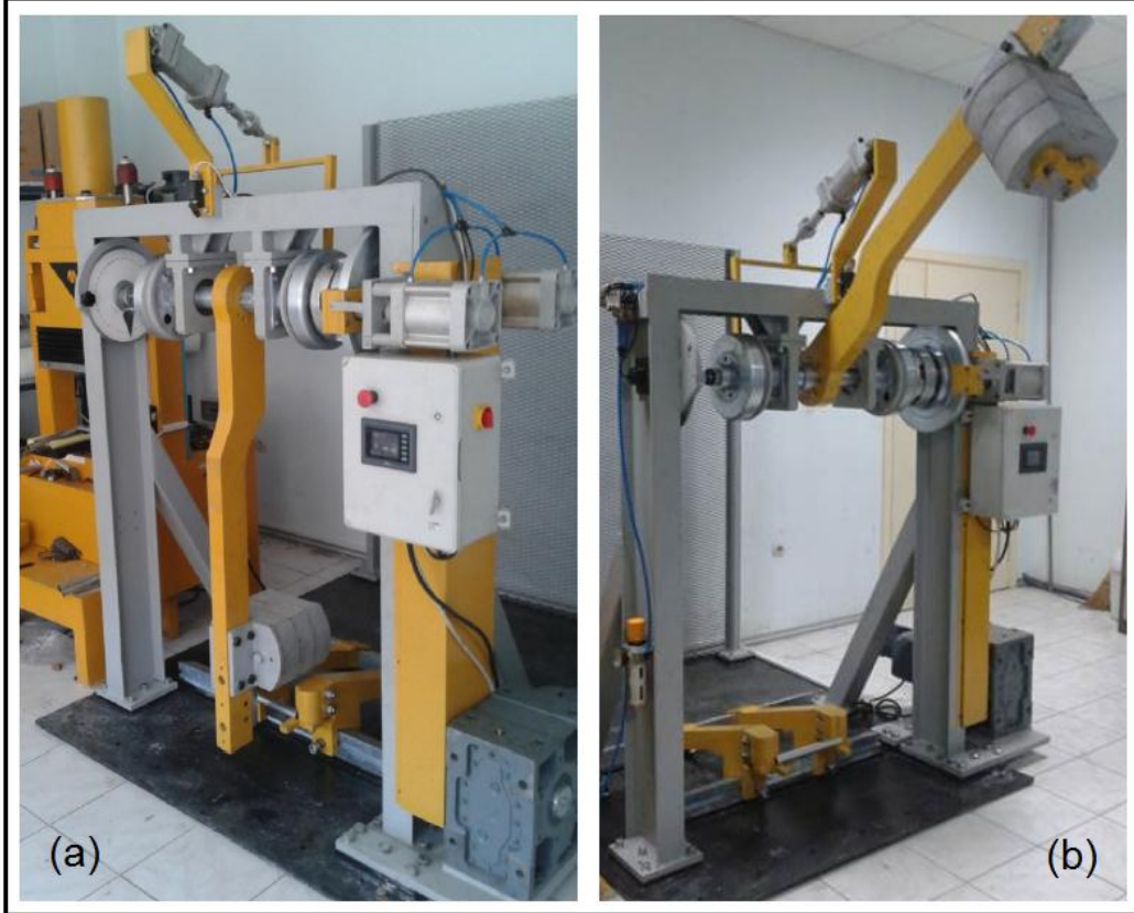
Şekil 43. İmalatı gerçekleştirilen sarkaç tipi darbe test düzeneğinin genel görünüşü: (a) Sarkaç nötr konumda, (b) Sarkaç çalışma yüksekliğinde.
