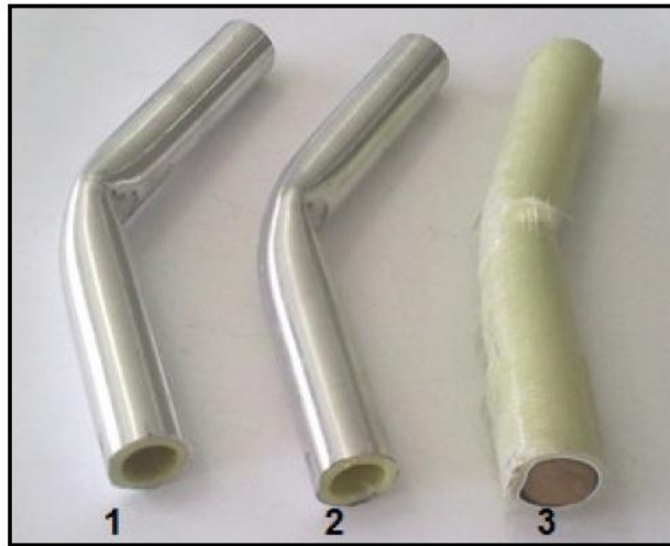
Şekil 232. İçten K ve PVC köpük takviyeli kirişlerin darbe deney sonucu hasara ait görüntüler
