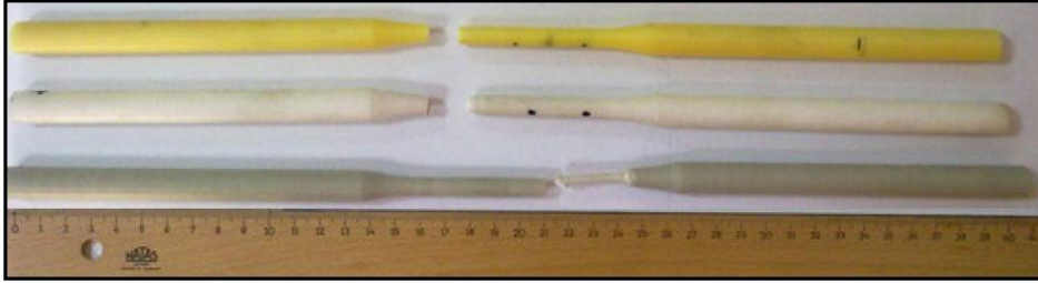
Şekil 148. Polimerik malzemelerden hazırlanan numunelerin çekme deneyi sonrası hasar durumları.
