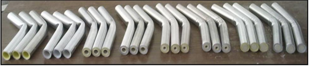
Şekil 169. Üç nokta eğme deneyi sonrası numune görünüşleri.
