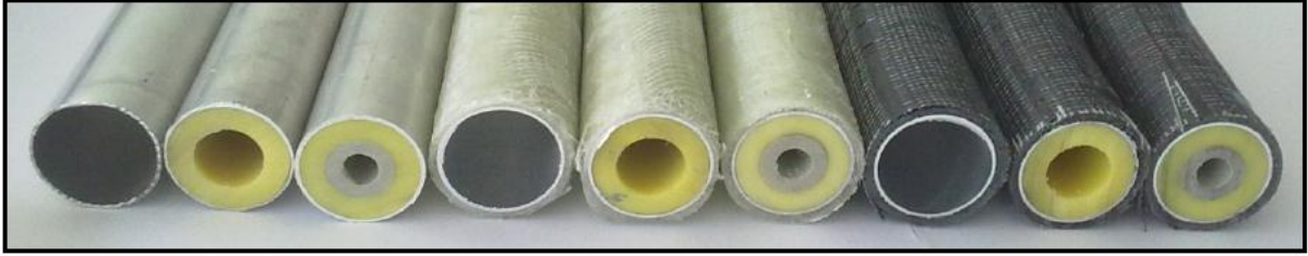
Şekil 200. Ø40 mm olan alüminyum tüp ile oluşturulan kompozit kirişler.
