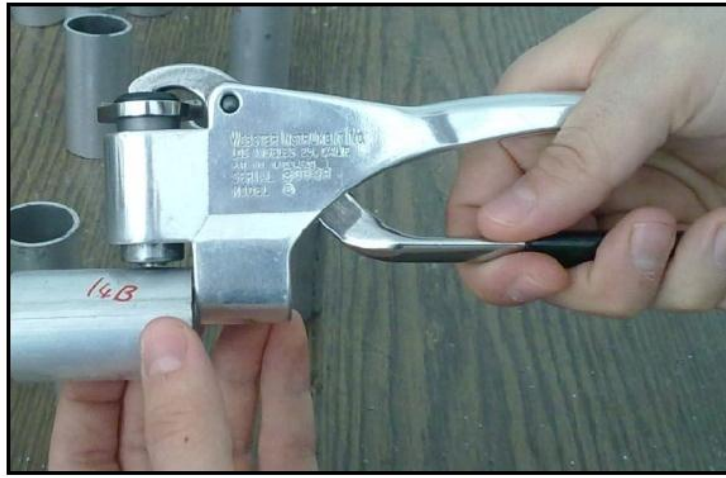
Şekil 48. Borulardan alınan kuponlar üzerinden Webster sertlik ölçme el aleti.
