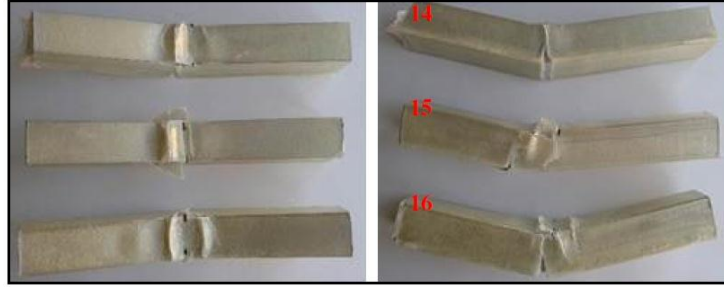
Şekil 224. 6 kat CE ve K takoz takviyeli kirişin yandan ve üstten görünüşleri.
