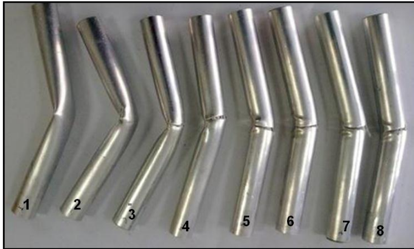
Şekil 161. PB, P ve PP'li kombinasyonların üç nokta eğme deneyi sonrası görünüşleri.
