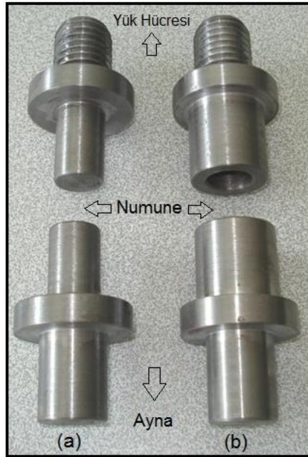
Şekil 238. Bağlantı aparatları: (a) Boş numuneler için, (b) Dolu numuneler için.
