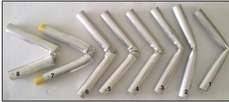
Şekil 227. Çapı 30 mm olan içten takviyeli kombinasyonların darbe deneyi sonrası görünüşleri.
