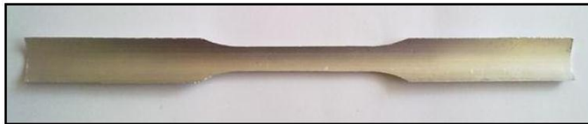
Şekil 57. 30 mm çaplı alüminyum borunun çekme deneyi numunesi.
