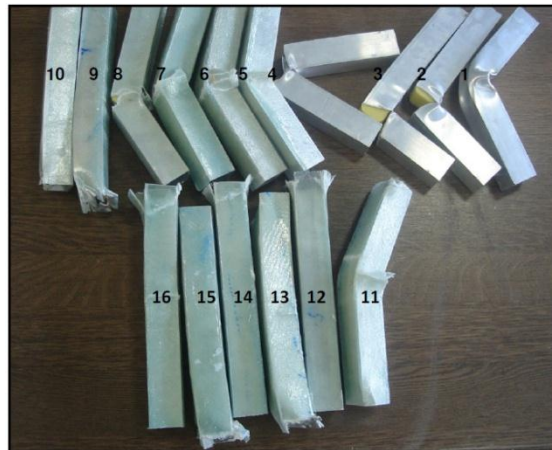
Şekil 233. Kare kesitli içten ve dıştan takviyeli numunelerin darbe deneyi sonucu hasara ait görünüşleri.
