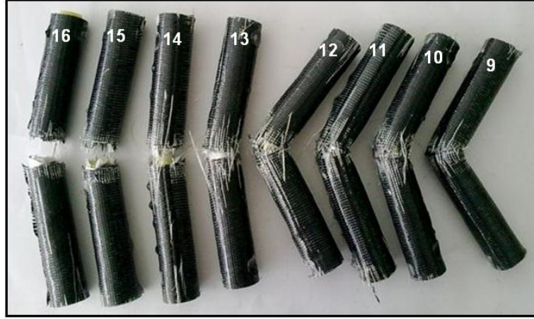
Şekil 228. Çapı 30 mm olan içten ve dıştan (KE) takviyeli kombinasyonların darbe deneyi sonrası görünüşleri.
