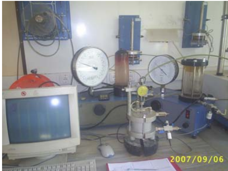
Foto 12. Rowe laboratuvar sönümlenme deneyleri düzeneğinden bir görünüş
