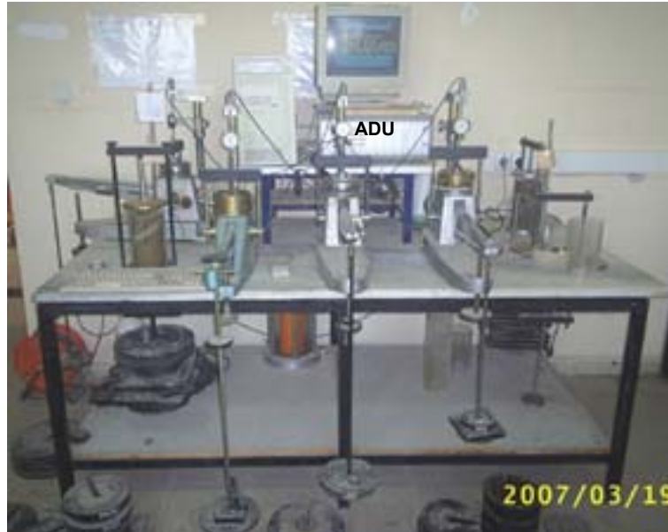
Foto 10. Ödometre' de konsolidasyon deney düzeneği
