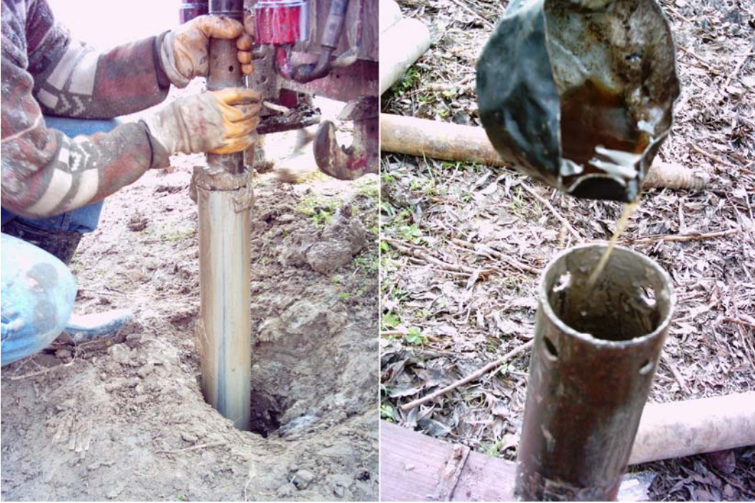
Foto 7. UD numunelerinin alınması ve doğal su muhtevasını korumak için yapılan parafin uygulaması
