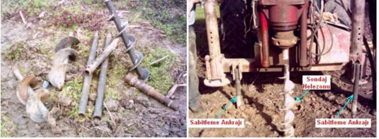
Foto 5. Sabitleme elemanlarının görünümü ve sondaj makinesinin sabitlenmiş durumu
