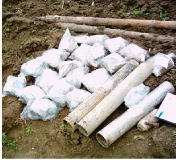
Foto 9. Örselenmiş numunelerin korunması
