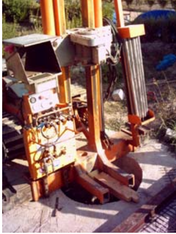
Foto 20. Silindir içinde CPTU uygulaması
