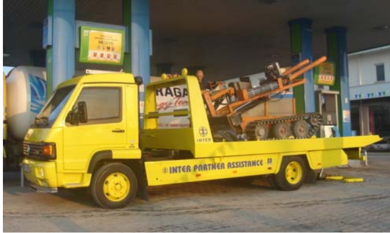
Foto 4. CPT makinesinin araziye naklinde kullanılan araç
