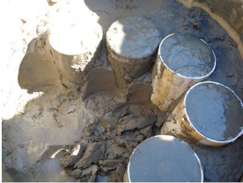
Foto 21. Silindirden örselenmemiş numune alınması
