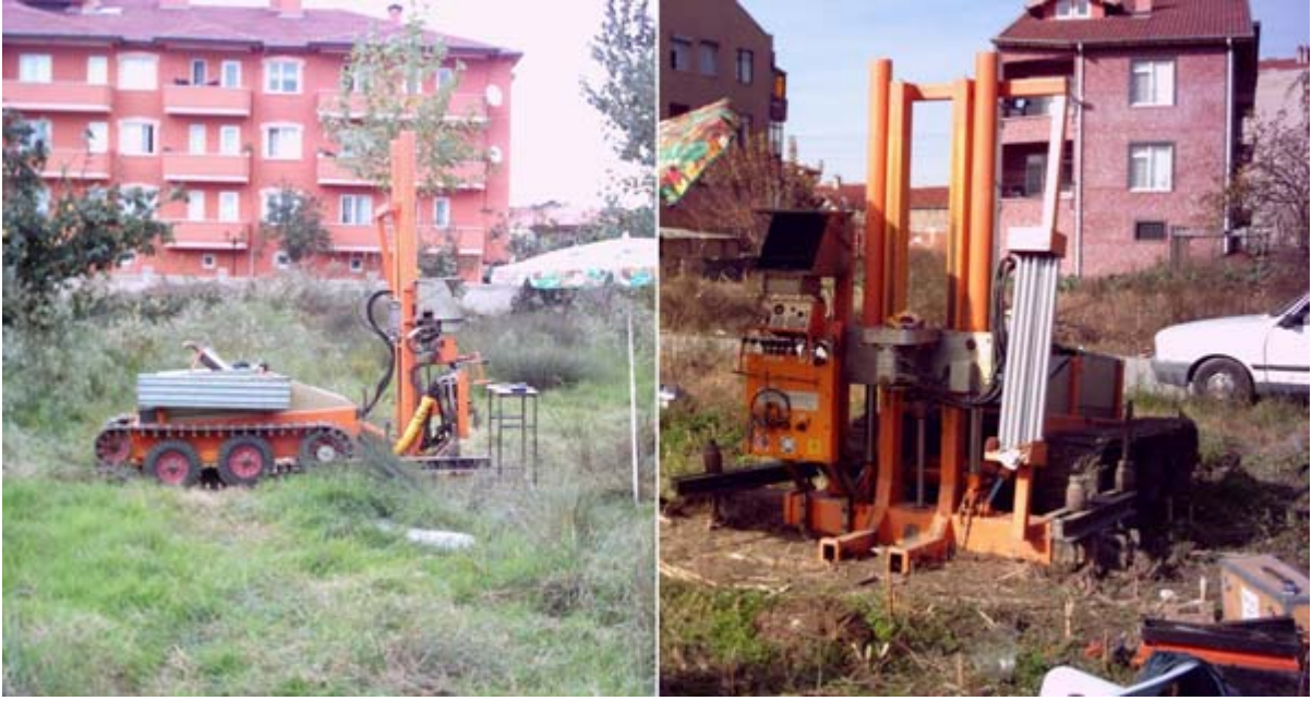
Foto 13. Koni penetrasyon deneyinin a) CTYG01 ve b) CTYG04 sitelerinde uygulanması
