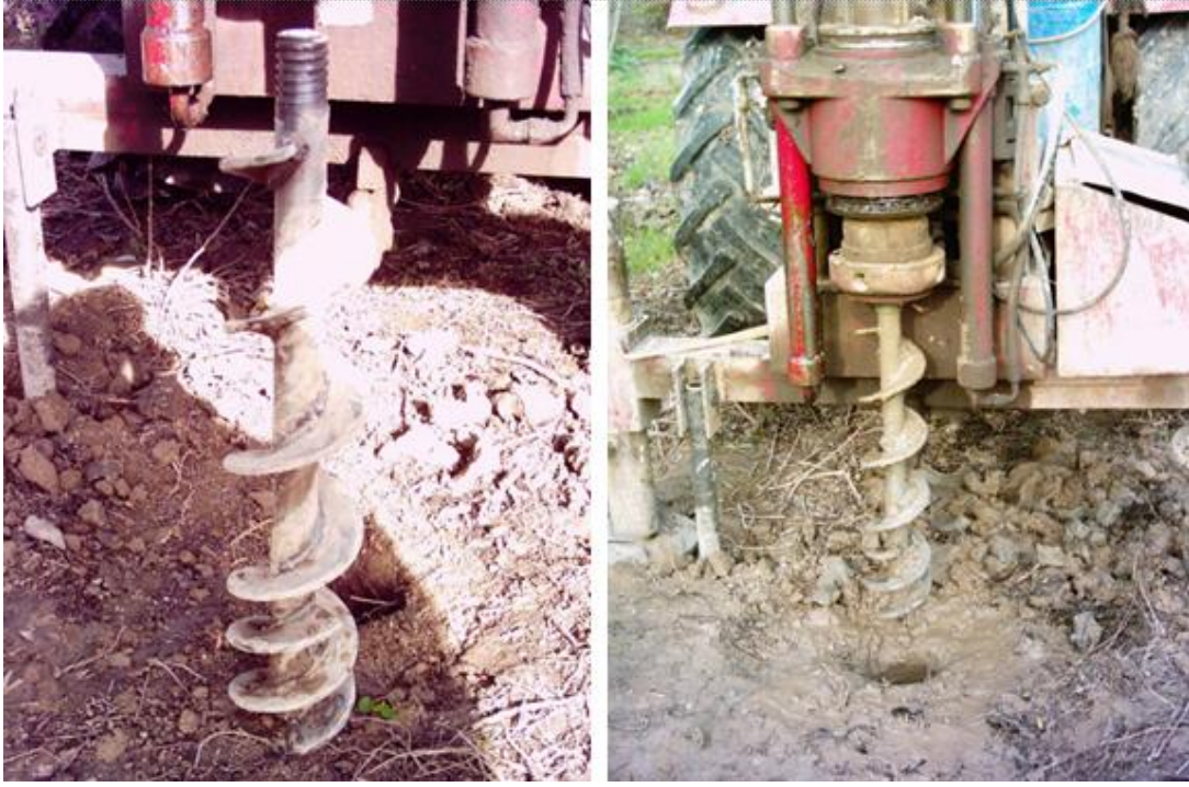
Foto 2. Susuz sondajda kullanılan helezon sistemi a) yakından görünüm, b) uygulama
