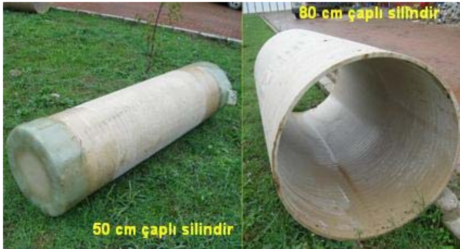
Foto 15. İki farklı çapta kalibrasyon silindirleri
