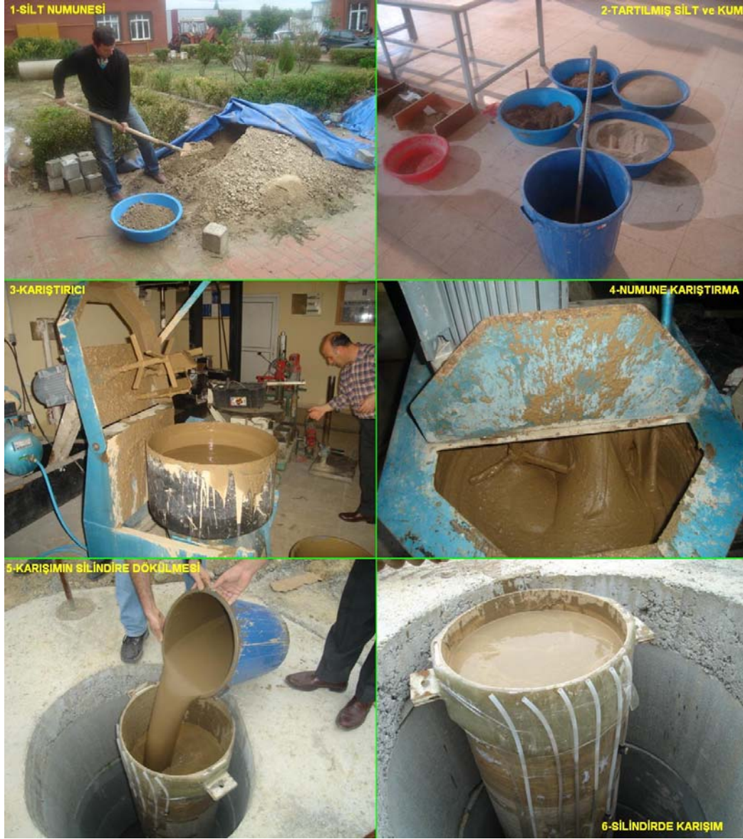
Foto 17. Karışım hazırlanması ve silindire doldurulması
