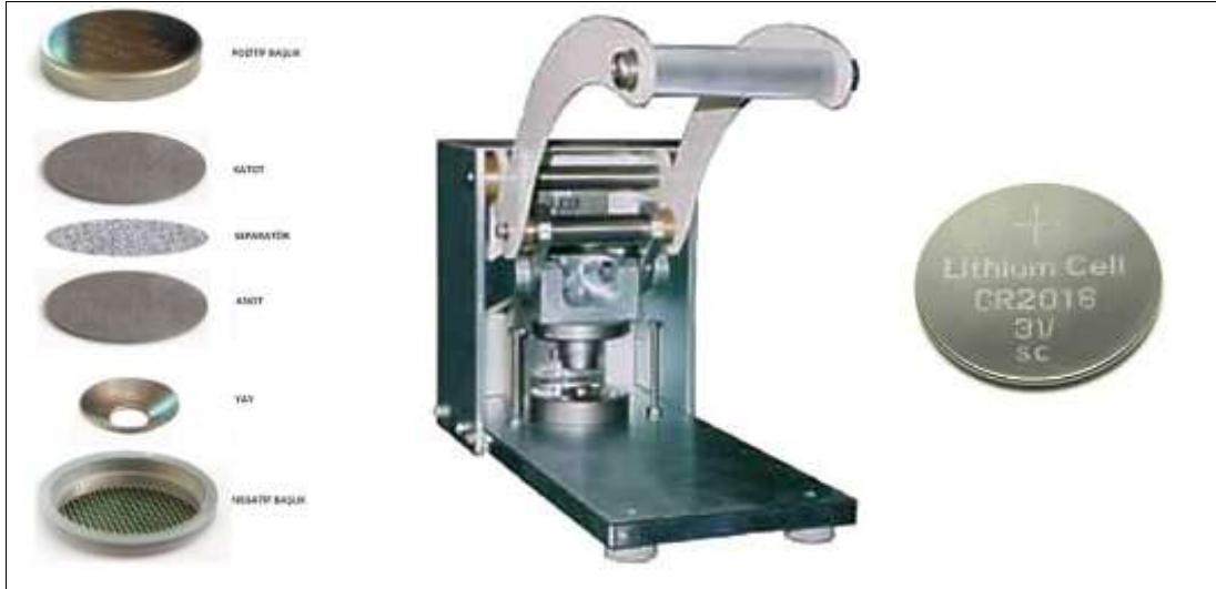
Şekil 3.222. Tipik bir CR2016 türü şarj edilebilir pil ve montajı.
