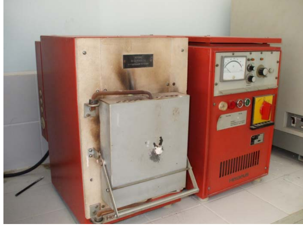
Şekil 3.3. Bazalt tozlarının ergitilmesinde kullanılan fırın
