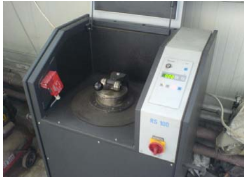
Şekil 3.2. Bazaltların öğütülmesinde kullanılan halkalı değirmen
