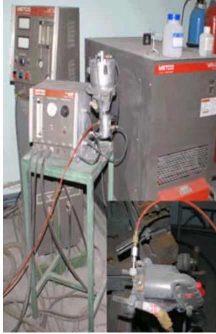
Şekil 3.6. METCO 3M Metco Perkin Elmer, 3MB II atmosferik plazma sprej kaplama ünitesi (SAÜ)
