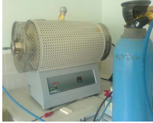
Şekil 3.8. Isıl işlemlerde kullanılan Protherm tüp fırını
