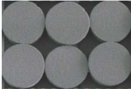
Şekil 3.7. Plazma sprej kaplama işlemiyle elde edilen numuneler
