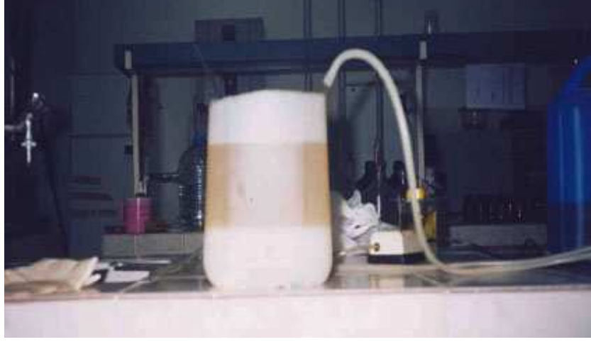
Şekil 3.7. İlk yıkama sonrası ester tabakası ve beyaz renk almış su tabakasının görünümü
