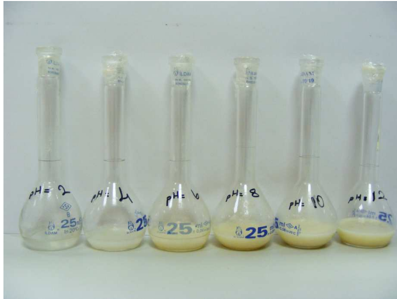
Şekil 4.4. Değişik pH larda hegzan ile ekstrakte edilen biyodizel atıksuyu
