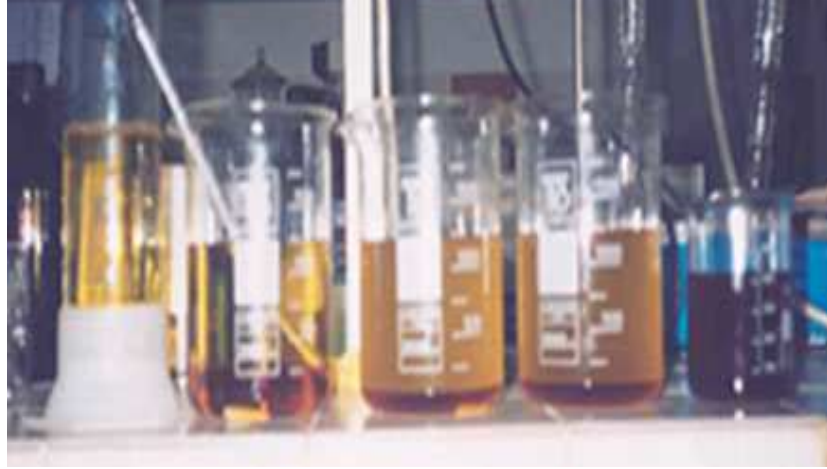
Şekil 3.6. Üretilen esterler ve gliserin tabakasının çökelti olarak oluşumu.
