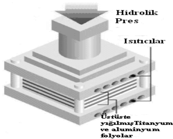
Şekil 1. MİL kompozit üretimi için deney düzeneği.
