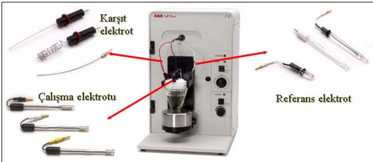
Şekil 2.2. Kapalı üç elektrotlu bölünmemiş hücre, hücre standı ve elektrotlar
