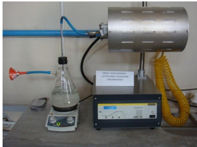
Şekil 3.10. Su buharı deneylerini yapıldığı test düzenegi
