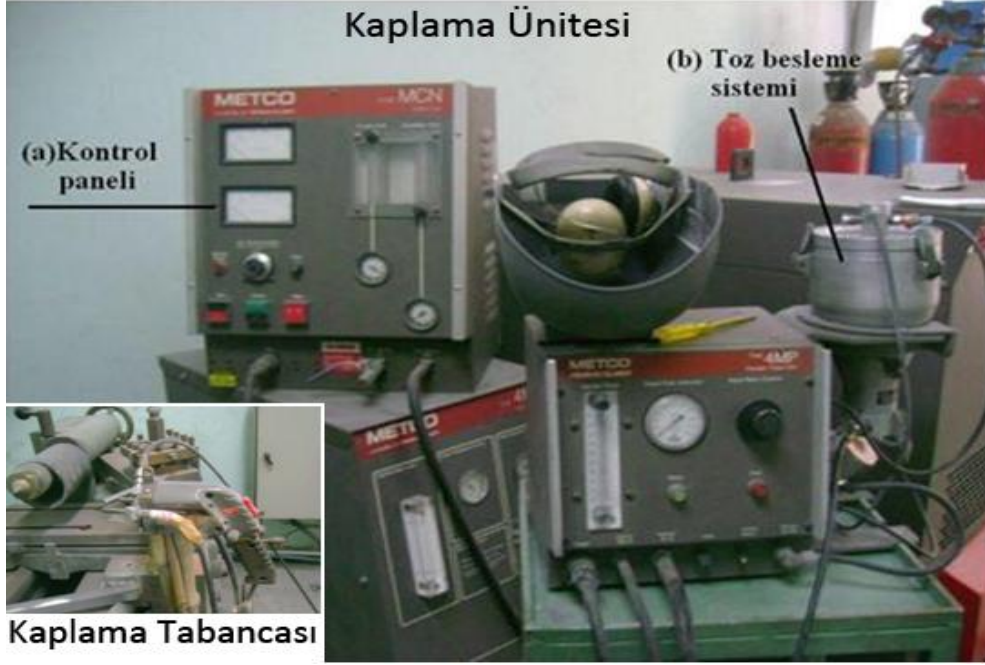
Şekil 3.6. Kaplamaların üretiminde kullanılan manuel kaplama sistemi (tabanca 3MB)
