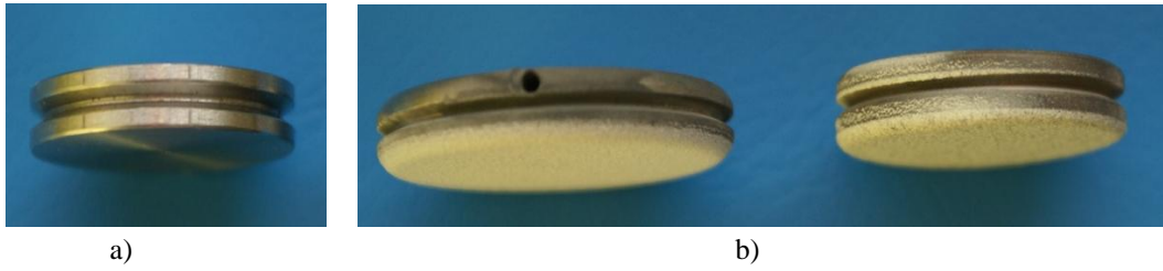
Şekil 3.2. Termal şok testine uygun özel bir şekilde hazırlanmış a) Paslanmaz çelik ve b) ZrO_2-Y_2O_3 kaplanmış özel termal çevrim numuneleri
