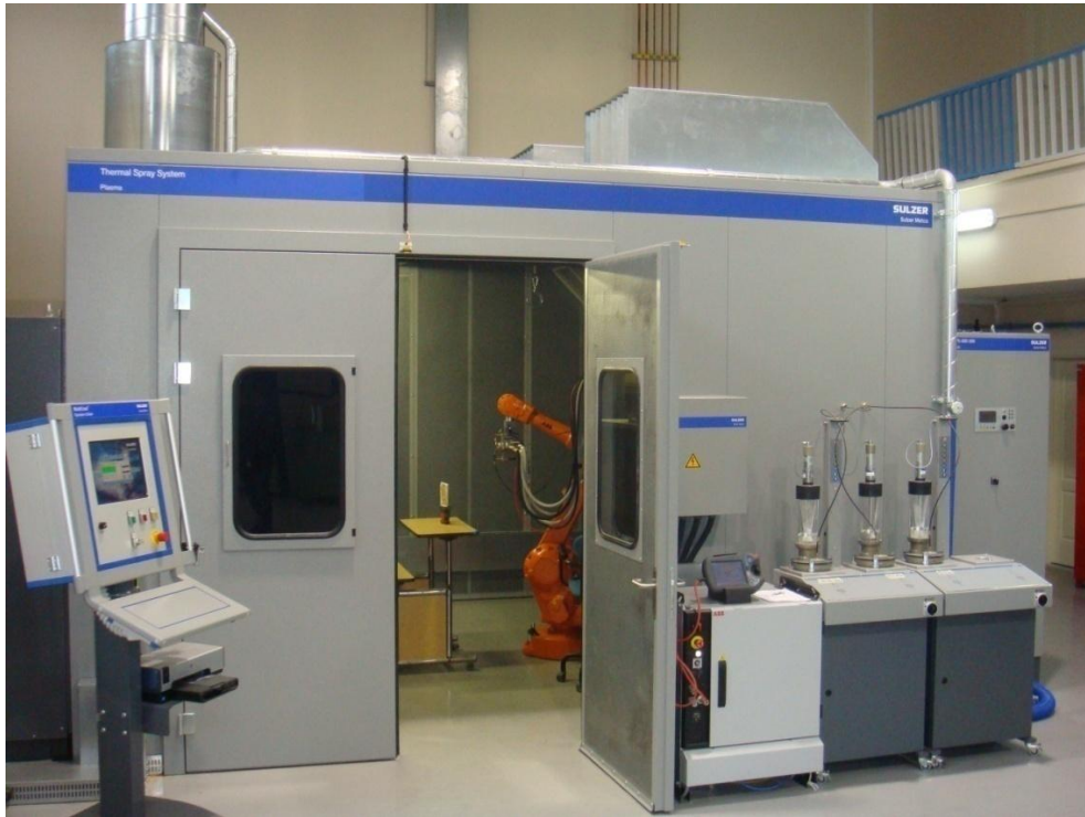
Şekil 3.5. Multicoat kaplama sistemi (F4 tabancalı, robotik ünite)
