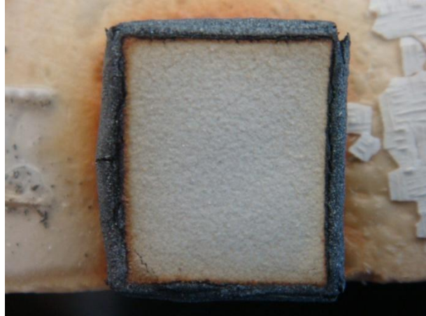
Şekil 4.52. Mullit kaplamasının 5 saat sonrası su buharı testi sonrası makro görüntüsü
