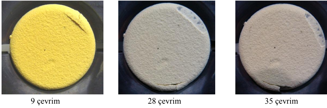
Şekil 4.13. Kalın kaplanmış (727 \mu m), CSZ numunenin brülör testi sonrası yüzey görüntüleri
