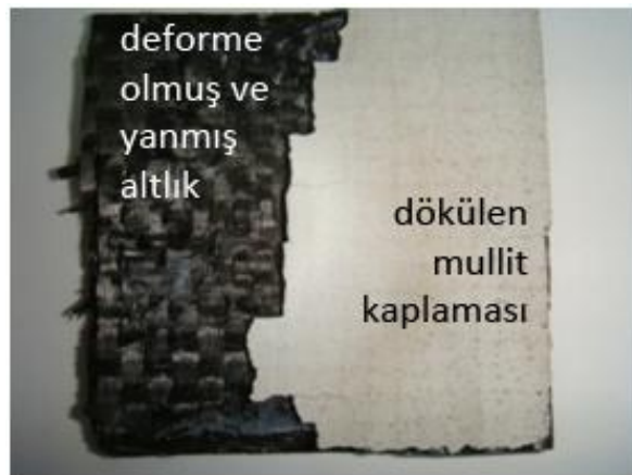
Şekil 4.40. Mullit kaplamanının 45 çevrim sonrası görüntüsü (F4)
