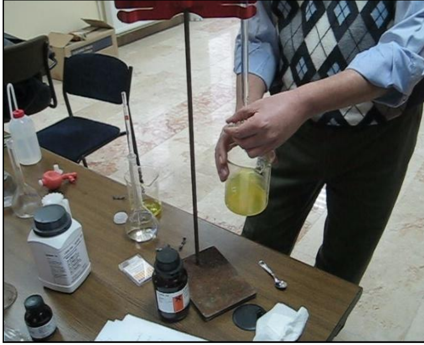
Şekil 3. 25. Yaş analiz yöntemi düzeneği ve ekipmanları
