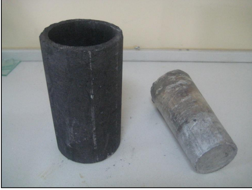
Şekil 3. 16. Doğrudan döküm yönteminde kullanılan grafit pota ve döküm sonrası üretilmiş AlB_2 kompoziti
