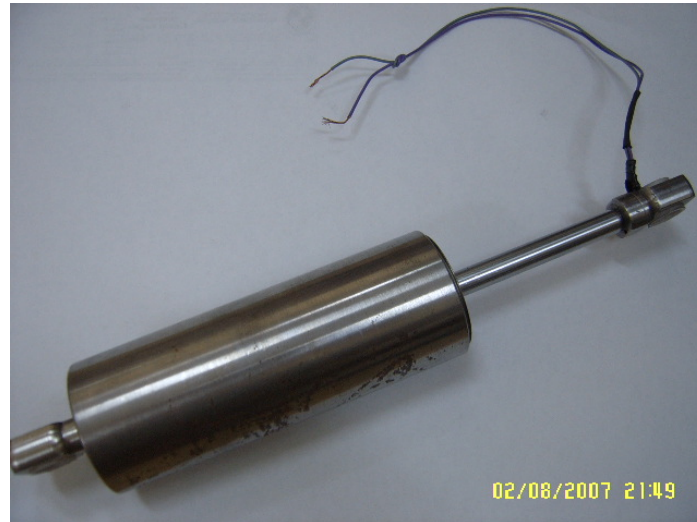
Şekil 7. 5. İmal edilen SAUMRD002'nin montajlanmış hali
