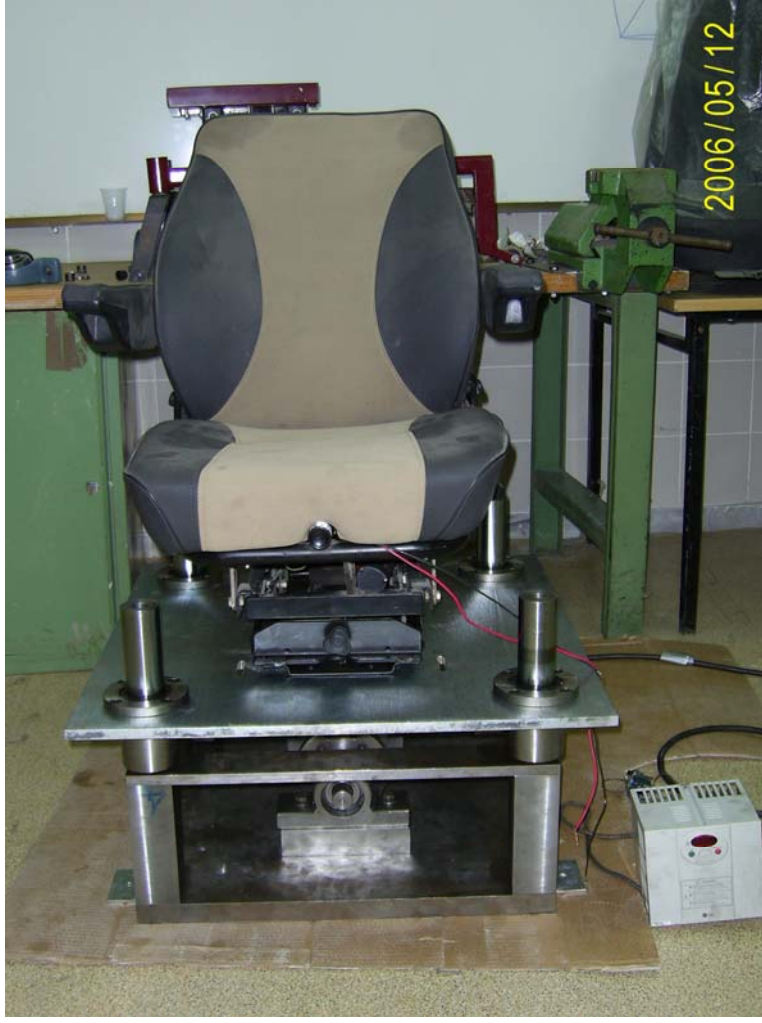
Şekil 7.10E. İmalatı yaptırılan damper alıştırma ve titreşim tablasının fotoğrafı
