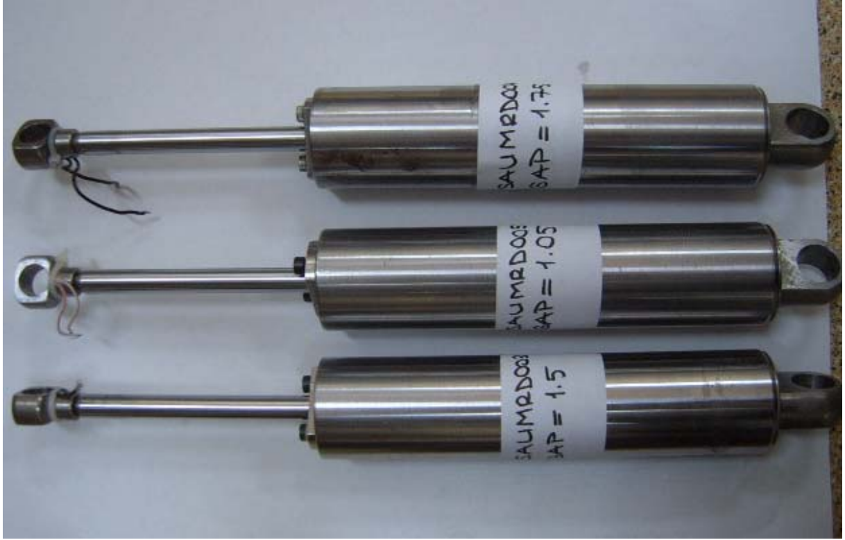
Şekil 7.6. Farklı akış kanalı yüksekliklerine göre imal edilen SAUMRD003'ün montajlanmış hali
