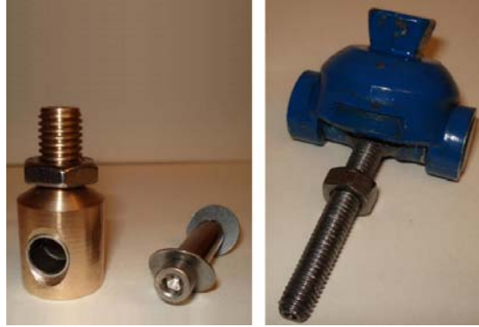
Şekil: 2.1E. Topuk ve bilek eklemi mafsalları.
