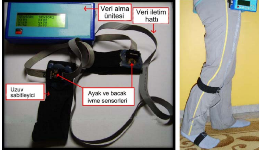
Şekil: 7. 8. Ayak ve bacak konum verisini almak için oluşturulan düzenek.
