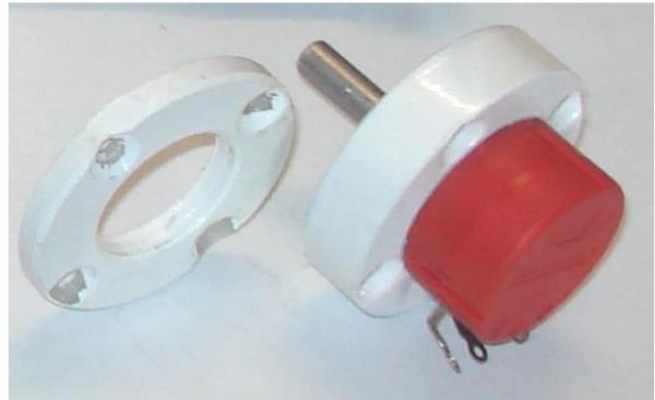
Şekil: 3. 5E. Rulman kapakları ve diz eklemi potansiyometresi tutucusu.
