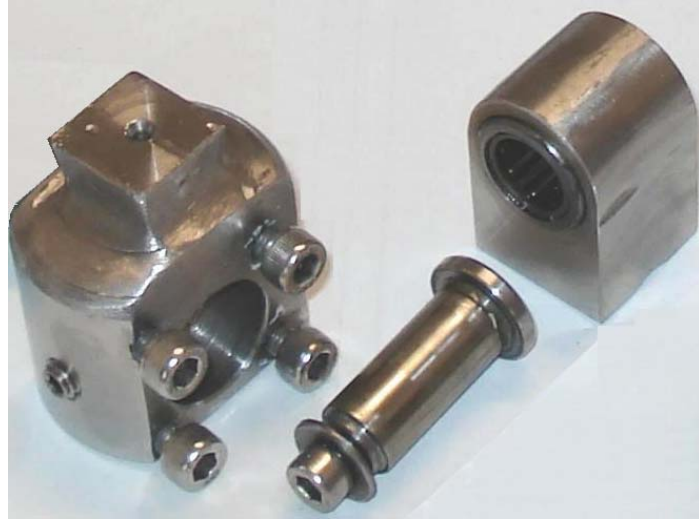
Şekil: 3. 3E. Eklem ve ara mafsals elemanları.
