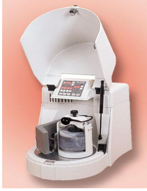
Şekil 3.1. Mekanik aktivasyonda kullanılan gezegensel değirmen
