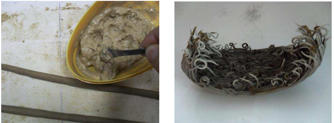
Resim 34 - 35: Kâğıt katkıli seramik çamuru ve fitil yöntemi ile şekillendirme aşamaları
