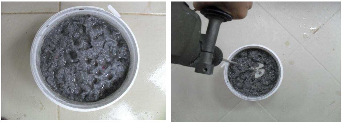
Resim 14 - 15: Parçalanmış gazete kâğıtlarının sıcak su ile ıslatılıp matkapla karıştırılması
