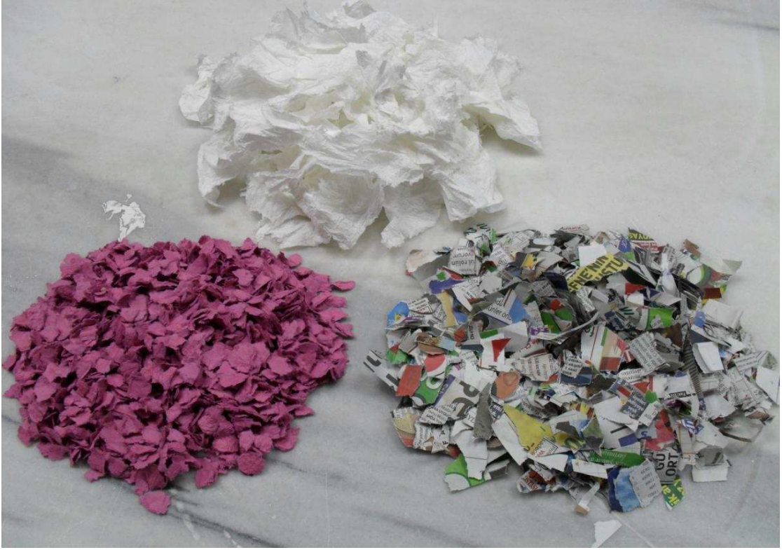
Resim 8: Parçalanmış gazete kâğıdı, peçete ve yumurta kartonu
