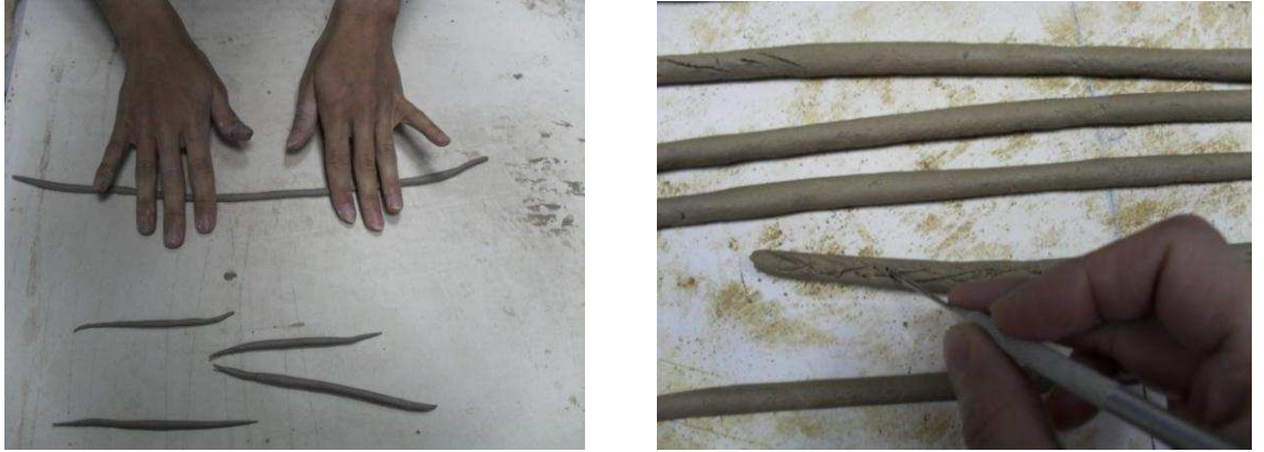
Resim 34 - 35: Kâğıt katkıli seramik çamuru ve fitil yöntemi ile şekillendirme aşamaları
