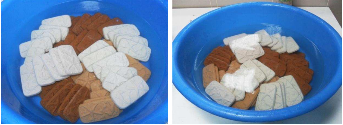
Resim 25 - 26: Kâğıt katkılı seramik bünyelerin su emme deneyi için 12 saat su içerisinde bekletilmesi
