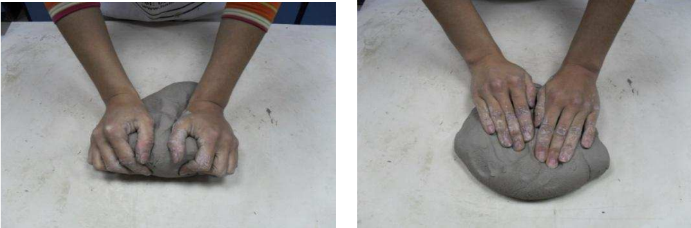
Resim 23 - 24: Kâğıt katkılı seramik çamurunun alçı plaka üzerinde bekletildikten sonra yoğrulması
