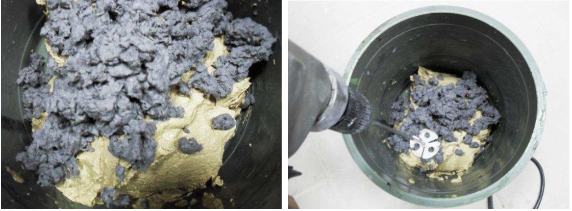
Resim 19 - 20: Gazete kâğıtları ve şamot çamurunun karıştırılması
