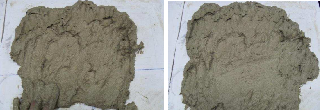
Resim 21 - 22: Gazete kâğıtları ve şamotlu çamurun karıştırıldıktan sonra alçı plaka üzerine yayılması
