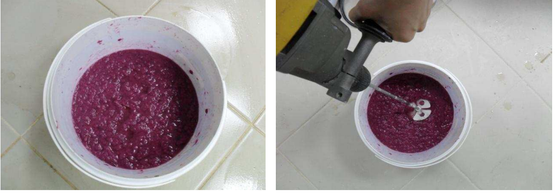
Resim 16 - 17: Parçalanmış yumurta kartonlarının sıcak su ile ıslatılıp matkapla karıştırılması
