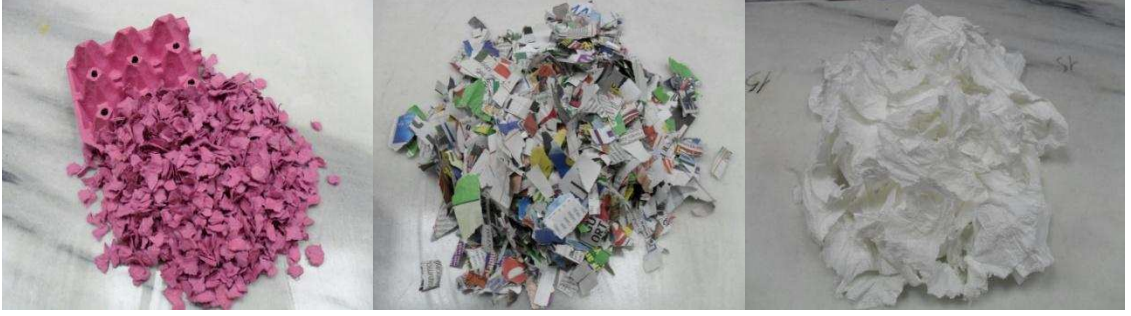
Resim 7: Parçalanmış gazete kâğıdı, peçete ve yumurta kartonu
