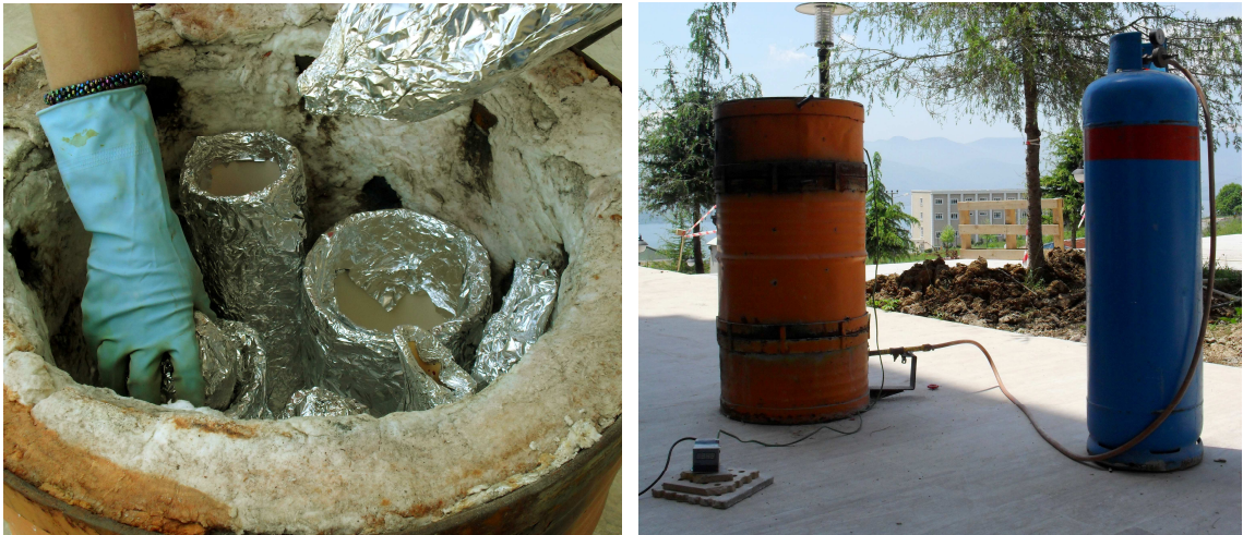
Resim 14 - 15: Alüminyum folyo ile paketlenen seramik parçaların gazlı fırına yerleştirilmesi
