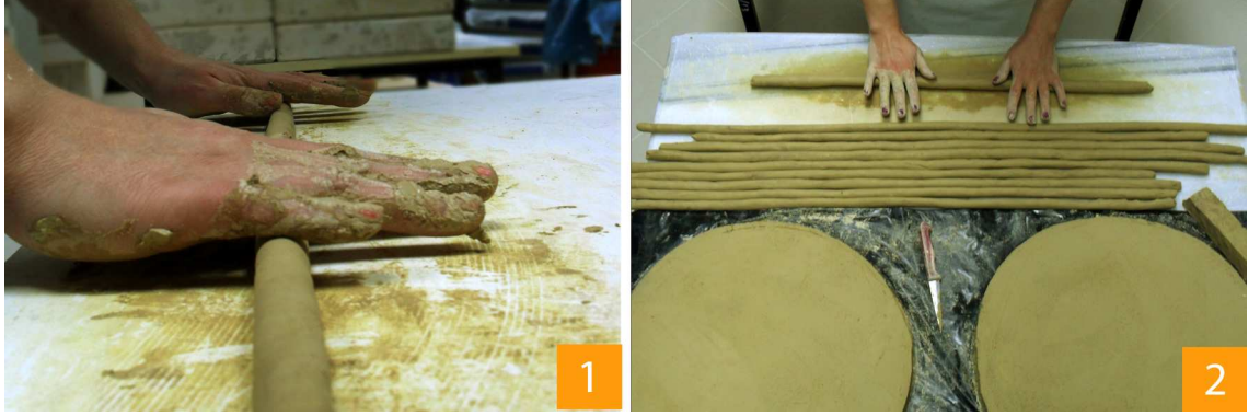
Resim 47: Fitil tekniği ile toprak sığar kutusu üretimi (1, 2. Aşama)
