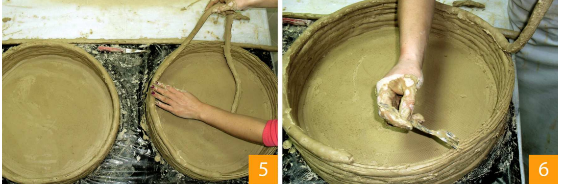
Resim 49: Fitil tekniği ile toprak sagar kutusu üretimi (5, 6. Aşama)
