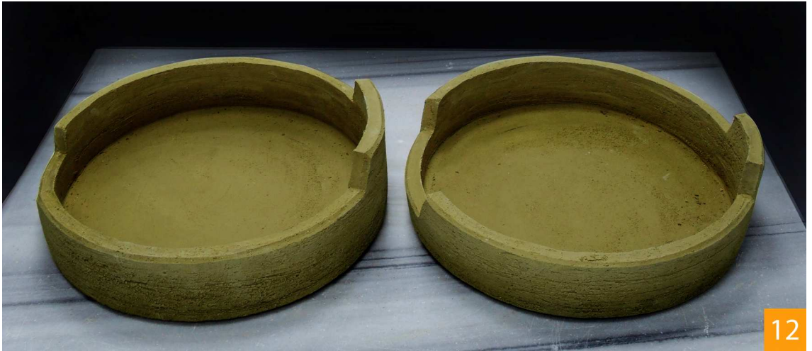
Resim 53: Fitol tekniđi ile toprak sagar kutusu üretimi
