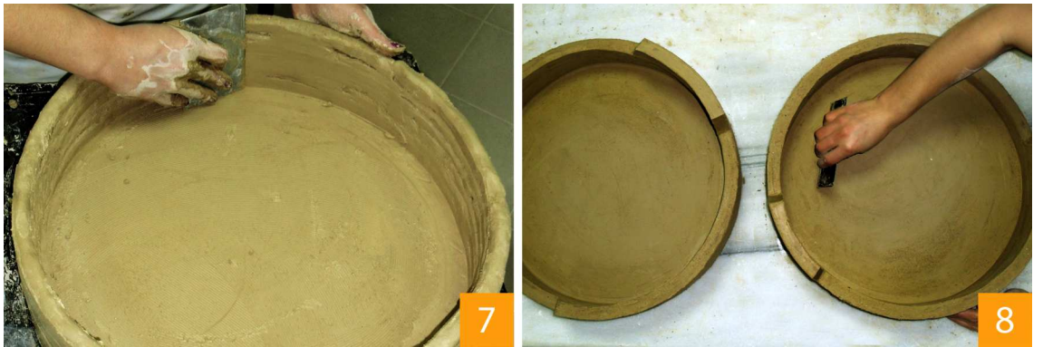
Resim 50: Fitil tekniği ile toprak sagar kutusu üretimi (7, 8. Aşama)
