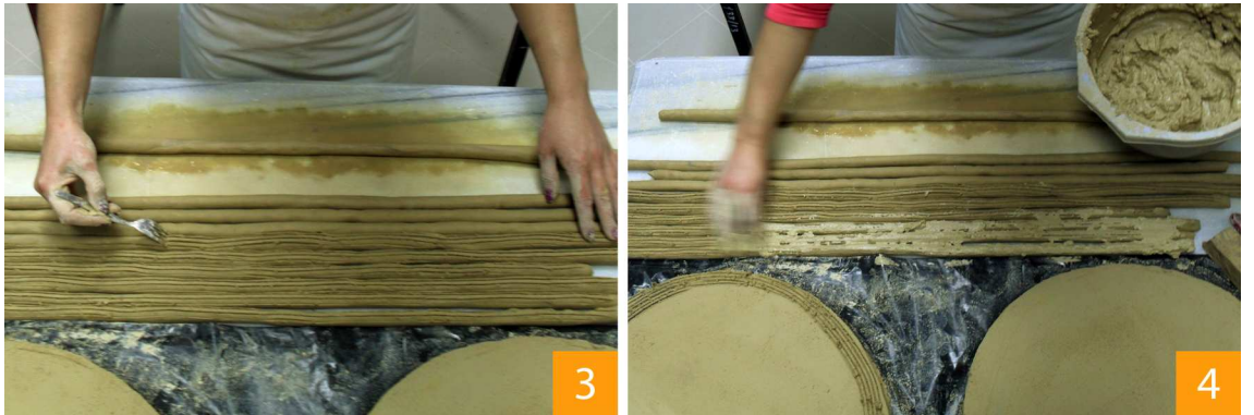
Resim 48: Fitil tekniği ile toprak sığar kutusu üretimi (3, 4. Aşama)
