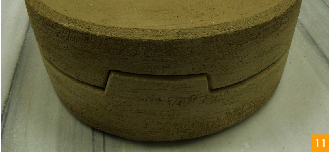
Resim 53: Fitol tekniđi ile toprak sagar kutusu üretimi
