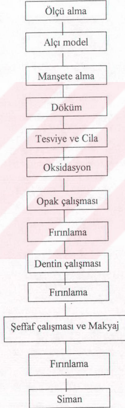
Şekil 7. 10 Porselen diş yapımı akım şeması
