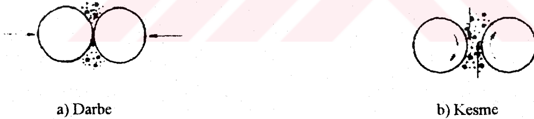
Şekil 4.5. Atritör değirmeninde öğütme sırasında oluşan hareketler
