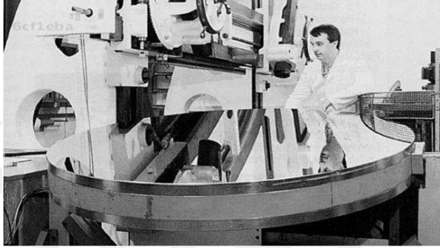
Şekil 2.1. Yüksek saflıktaki alüminyumun teleskop aynası olarak kullanımı [16]
