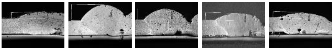
Şekil 6.16. 20-25 numaralı deeyler MIG lehimleme makro görüntüler
