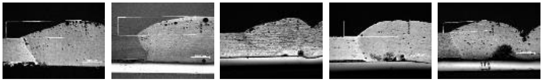
Şekil 6.15. 16-20 numaralı deeyler MIG lehimleme makro görüntüler
