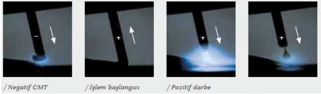
Şekil 4.11. Negatif CMT ve darbe döngülerinden oluşan kombinasyon [46].
