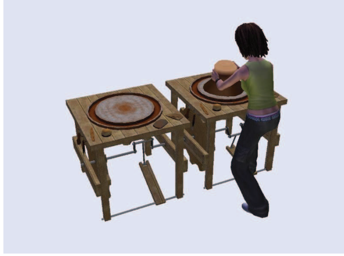
Resim 15: Pedalla Döndürülebilen Çömlekçi Tornası
