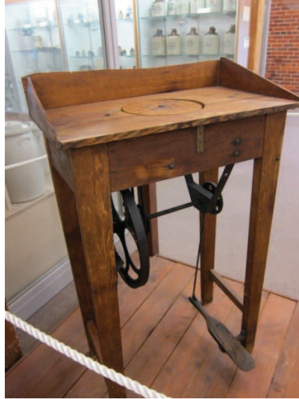
Resim 16: Pedalla Döndürülebilen Çömlekçi Tornası
