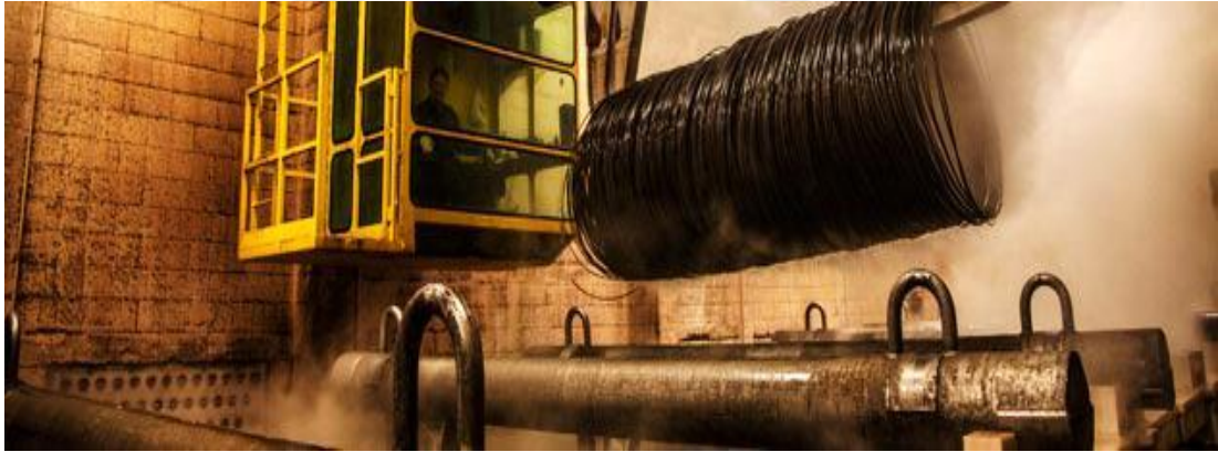
Şekil 3.1. Tel çubukların asitleme işleminin yapılması [11]
