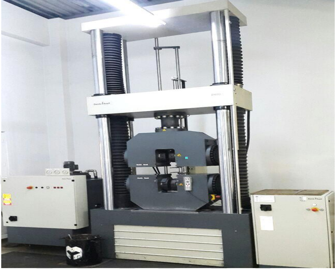
Şekil 5.2. Zwick Roell çekme test makinası
