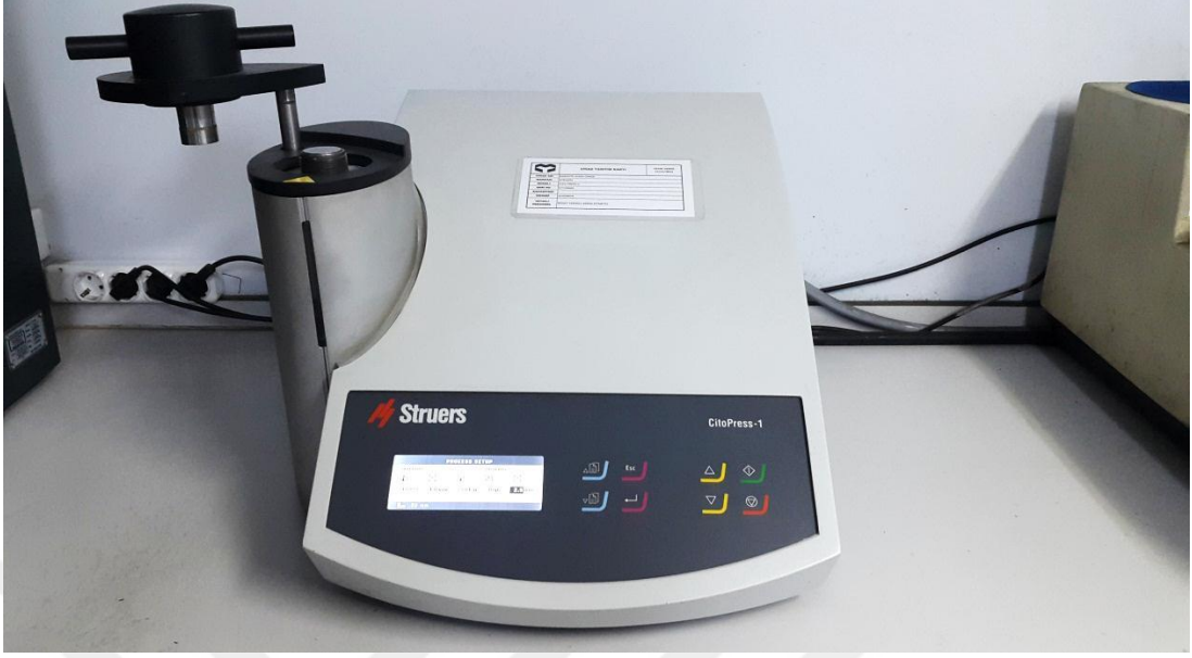
Şekil 5.3. STRUERS CITO PRESS-1 bakalite alma cihazı
