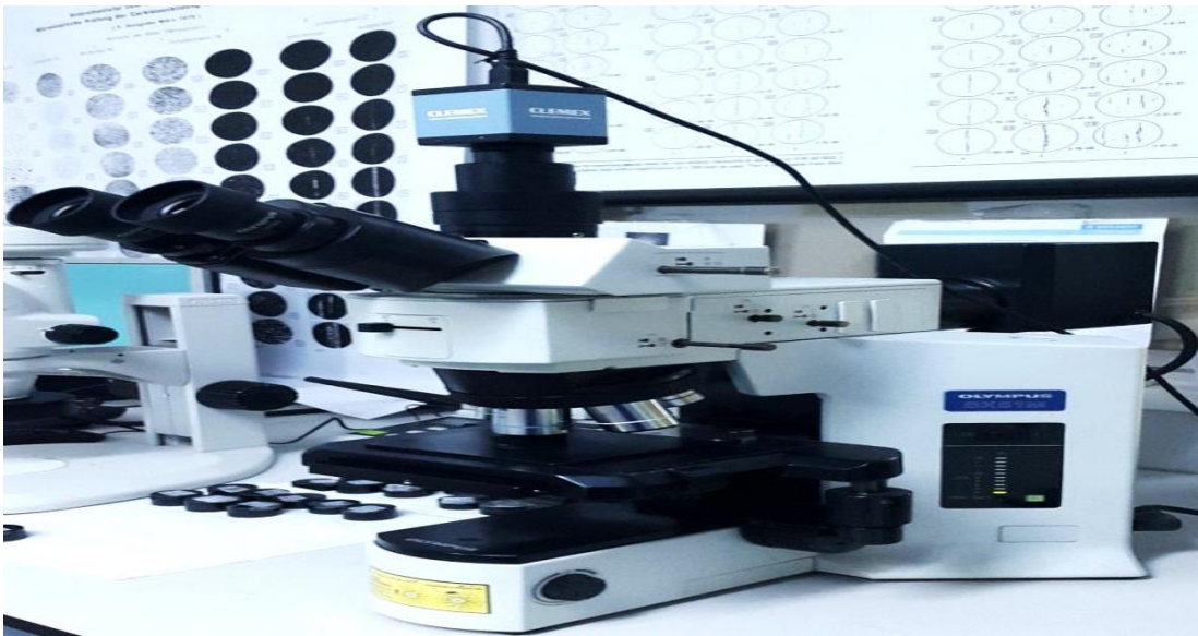
Şekil 5.6. OLYMPUS BX51M optik mikroskop
