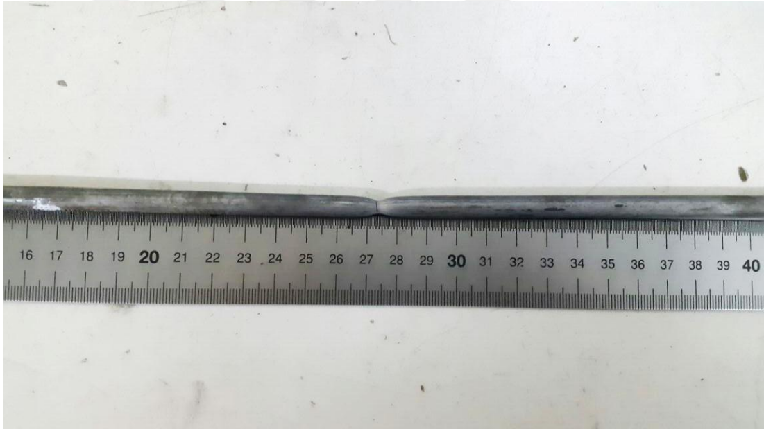
Şekil 6.1. Çekme testi yapılmış örnek numune
