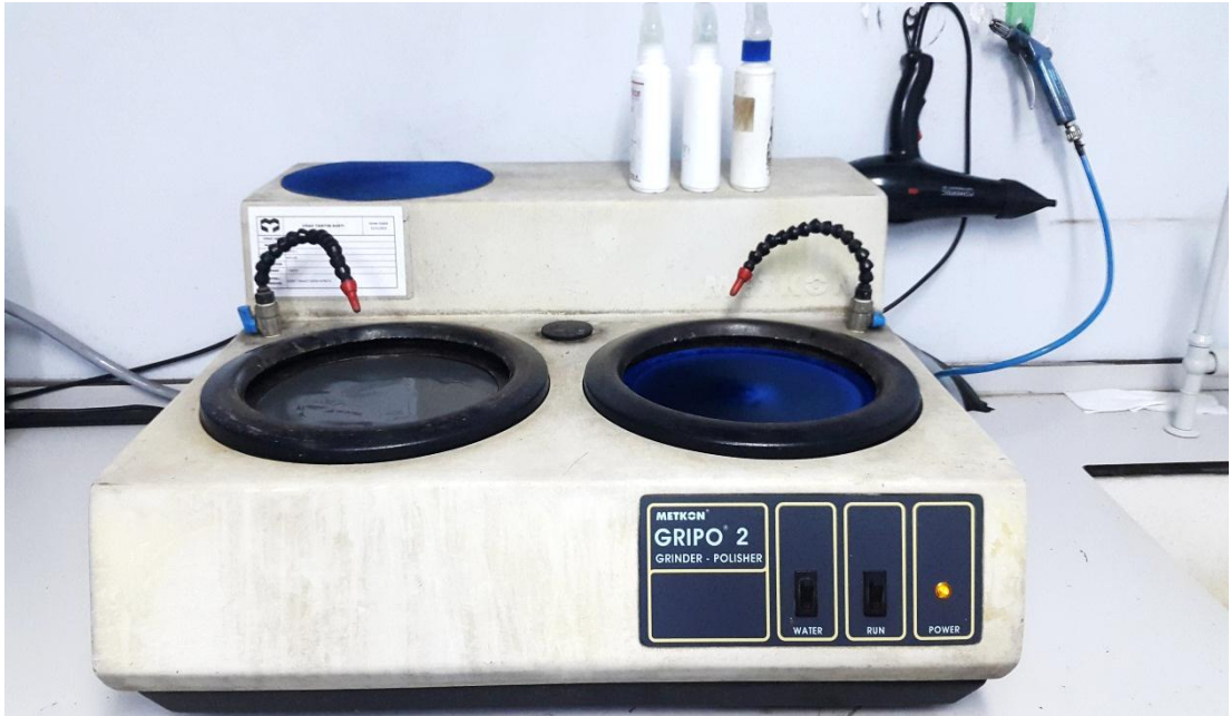
Şekil 5.4. METKON GRIPO-2 parlatma cihazı
