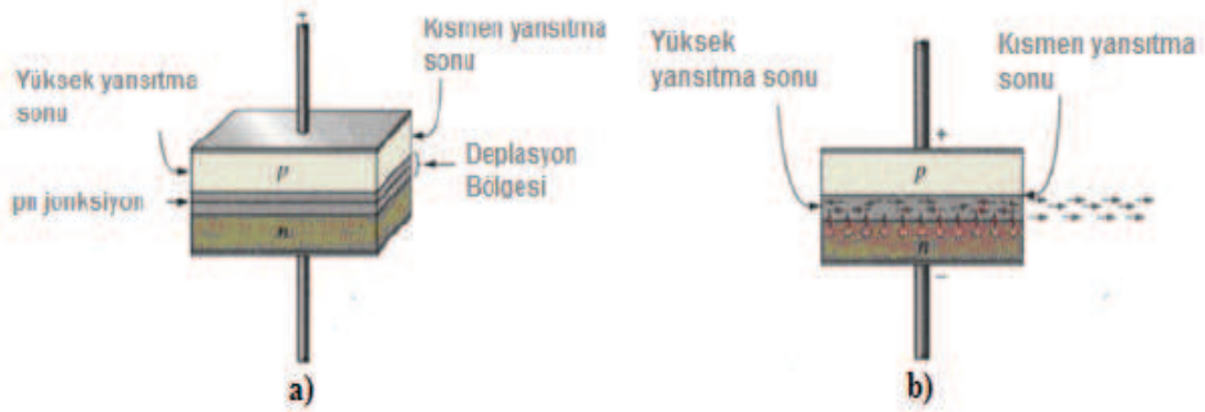
Şekil 2.4. Yarı iletken lazer; a) Yarı iletken lazer görünümü, b) Lazer oluşumu [11]
