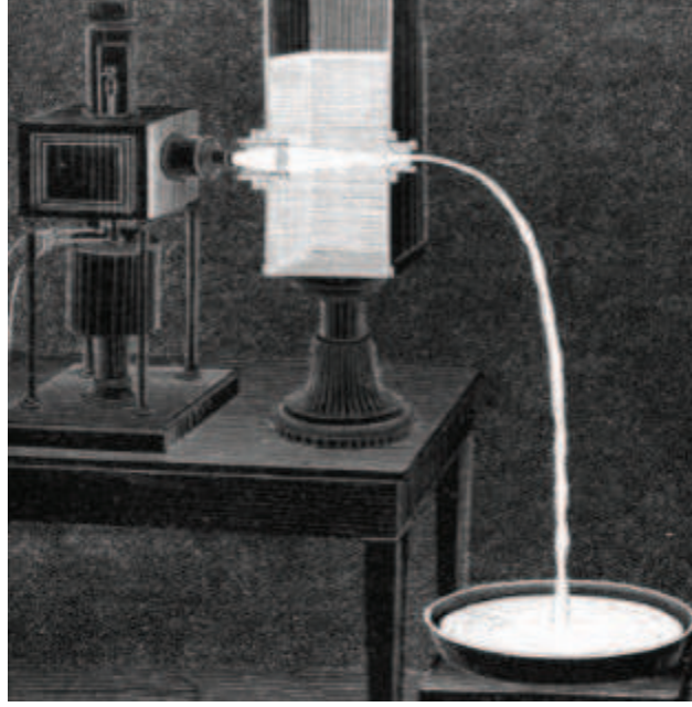
Şekil 4.1. Daniel Colladon'un akışkan ışık tüpü [41]
